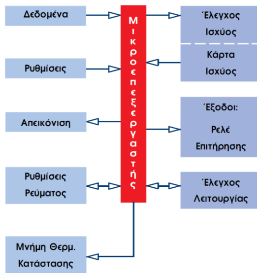
Σχ 2.14 : Ηλεκτρονικός εκκινητής α) Συνδεσμολογία θυρίστωρ, β) Τάση τροφοδότησης κινητήρα και γ) Λειτουργίες μικροεπεξεργαστή
