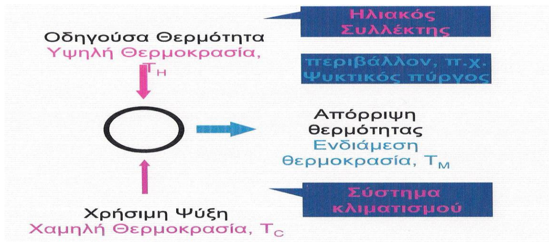
ΣΧΗΜΑ 5: Θερμοκρασιακά επίπεδα θερμοκίνητων ψυκτών
