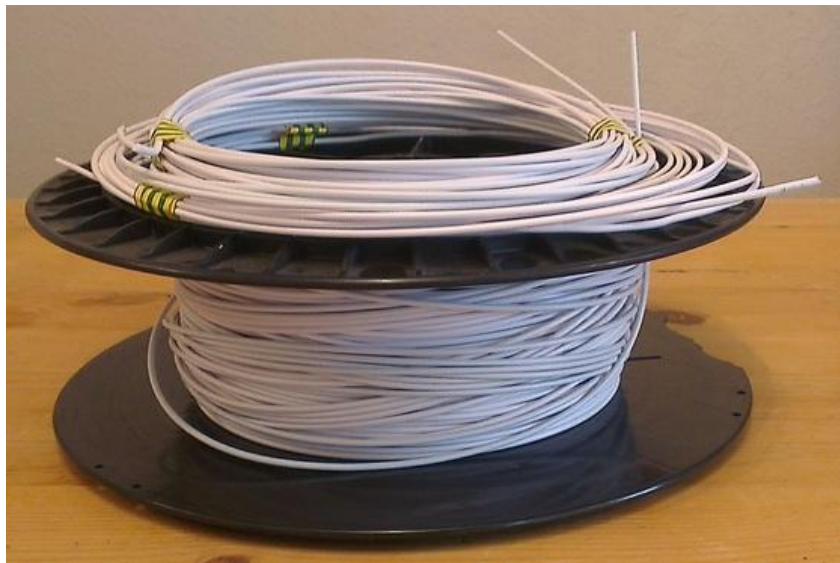
Εικόνα 14: Πλαστικό ABS 1,75mm με την μορφή νήματος
