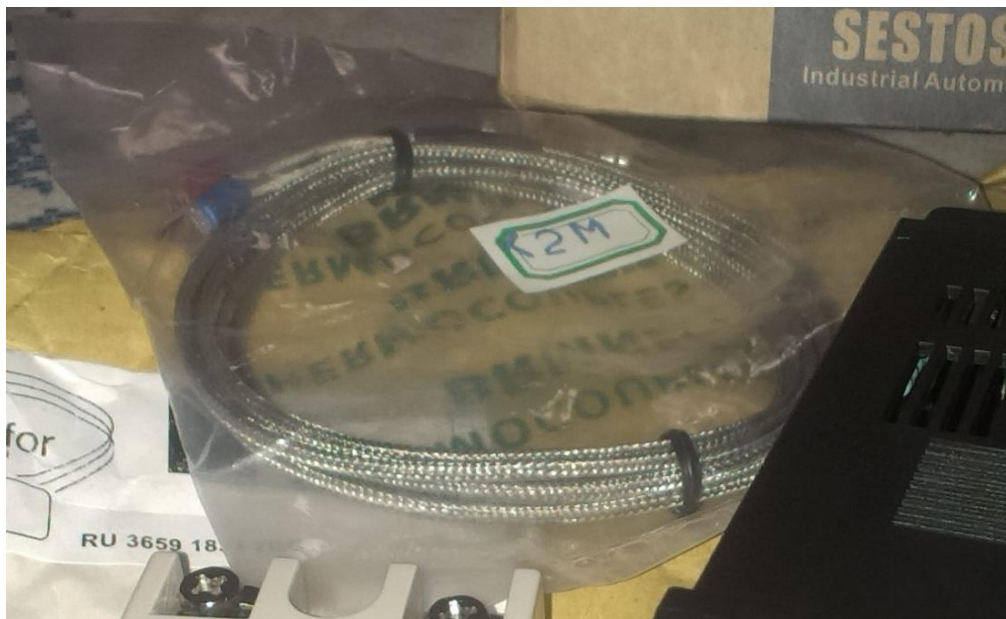
Εικόνα 41: Το θερμοζεύγος τύπου K που χρησιμοποιήθηκε
