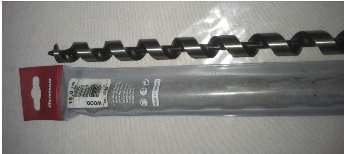
Εικόνα 62: Το τρυπάνι ξύλου που χρησιμοποιήθηκε σαν κοχλίας μεταφοράς
