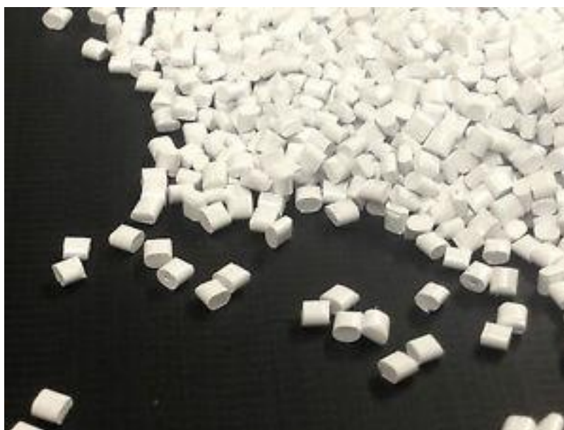
Εικόνα 13: ABS πλαστικό σε μορφή pellet
