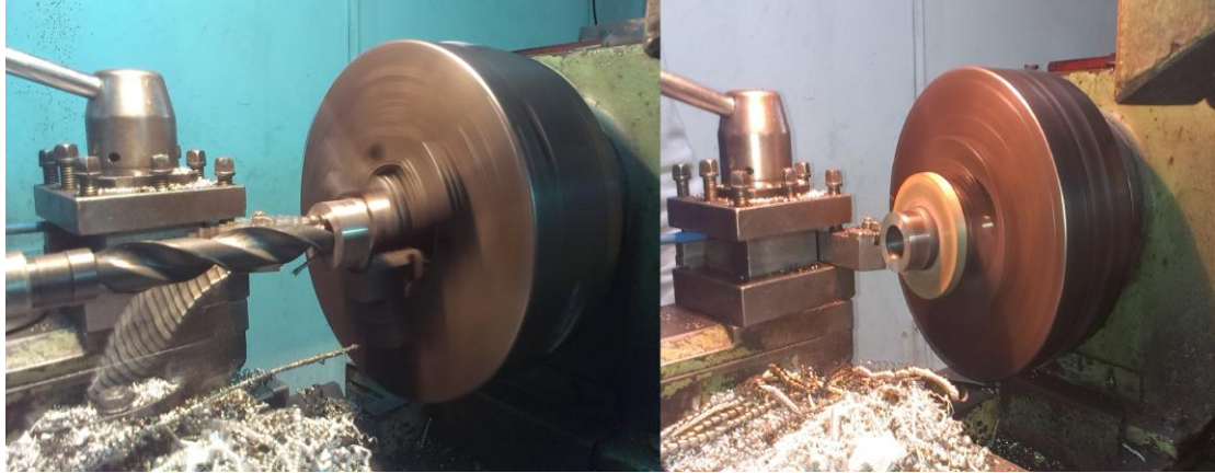
Εικόνα 60: Στιγμιότυπα από το άνοιγμα οπής 32mm για την τοποθέτηση του εδράνου κύλισης
