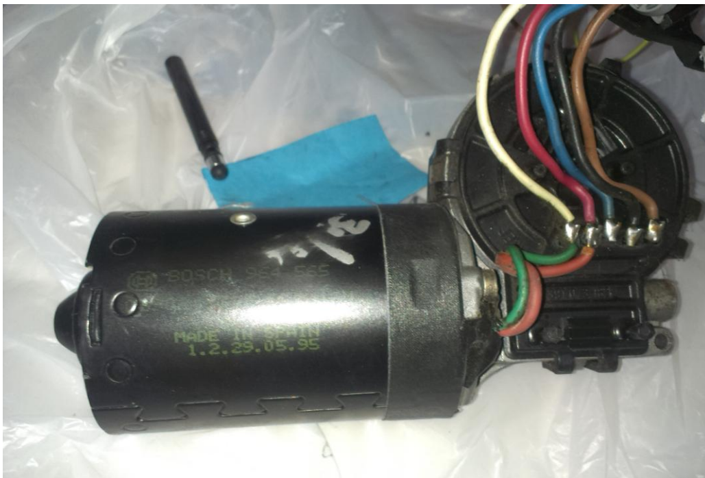
Εικόνα 36: Το μοτέρ υαλοκαθαριστήρων που χρησιμοποιήθηκε
