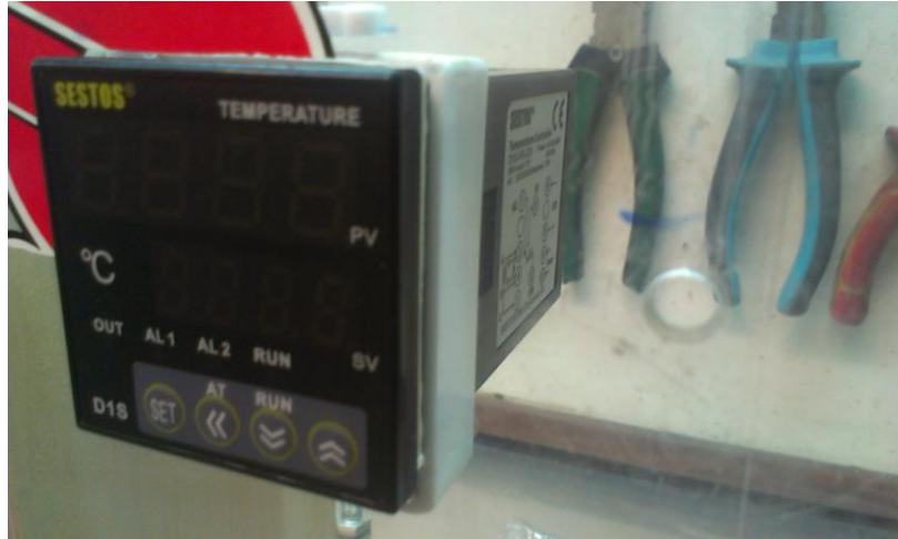
Εικόνα 39: Ο ελεγκτής θερμοκρασίας τοποθετημένος
