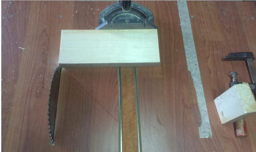
Εικόνα 26: Κοπή τεμαχίων για το κάθετο τμήμα της βάσης
