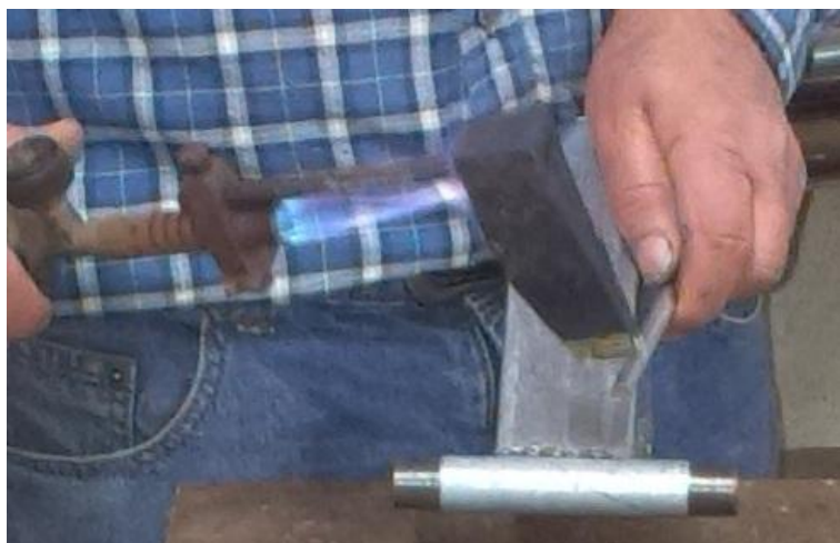
Εικόνα 57: Στιγμιότυπο κατά την διαδικασία κασιτεροκόλλησης χωνιού/σωληνομαστού
