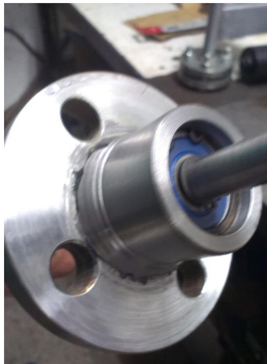
Εικόνα 61: Το έδρανο κύλισης και οι ασφάλειες τοποθετημένα
