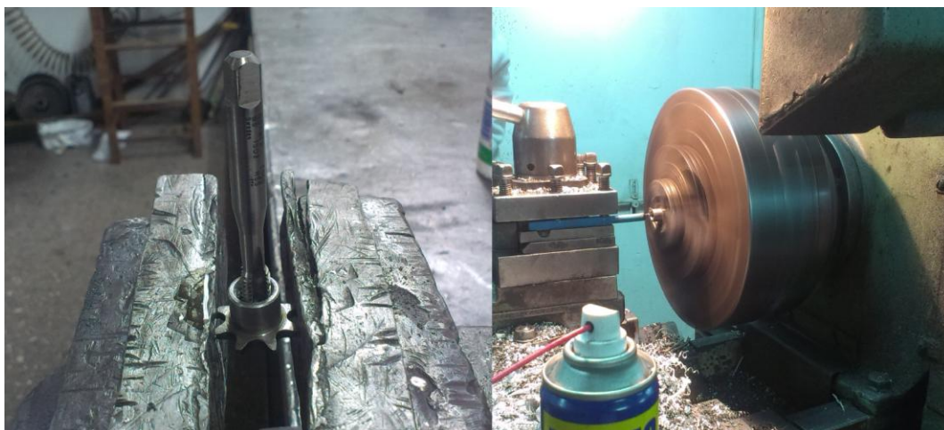
Εικόνα 69: Διαδικασία σπειροτόμησης και τόνρευσης αλυσοτροχού Z1
