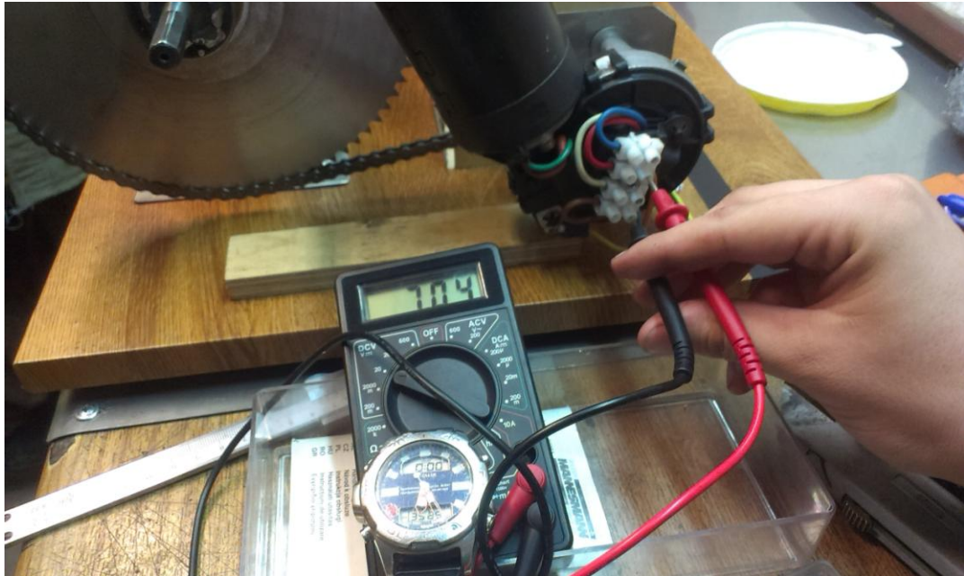
Εικόνα 79: Μέτρηση στροφών κοχλία για τάση λειτουργίας ηλεκτροκινητήρα 2,4,6,8,10,12 Volt
