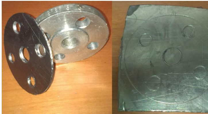
Εικόνα 54: Η χαλύβδινη φλάντζα και η μόνωση 2mm από περμανίτη
