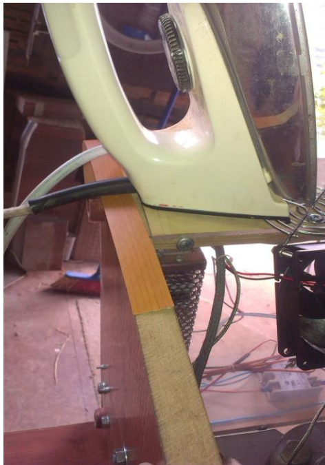
Εικόνα 30: Τοποθέτηση θερμαινόμενης ταινίας ξύλου
