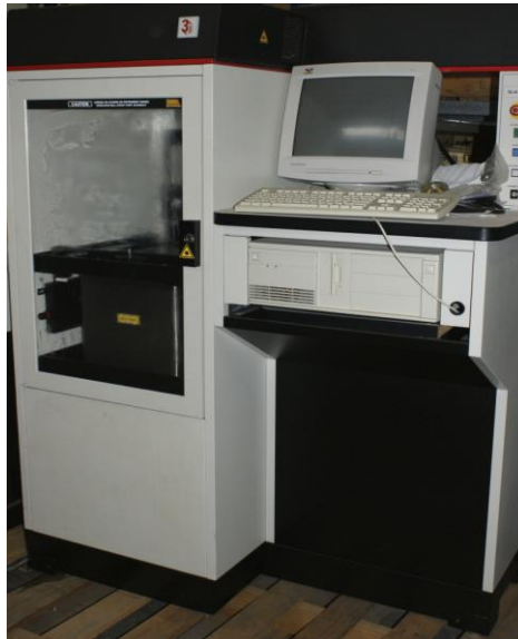
Εικόνα 3: Ο πρώτος 3D εκτυπωτής μαζικής παραγωγής της εταιρίας 3D systems.
