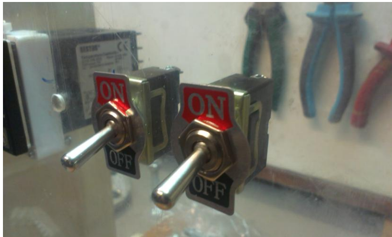
Εικόνα 47: Οι διακόπτες 2 θέσεων που χρησιμοποιήθηκαν τοποθετημένοι
