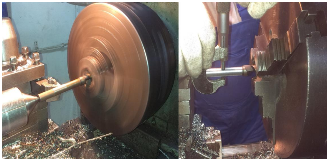
Εικόνα 63: Τόννευση και μικρομέτρηση κοχλίας
