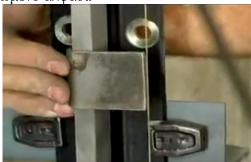
Εικόνα 4: Ευθυγράμμιση των οδηγών με τη βοήθεια μεταλλικής γωνίας.
