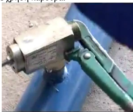
Εικόνα 6: Προσαρμογή βαλβίδας ασφαλείας στο έμβολο.
