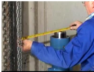
Εικόνα 9: Έλεγχος κεντραρίσματος εμβόλου.
