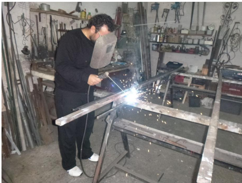
Εικ 43 : Ηλεκτροσυγκόλληση τμήματος βάσης σε μηχανουργείο
