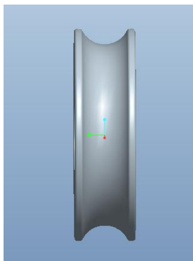
Εικ 18: Τρισδιάστατο Μοντέλο ράουλου
