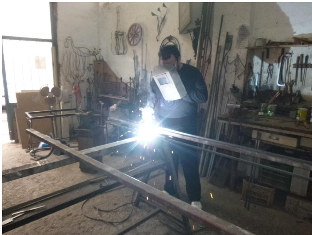
Εικ 40 : Ηλεκτροσυγκόλληση τμήματος οδηγού σε μηχανουργείο
