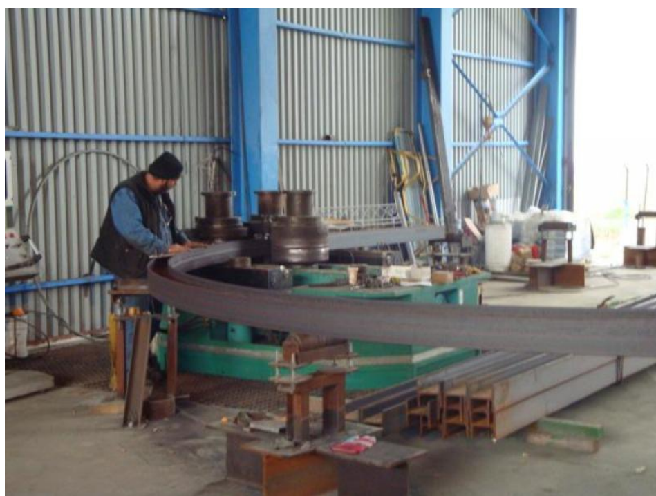
Εικ 40 : Κυκλική διαμόρφωση σίδερου με μεταλλική ραουλιέρα
