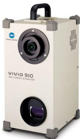
Εικ 5 : Η τρισδιάστατη κάμερα Konica Minolta Vi-910
