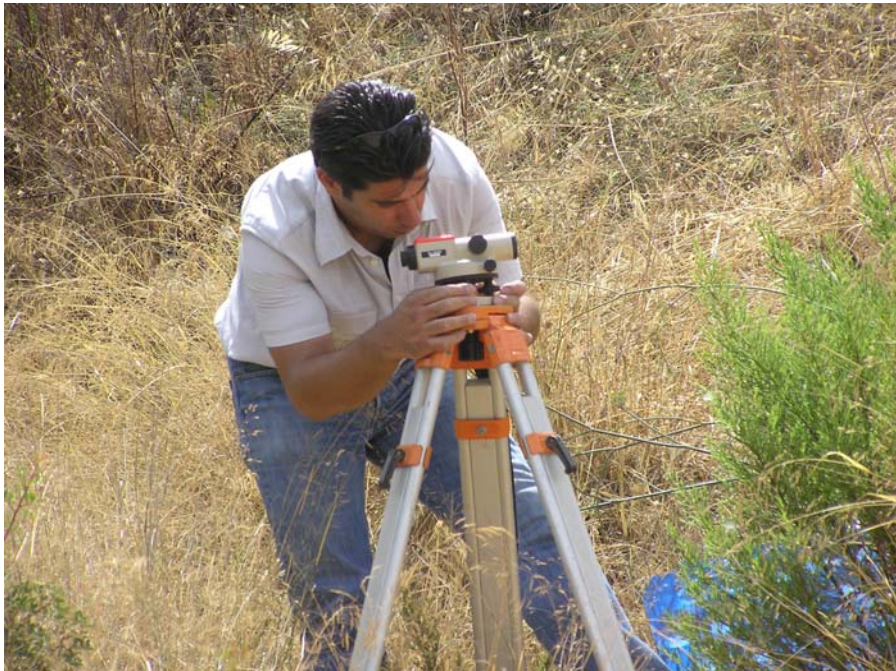
Φώτο 3.1 Χωροβάτης (όργανο λήψης υψομετρικών διαφορών)
