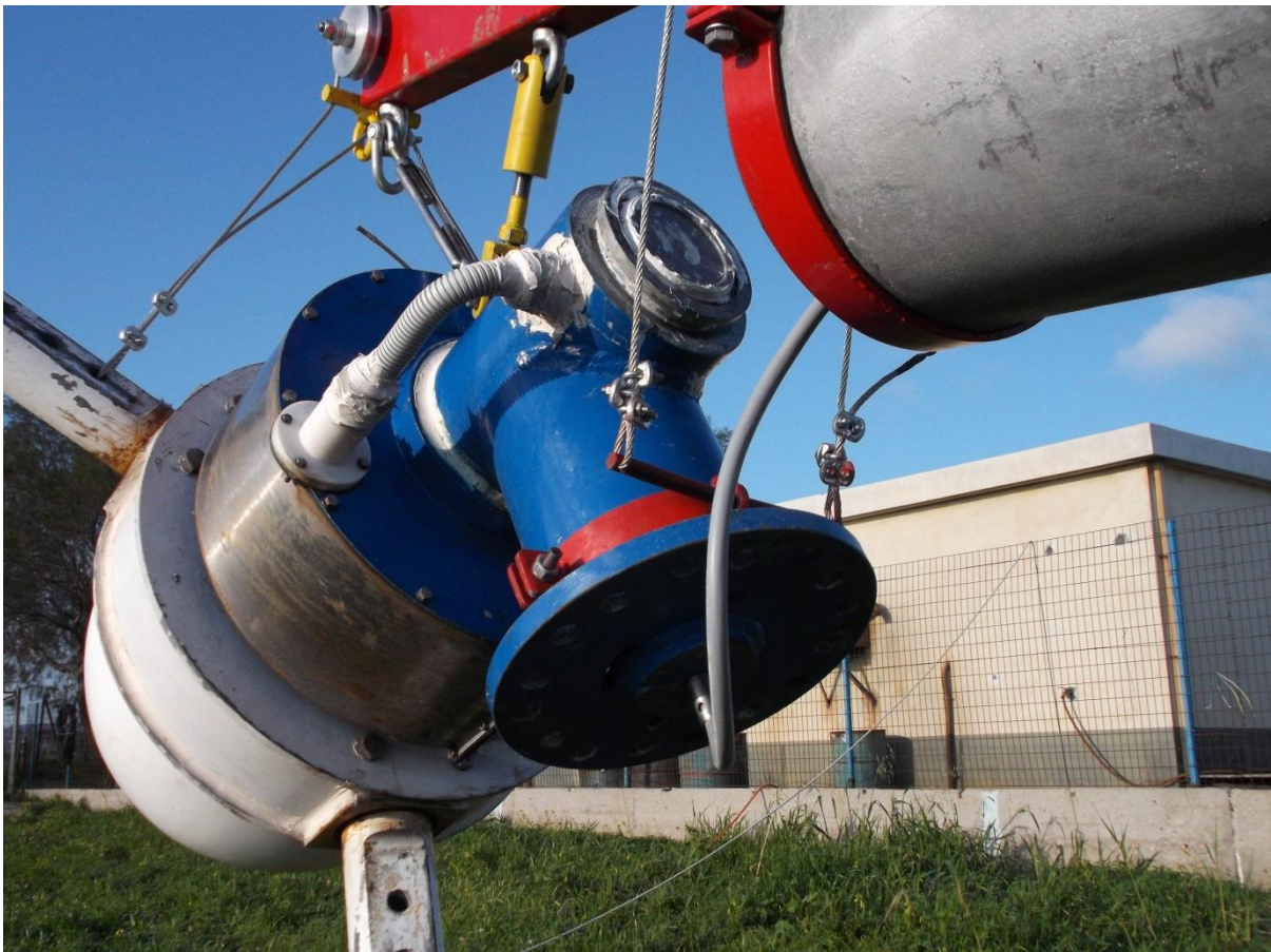
Εικόνα 15 : Διακρίνονται τα σημεία όπου πιάνουν τα ζεύγη συρματοσχοίων.
