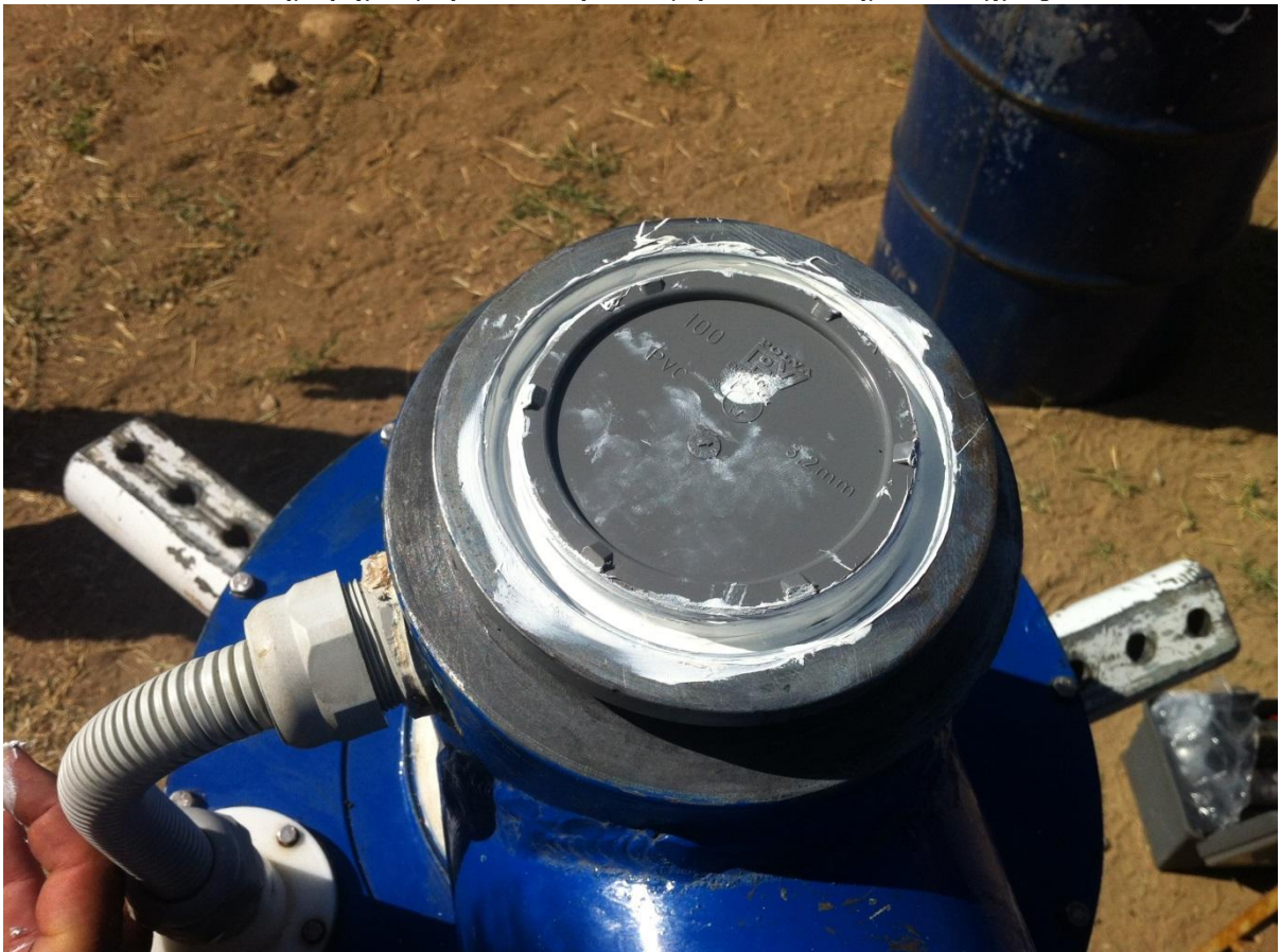
Εικόνα 13 : Προστατευτικό καπάκι στο πίσω μέρος της νασέλας.
