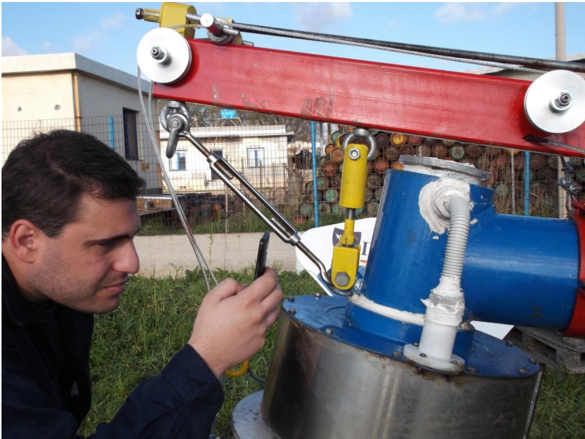
Εικόνα 17 : Διακρίνεται ο κίτρινος και ασημένιος εντατήρας.
