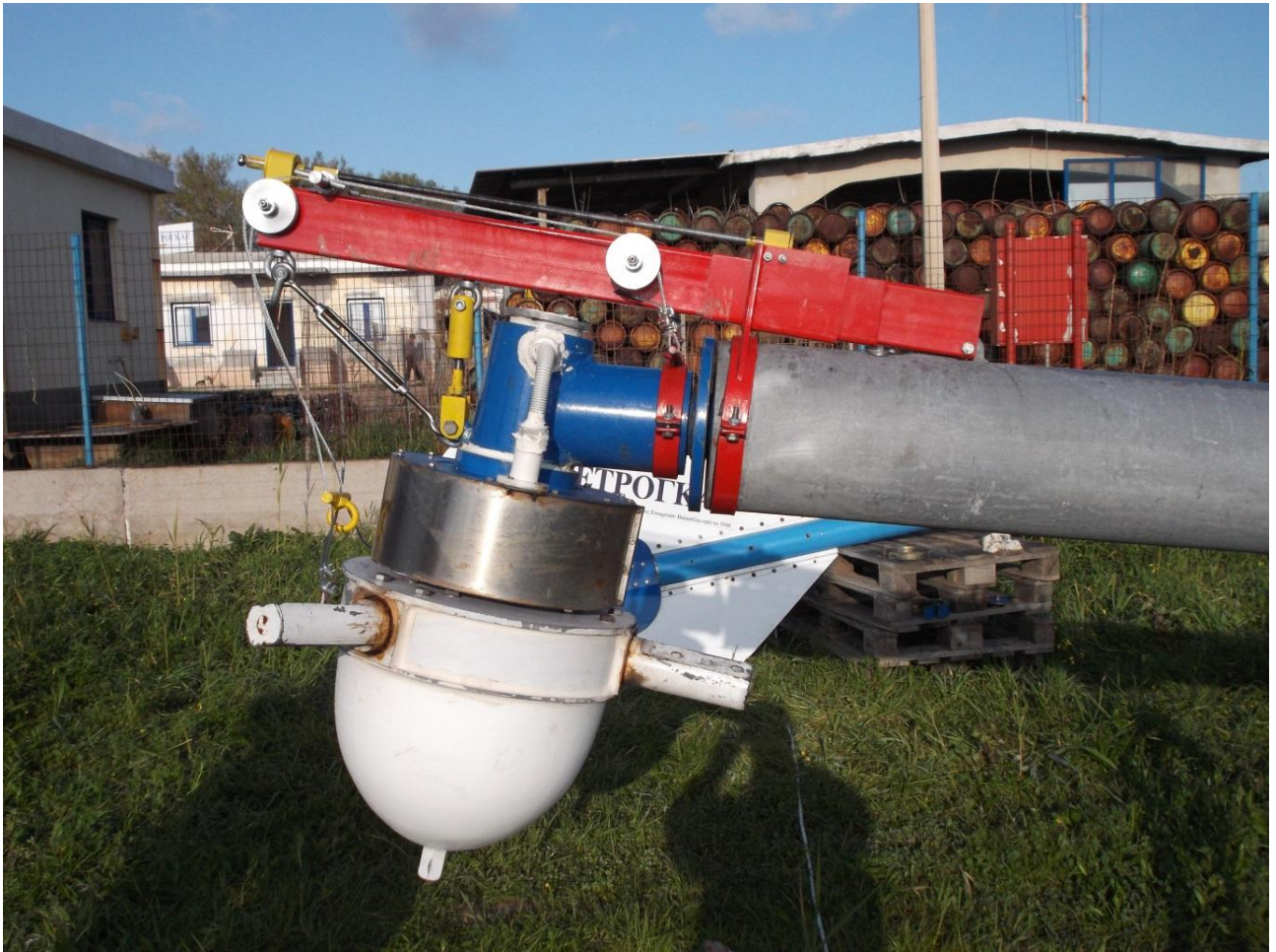
Εικόνα 14 : Ο γερανός ζεύξης-απόξευξης τοποθετημένος στον πυλώνα της ΑΝΘΕΜΙΣ 1.
