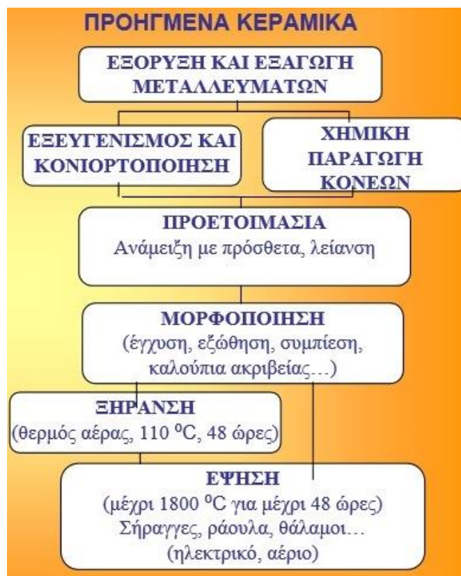
Σχήμα 3.1: Διαδικασία παραγωγής προηγμένων κεραμικών
