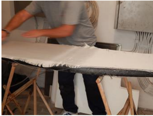
Εικόνα 28: Τοποθετώντας την τρίτη στρώση υφάσματος και η διαδικασία στερεοποίησης
