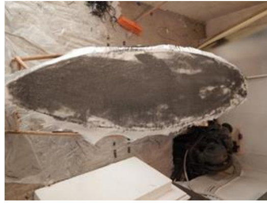
Εικόνα 28: Τοποθετώντας την τρίτη στρώση υφάσματος και η διαδικασία στερεοποίησης
