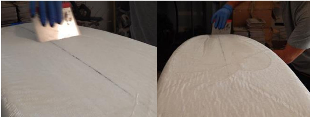
Εικόνα 27: Διαδικασία εμποτισμού, των υφασμάτων που χρησιμοποιούνται, με ρητίνη
