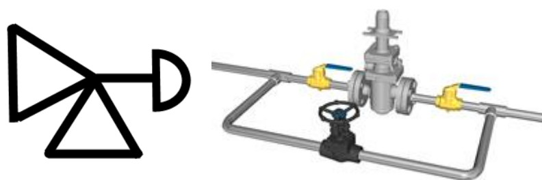
Εικόνα 6-2 Αριστερά: Κυκλωματικό σύμβολο βαλβίδας παράκαμψης. Δεξιά: Διάταξη βαλβίδας παράκαμψης.
