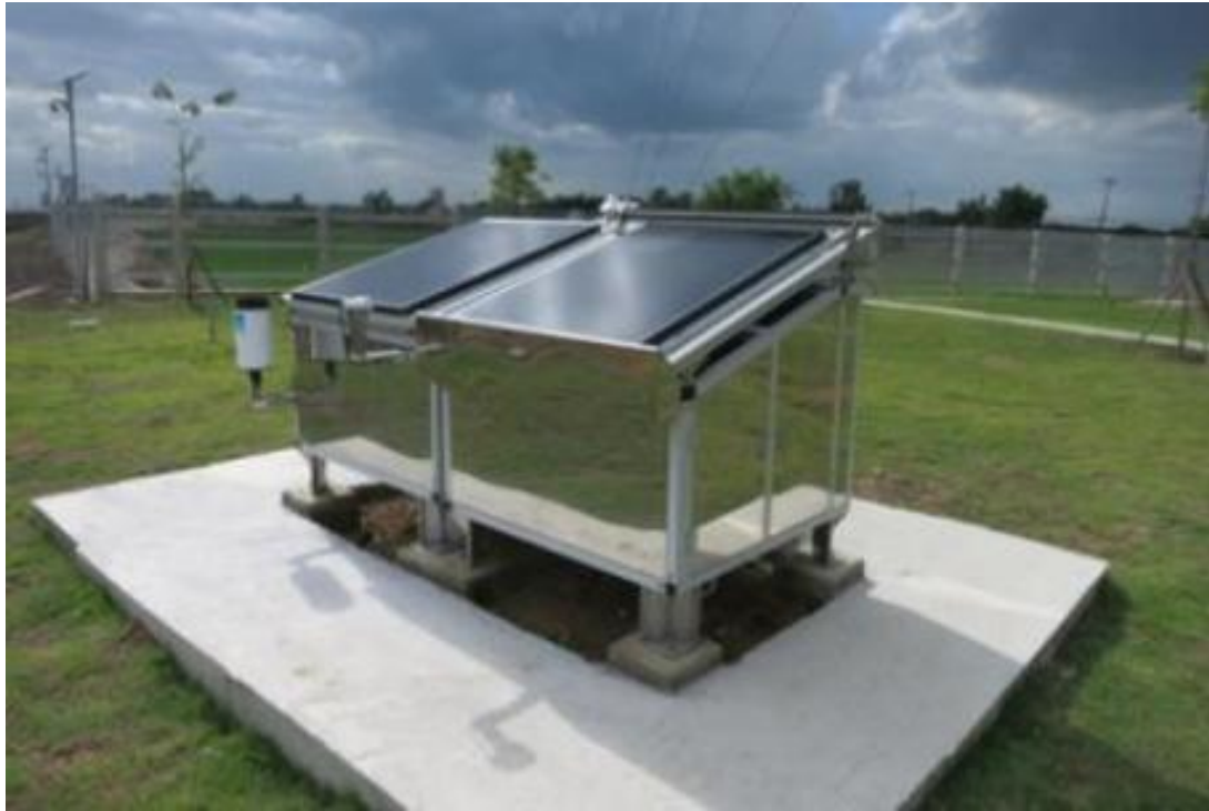
Εικόνα 12 Πειραματική διάταξη για σύγκριση δύο πανομοιότυπων ΦΒ πλαισίων όπου το ένα διατηρείται μονίμως καθαρό με ειδικό μηχανισμό και το άλλο δέχεται την ρύπανση από τον αέρα (Chin Yin Lee1*).
