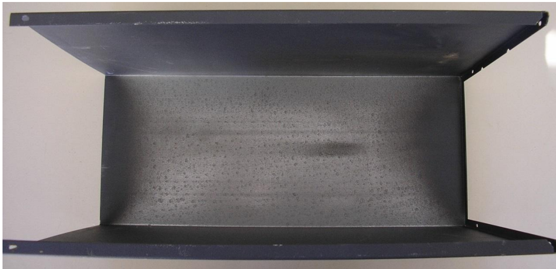
Εικόνα 25 Πλάγια όψη το μεταλλικό κέλυφος για την προστασία του μηχανισμού της συσκευής.
