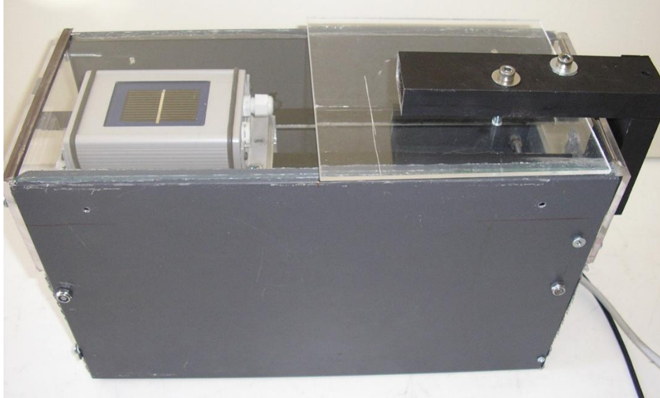
Εικόνα 23 Η τελική μορφή της συσκευής όπως φαίνεται εξωτερικά, διακρίνεται το φωτοβολταϊκό κελί για την μέτρηση της πυκνότητας ηλιακής ακτινοβολίας στις δύο περιπτώσεις του γυαλιού με ρύπανση και χωρίς.
