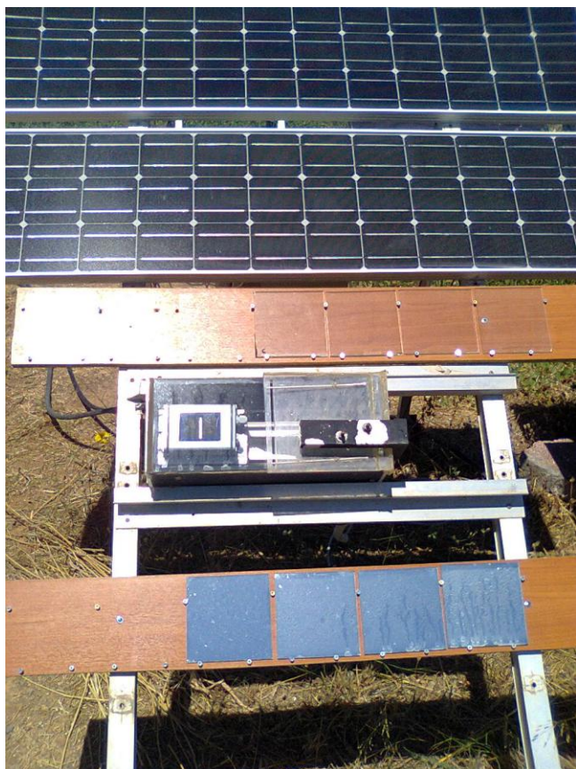
Εικόνα 19 Πειραματικές διατάξεις για τη μελέτη του φαινομένου ρύπανσης επιφάνειας φωτοβολταϊκών. Α) επάνω, τα δύο ΦΒ πλαίσια για σύγκριση απόδοσης όταν το ένα επιδέχεται ρύπανση ενώ το άλλο όχι. Β) στη μέση, αυτόματη συσκευή καταγραφής ρύπανσης επάνω σε γυάλινη επιφάνεια. Γ) κάτω, γυάλινα δοκίμια για παρατήρηση και υπολογισμού της μάζας της ρύπανσης.
