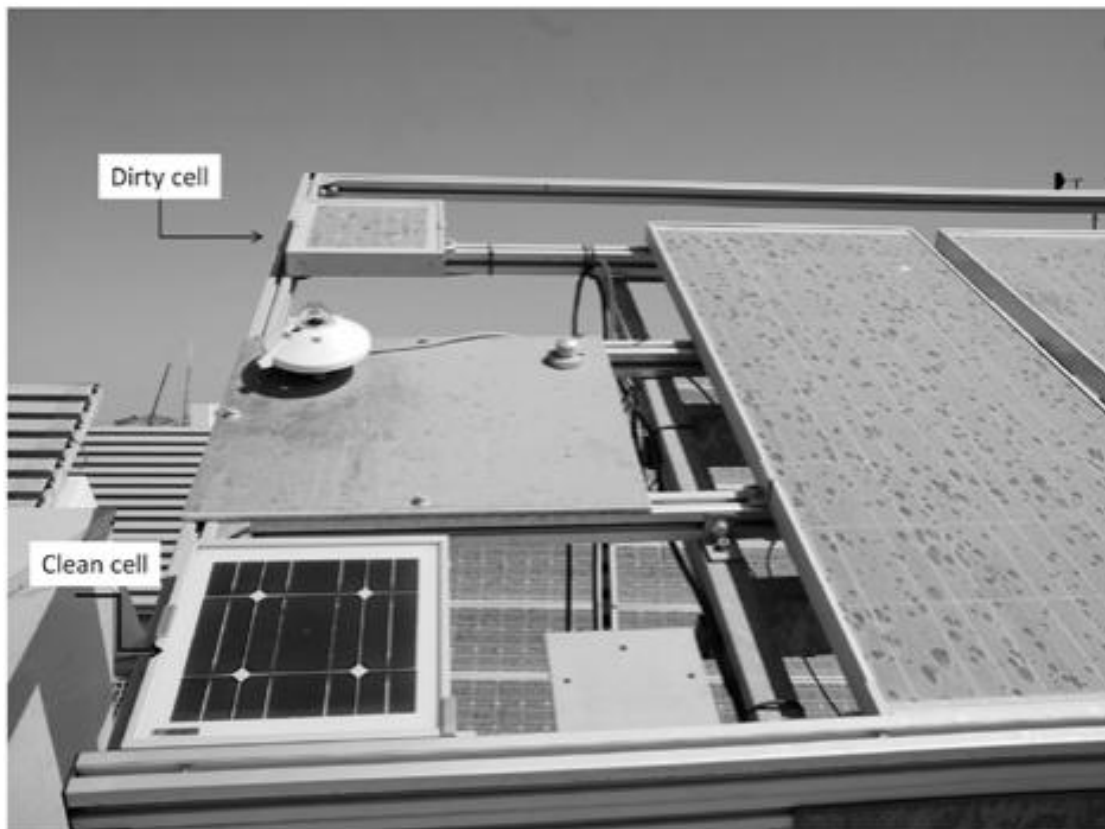
Εικόνα 14 Πειραματική διάταξη στην Ισπανία για την μελέτη του φαινομένου ρύπανσης. Τα πλαίσια βρίσκονται στην ίδια κλίση και στον ίδιο χώρο ώστε να επικρατούν οι ίδιες συνθήκες (J. Zorrilla-Casanova *, 2011).
