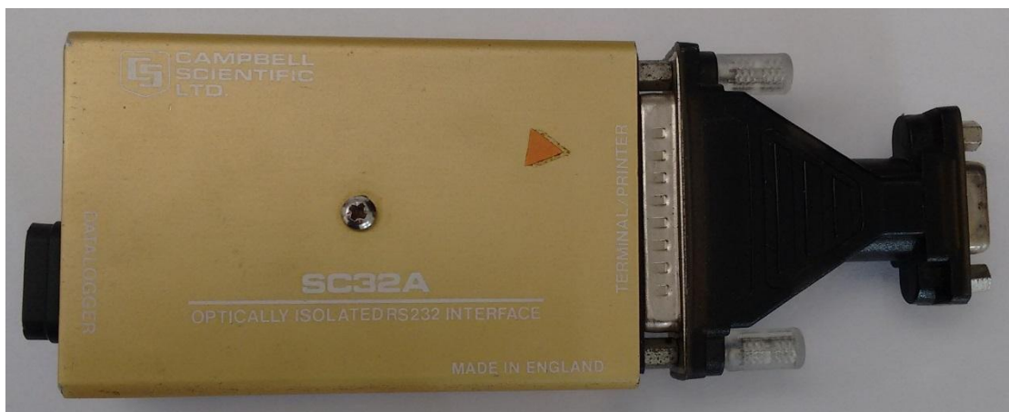
Εικόνα 41 Η συσκευή αυτή βρίσκεται στο ενδιάμεσο της επικοινωνίας Η/Υ με τον Data Logger CR10.
