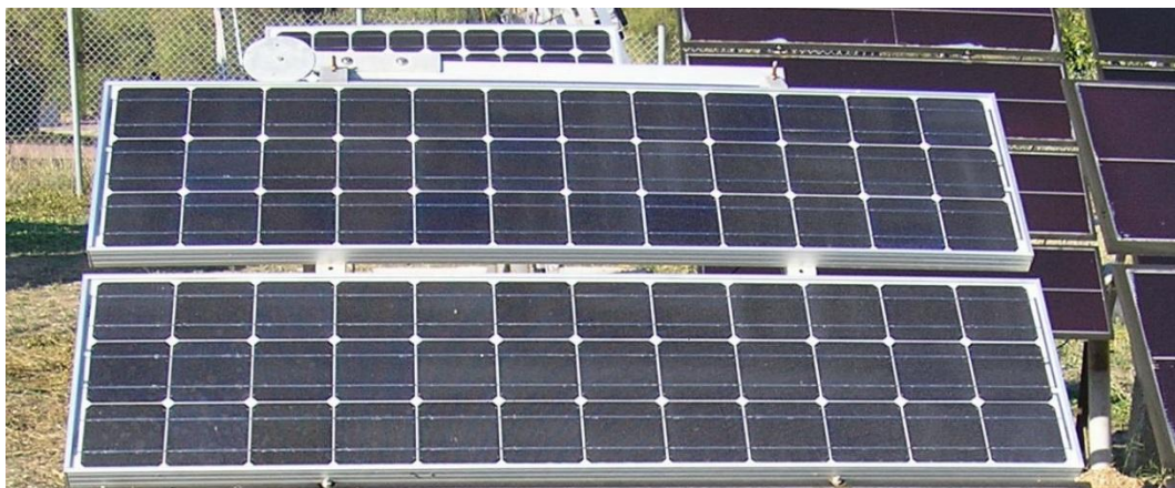
Εικόνα 20 Τα δύο ΦΒ πλαίσια ίδιου τύπου για σύγκριση της απόδοσής τους υπό ίδιες περιβαλλοντικές συνθήκες αλλά μόνο το ένα δέχεται ρύπανση στην επιφάνεια του.
