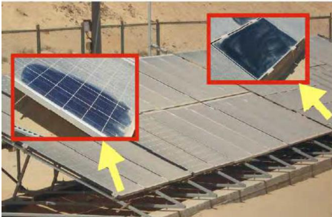
Εικόνα 6 Πειράματα στην Αίγυπτο με πολύ υψηλά επίπεδα σκόνης οι απώλειες έφτασαν το 35% σε περίοδο ενός έτους.
