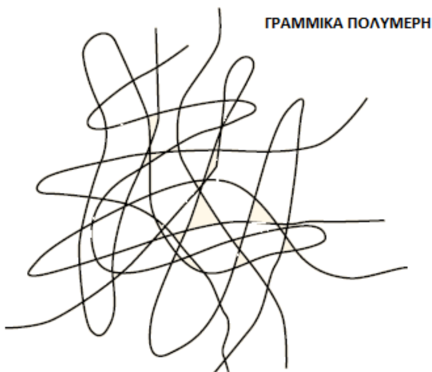
Εικόνα 1.1.1: Μοριακές αλυσίδες των θερμοπλαστικών
