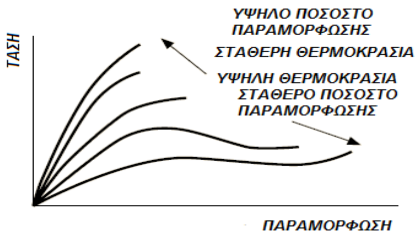
Εικόνα 4.7.1: Η επίδραση της θερμοκρασίας ή του ποσοστού παραμόρφωσης στις καμπύλες τάσης-παραμόρφωσης
