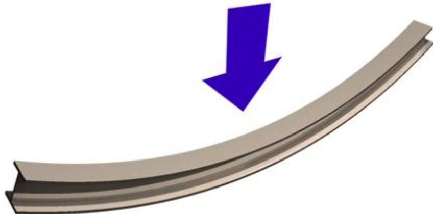
Εικόνα 3.4.1: Κάμψη ενός υλικού
