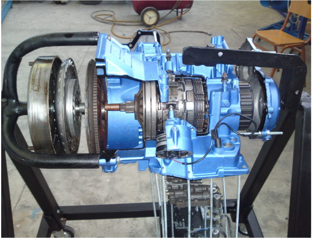
Ολοκληρωμένη βάση στήριξης αυτόματου κιβωτίου σε τομή.
