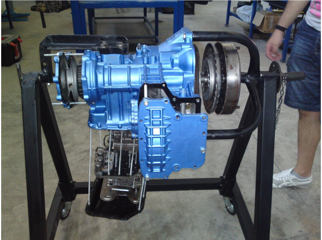
Ολοκληρωμένη βάση στήριξης αυτόματου κιβωτίου σε τομή.
