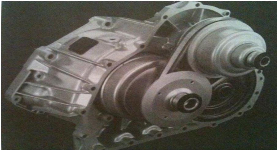
Κιβώτιο ταχυτήτων συνεχούς μεταβαλλόμενης σχέσης μετάδοσης.
