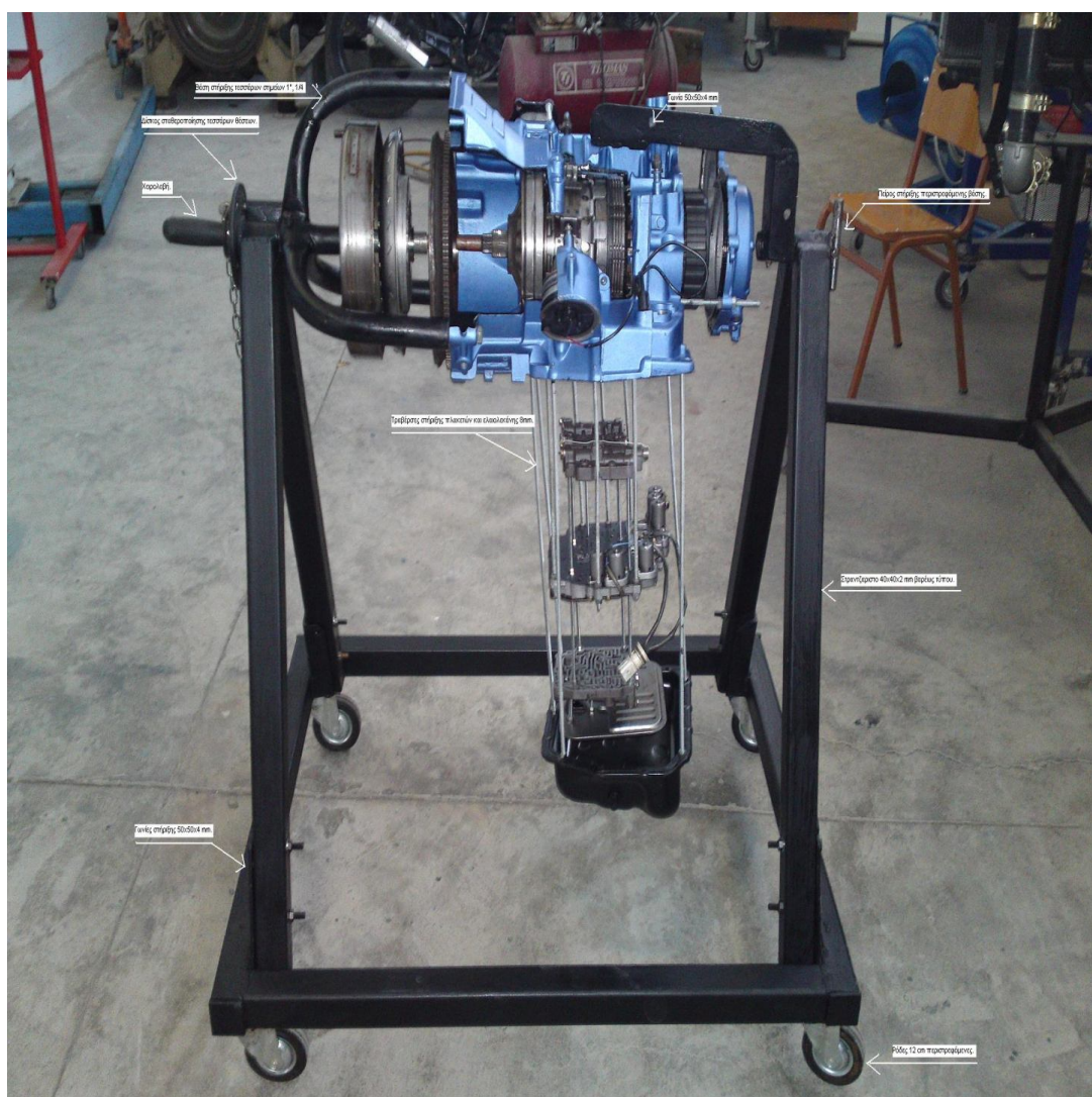
Ολοκληρωμένη βάση στήριξης αυτόματου κιβωτίου σε τομή.
