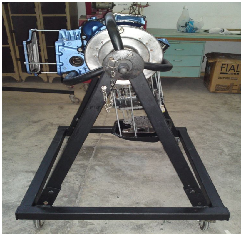
Ολοκληρωμένη βάση στήριξης αυτόματου κιβωτίου σε τομή.
