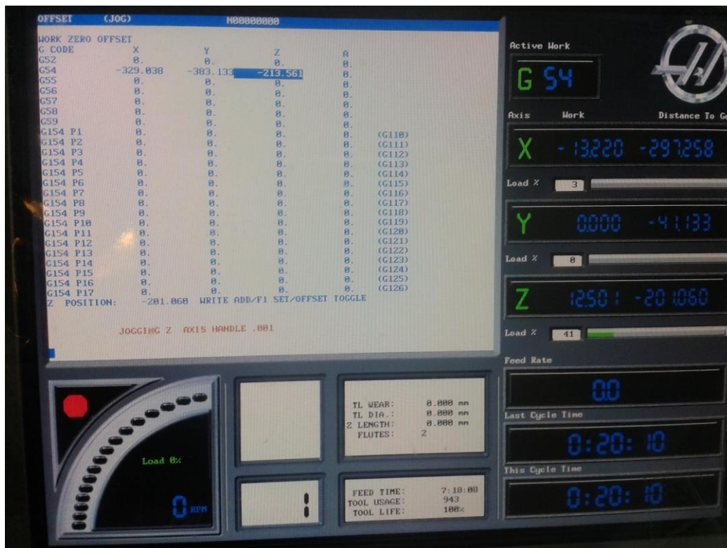
Εικόνα 11 : Μενού WORK ZERO OFFSET και μηδενισμός του άξονα Z.
