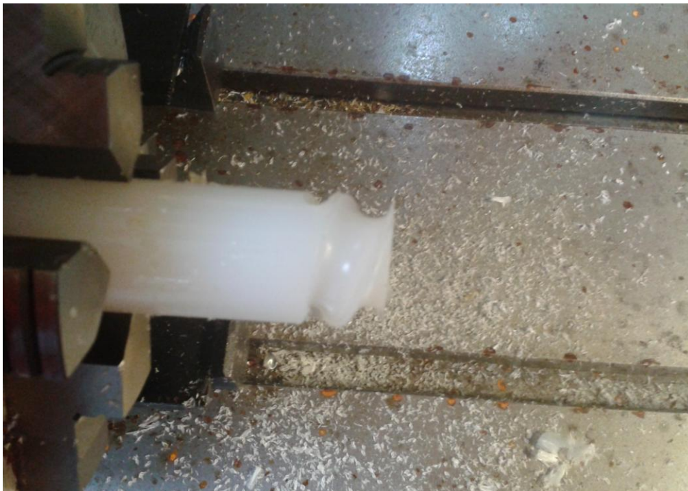
Εικόνα 2 : Κομμάτι 1 ο με τις τελικές επιφάνειες αμέσως μετά το τελείωμα των κατεργασιών και πριν την κοπή του στο κατάλληλο μήκος.
