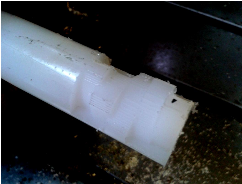
Εικόνα 4 : Κομμάτι 2 ο ξεχονδρισμένο από τη 1 πλευρά.
