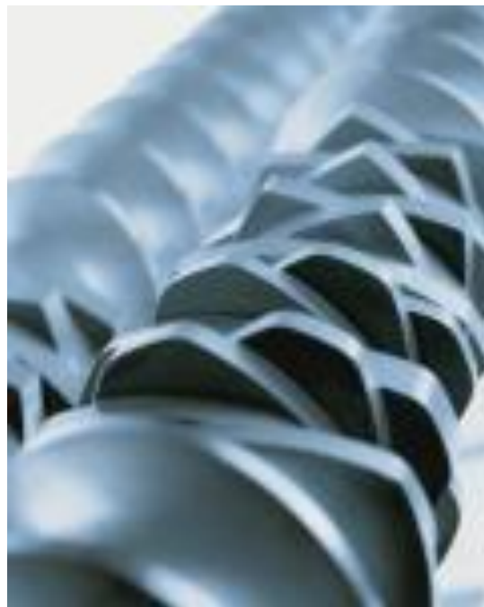
Εικόνα 8 : Τεμαχίδια τοποθετημένα σε κοχλία ή εκβολέα.
