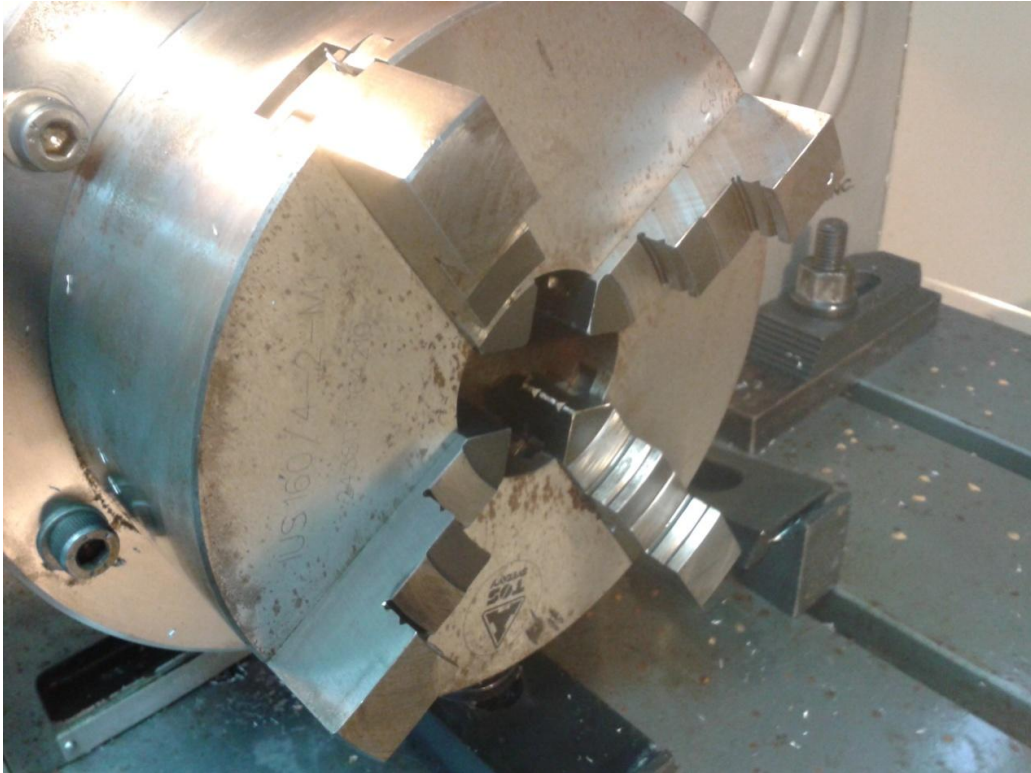
Εικόνα 2 : Σιαγώνες τσοκ με μικρή επιφάνεια σύσφιξης στο εσωτερικό τους.
