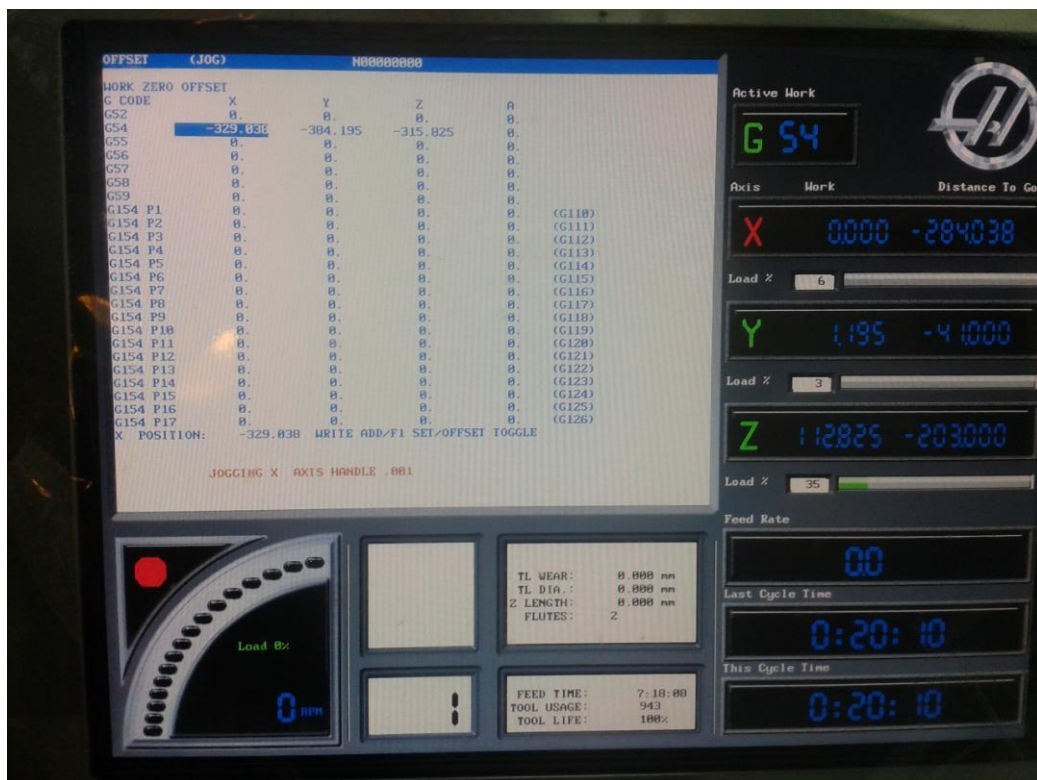
Εικόνα 6 : Μενού WORK ZERO OFFSET και μηδενισμός του άξονα x.
