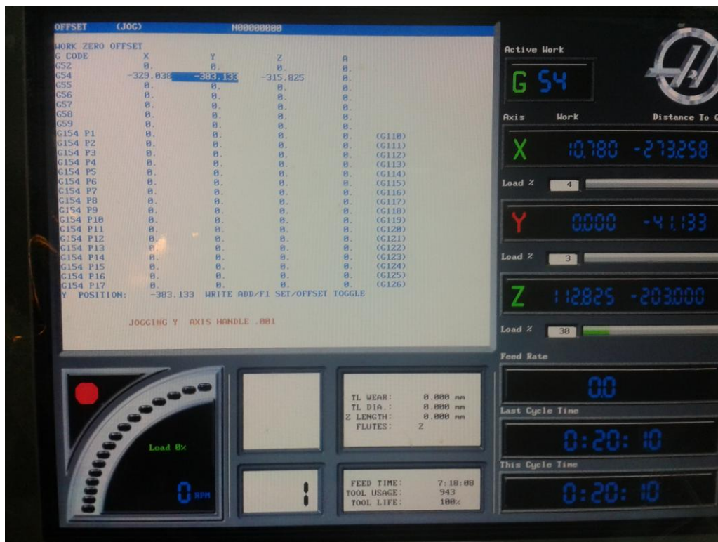
Εικόνα 9 : Μενού WORK ZERO OFFSET και μηδενισμός του άξονα Y.
