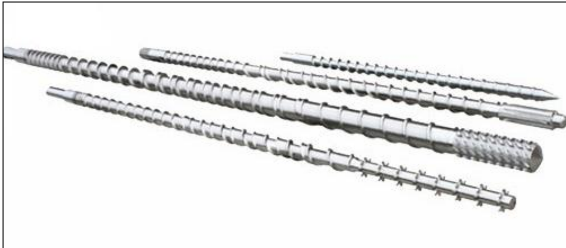
Εικόνα 7 : Μασίφ μεταλλικοί κοχλίες ή εκβολείς
