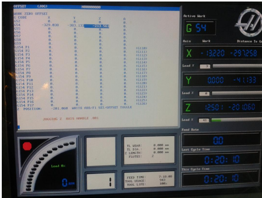
Εικόνα 2 : Μενού WORK ZERO OFFSET και μηδενισμός του άξονα z.
