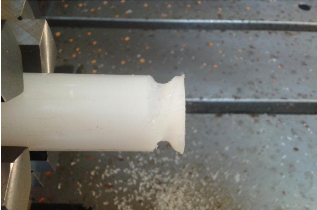
Εικόνα 1 : Κομμάτι 1 ο ξεχονδρισμένο και από τις 2 πλευρές.
