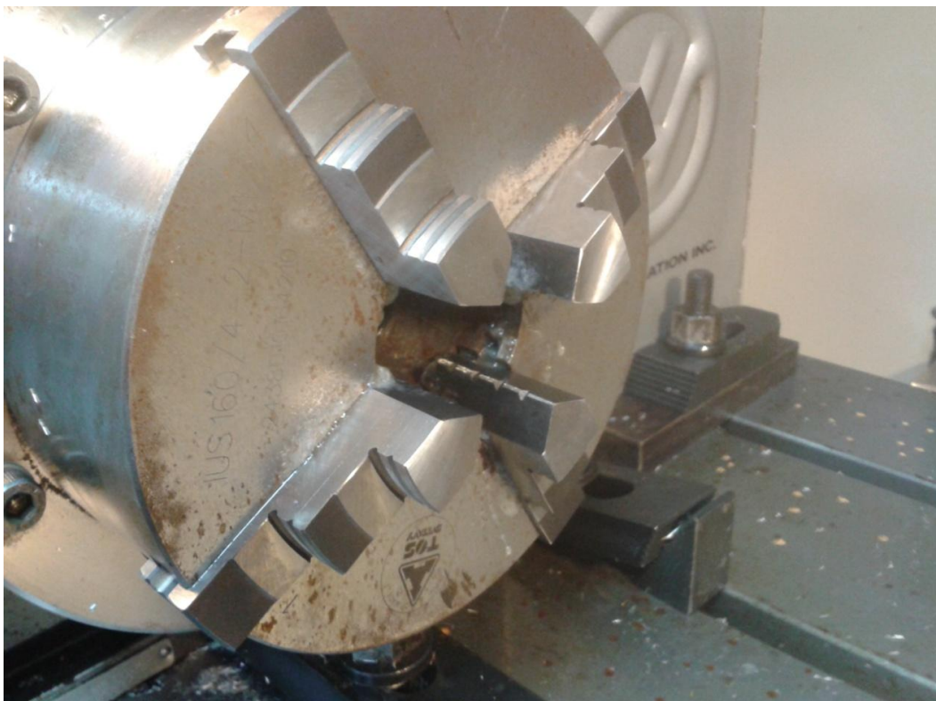
Εικόνα 3 : Σιαγώνες τσοκ με μεγαλύτερη επιφάνεια σύσφιξης στο εσωτερικό τους.
