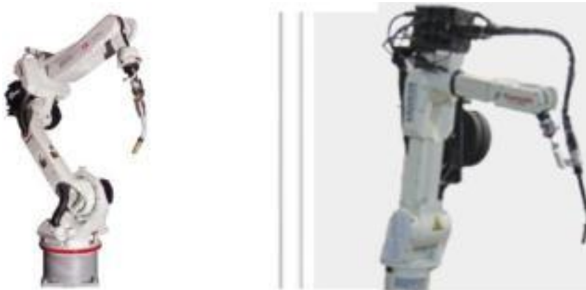
Εικόνα 9.1. Ρομποτικοί βραχίονες συγκόλλησης με 6 βαθμούς ελευθερίας.
