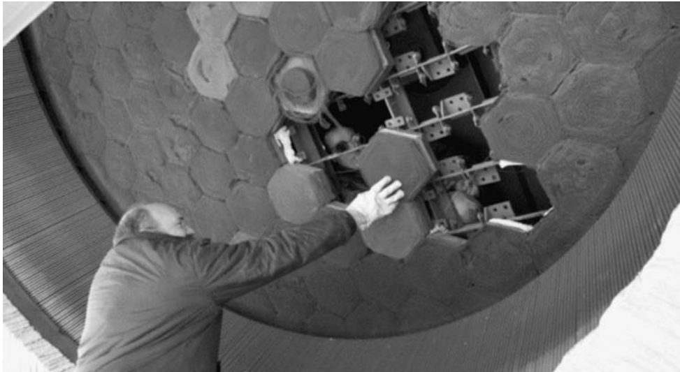
Εικόνα 3.7 Εμπρόσθια όψη Ογκομετρικού Δέκτη. Η απορροφητική επιφάνεια αποτελείται από εξαγωγικό συρμάτινο πλέγμα. Ο εξωτερικός δακτύλιος περιλαμβάνει το σύστημα επιστροφής του αέρα (Almeria, Ισπανία) [19]
