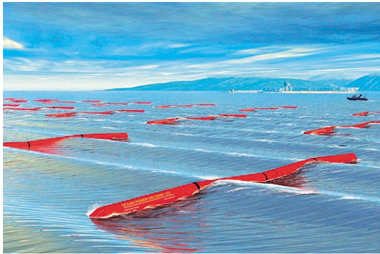
Εικ. 1.5 Σύστημα Εκμετάλλευσης Θαλάσσιας Ενέργειας "Pelamis"
