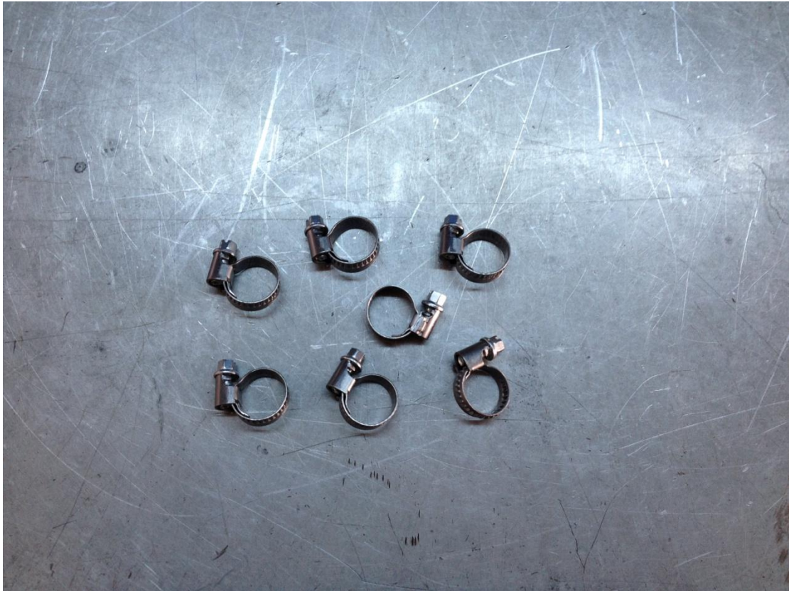
Εικόνα 49 Σφικτήρες σύσφιξης σωληνώσεων καυσίμου.
