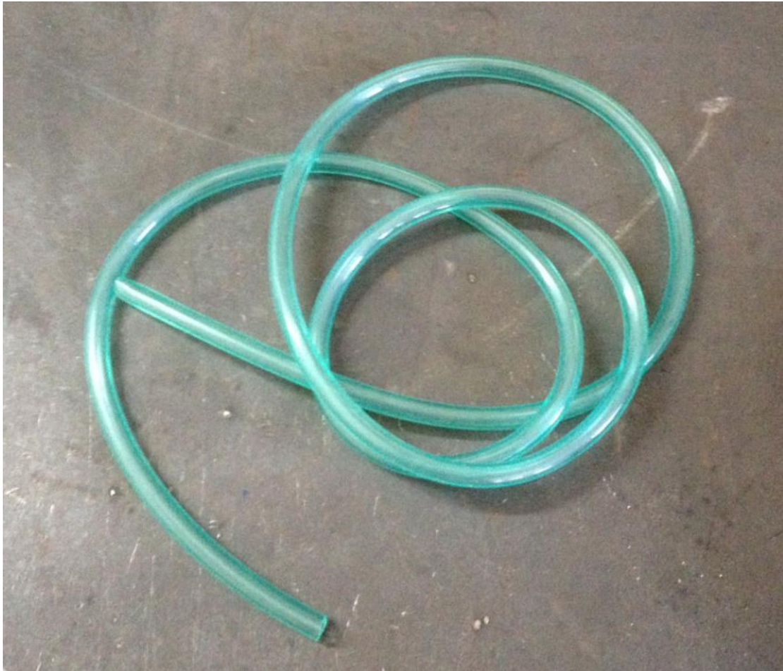
Εικόνα 58 Σωληνάκι εσωτερική διαμέτρου 6 χιλιοστών για την σύνδεση των επιστροφών του εγχυτήρων καυσίμου.
