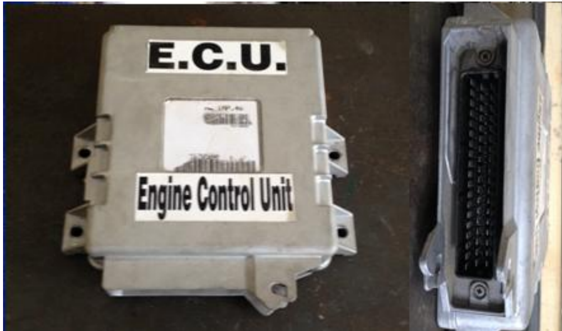
Εικόνα 41 Κεντρική μονάδα ελέγχου ECU η οποία είναι ολοκληρωμένη μονάδα ηλεκτρονικού υπολογιστή οι οποία για τον έλεγχο όλων των λειτουργιών του ηλεκτρικού συστήματος αλλά και άλλων υποσυστημάτων.
