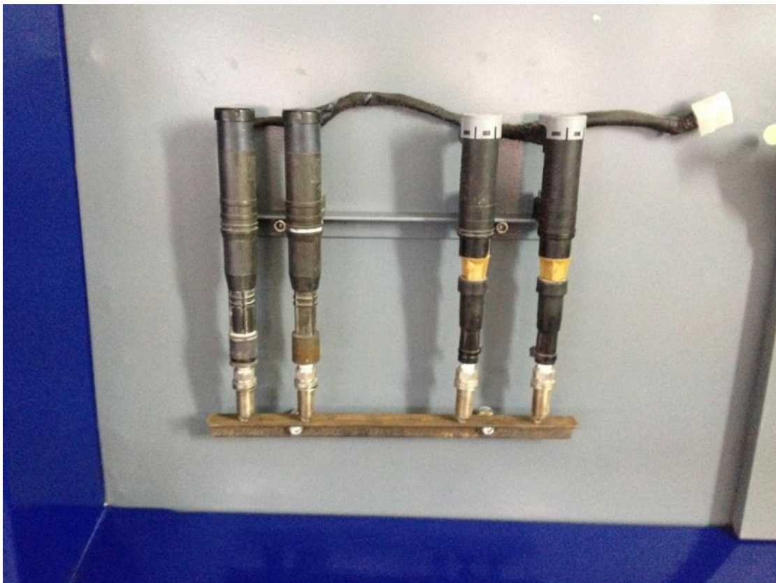
Εικόνα 40 Συνδεδεμένα μπουζοκαλώδια με τους σπινθηριστές (μπουζί) πάνω στην κατασκευή.
