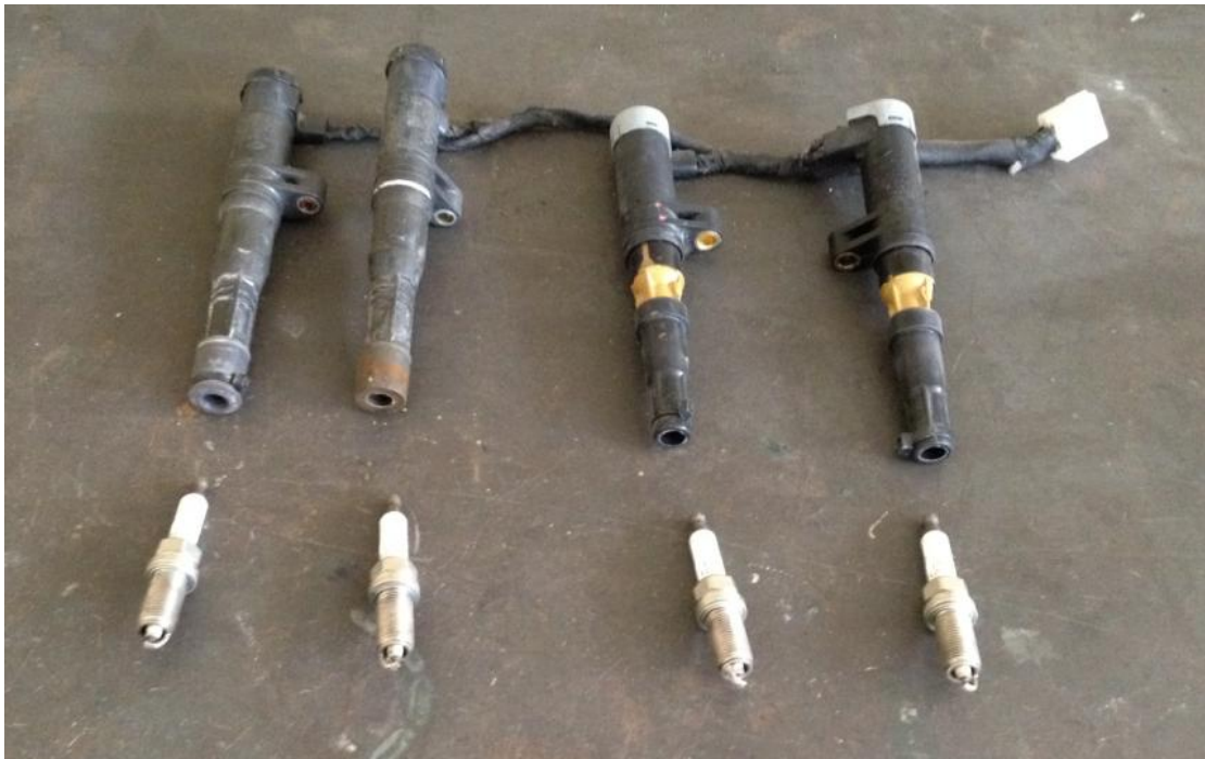
Εικόνα 38 Πολλαπλασιαστές μαζί με τους σπινθηριστές.
