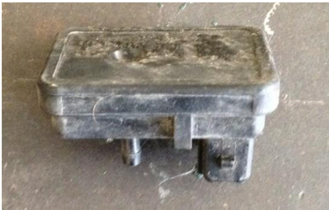
Εικόνα 32 Αισθητήρας MAP χρησιμοποιείται για την μέτρηση του φορτίου του κινητήρα (σε συνάρτηση με τον αριθμό στροφών) και είναι βασικό για τον υπολογισμό της διάρκειας ψεκασμού. Ο αισθητήρας είναι συνδεδεμένος μέσω ενός σωλήνα υποπίεσης στην πολλαπλή εισαγωγής μετά την πεταλούδα γκαζιού.
