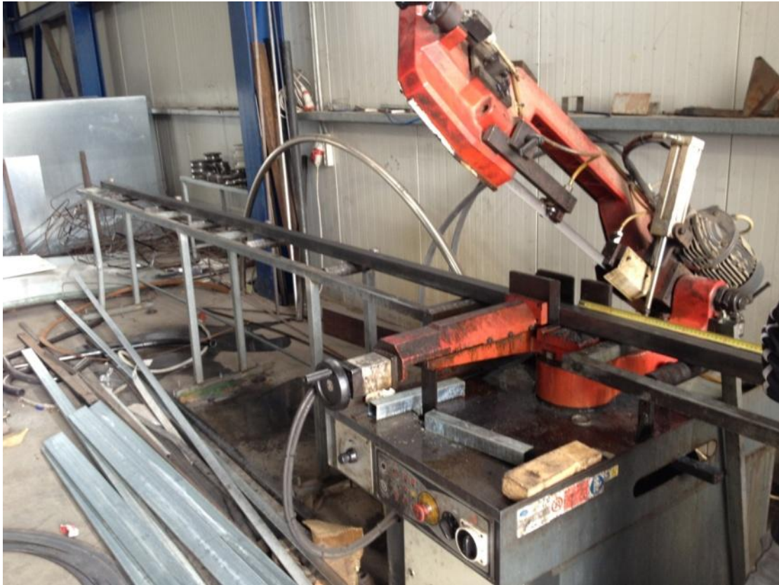
Εικόνα 7 Ηλεκτρικό μηχάνημα κοπής κοιλοδοκών με υδραυλικό σύστημα κίνησης σε ειδικευμένο μηχανουργείο .
