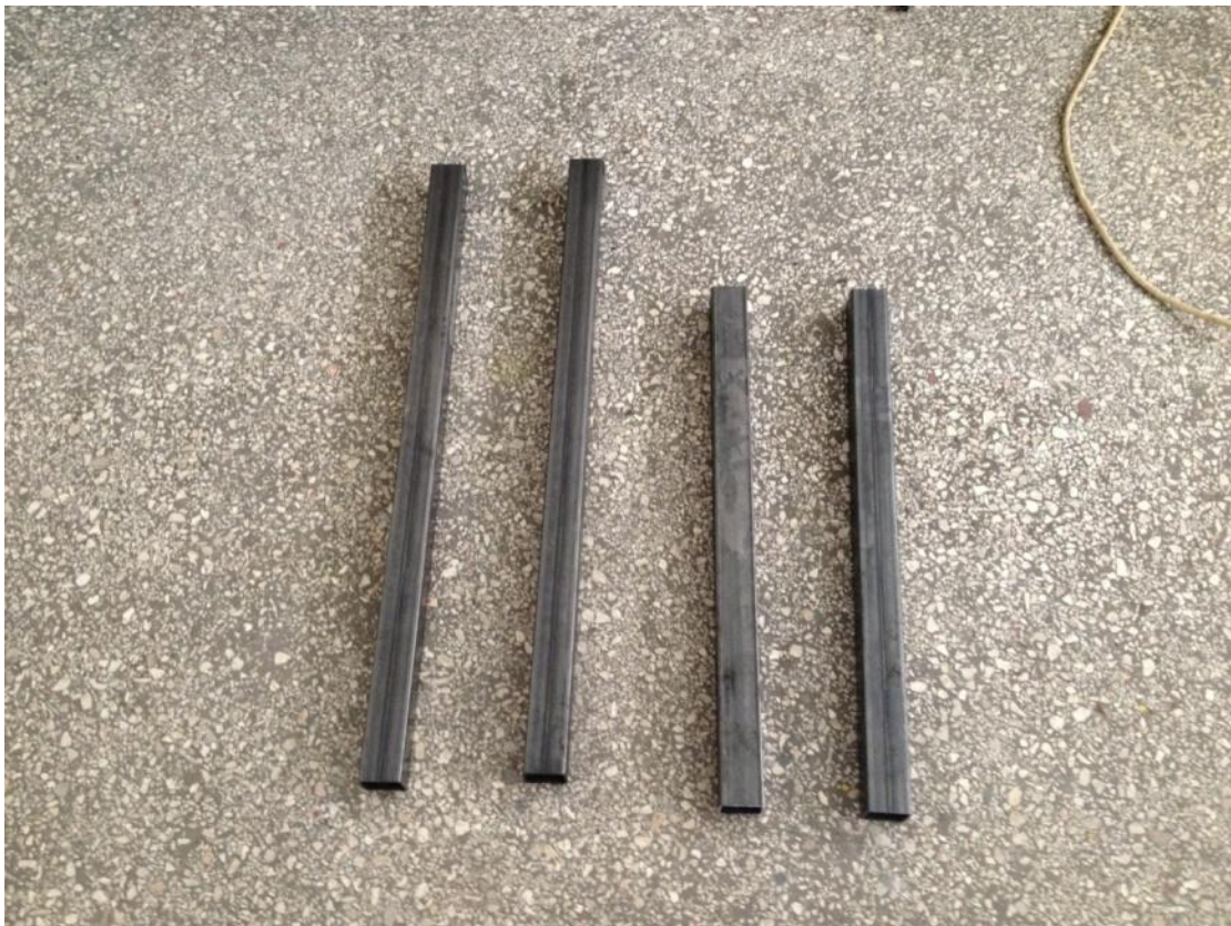
Εικόνα 5 Τετράγωνοι κοιλοδοκοί στήριξης της κατασκευής διαστάσεων 50x50.
