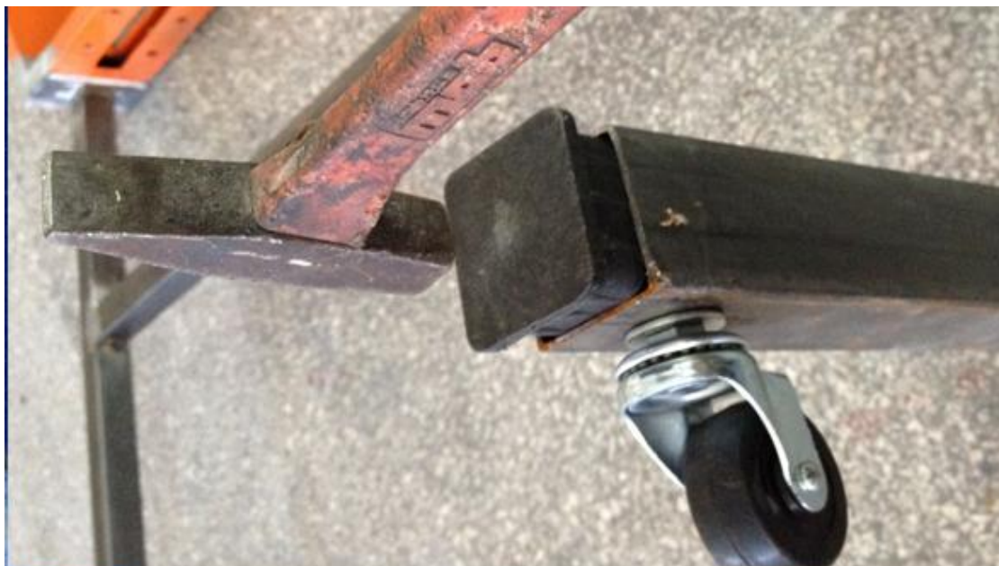
Εικόνα 18 Τοποθέτηση προστατευτικού καλύμματος κοιλοδοκών το οποίο συγκρατείται λόγω της σφήνωσης μεταξύ κοιλοδοκού και καλύμματος.
