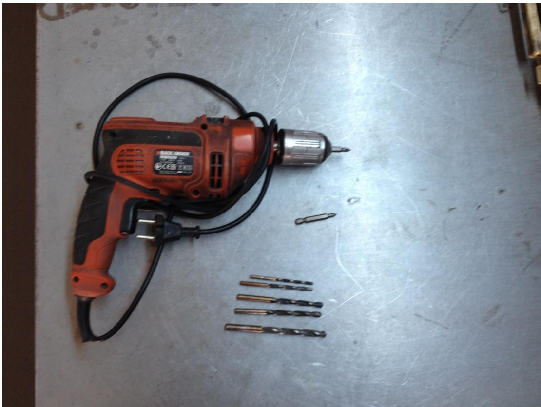
Εικόνα 50 Δράπανο μαζί με τα εξαρτήματα του για το άνοιγμα οπών και την σύσφιξη αυτοδιάτρωτων βιδών.
