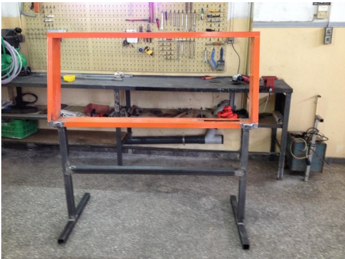
Εικόνα 14 Συναρμολόγηση βάσης στήριξης με πλαίσιο, όπου προστέθηκε οριζόντιο τμήμα κοιλοδοκού για την καλύτερη αντοχή της κατασκευής.
