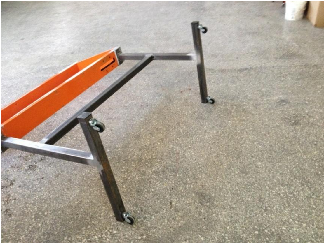
Εικόνα 19 Τελική τοποθέτηση των τεσσάρων τροχών κύλισης σε επιλεγμένες θέσης για την καλύτερη ισοροποία της κατασκευής.
