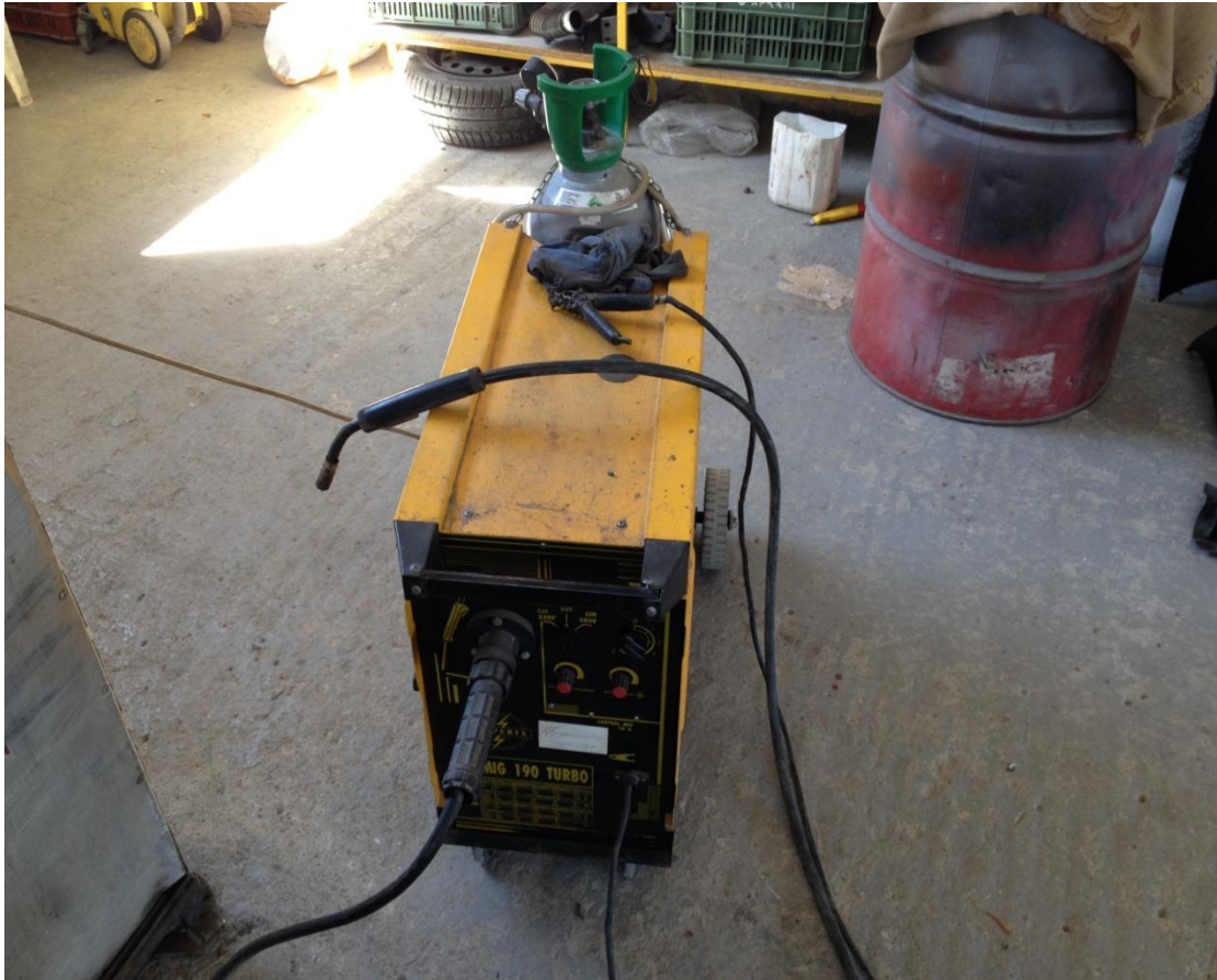
Εικόνα 56 Γεννήτρια συγκόλλησης TIG. Χρησιμοποιήθηκε για την συγκόλληση της πλατφόρμας επειδή ο κοιλοδοκός ήταν 1,5mm.
