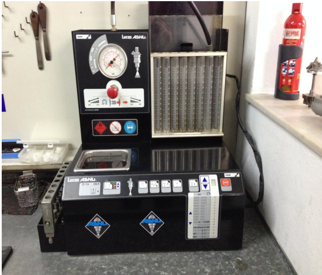
Εικόνα 65 Μηχάνημα συντήρησης μπεκ με υπέρηχους.
