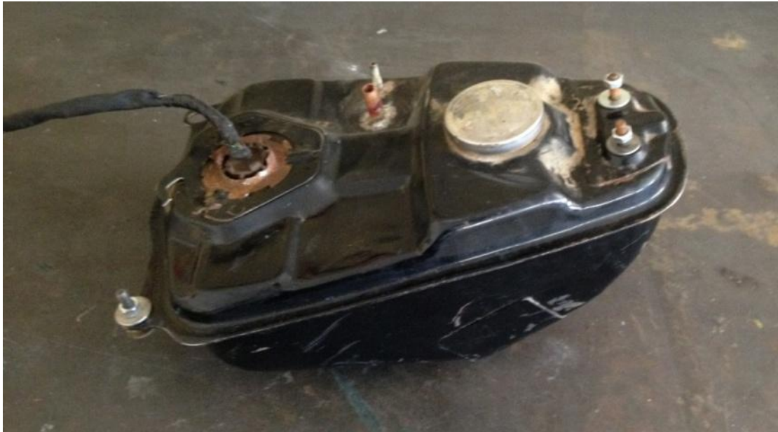
Εικόνα 36 Δοχείο βενζίνης από μεταχειρισμένη μοτοσυλέκτα Honda astra. Έγινε επεξεργασία και τροποίηση της παροχής και της επιστροφής του καυσίμου.
