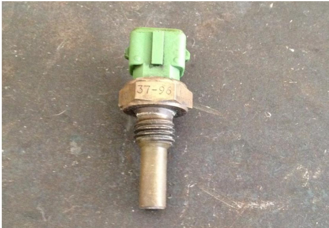
Εικόνα 28 Αισθητήρας θερμοκρασίας ψυκτικού υγρού για τον έλεγχο της θερμοκρασίας του κινητήρα.
