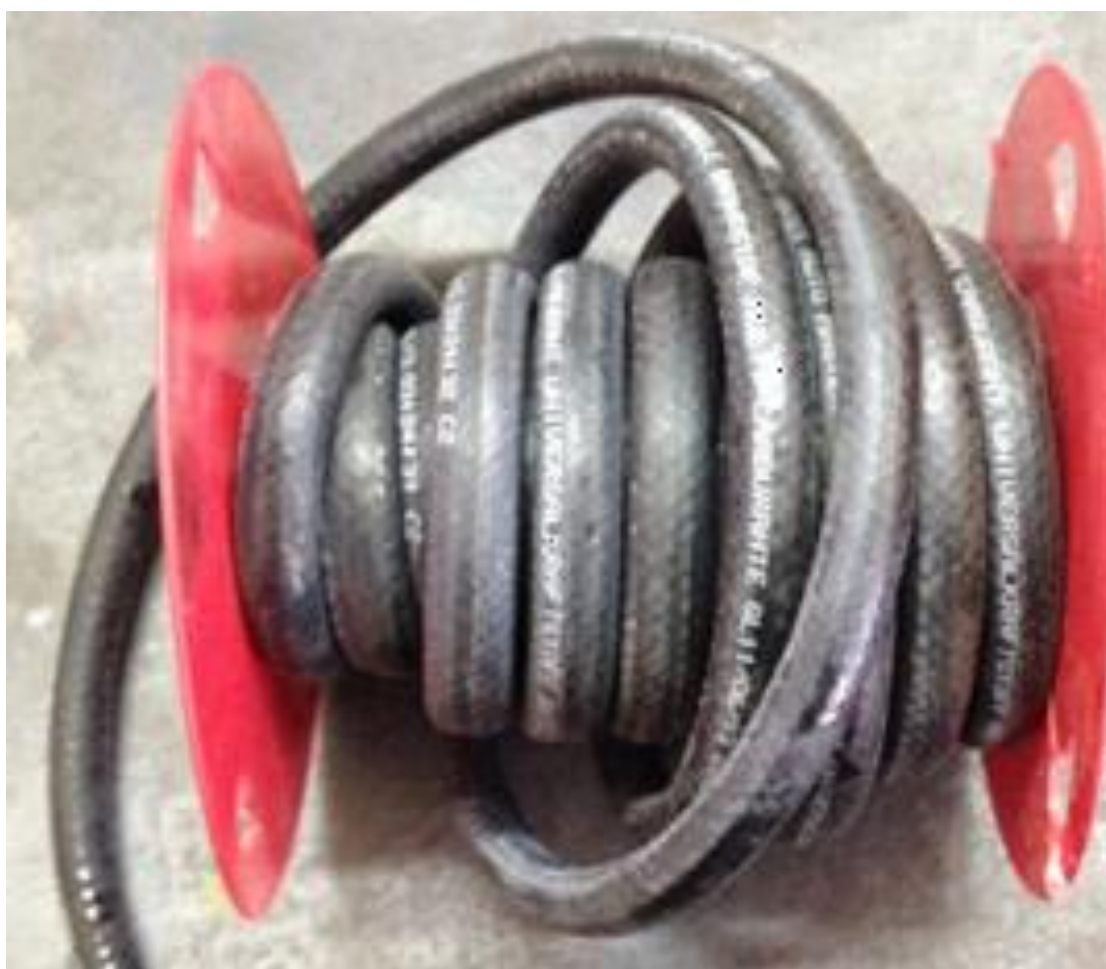
Εικόνα 57 Σωληνάκι εσωτερικής διαμέτρου 8 χιλιοστών για την σύνδεση του φίλτρου βενζίνης στην μπεκιέρα.
