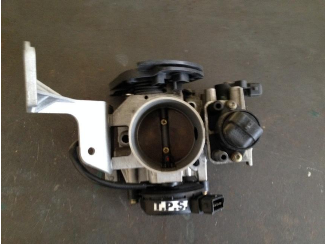
Εικόνα 43 Μονάδα πεταλούδας γκαζιού για την ρύθμιση του στοιχειομετρικού μίγματος.
