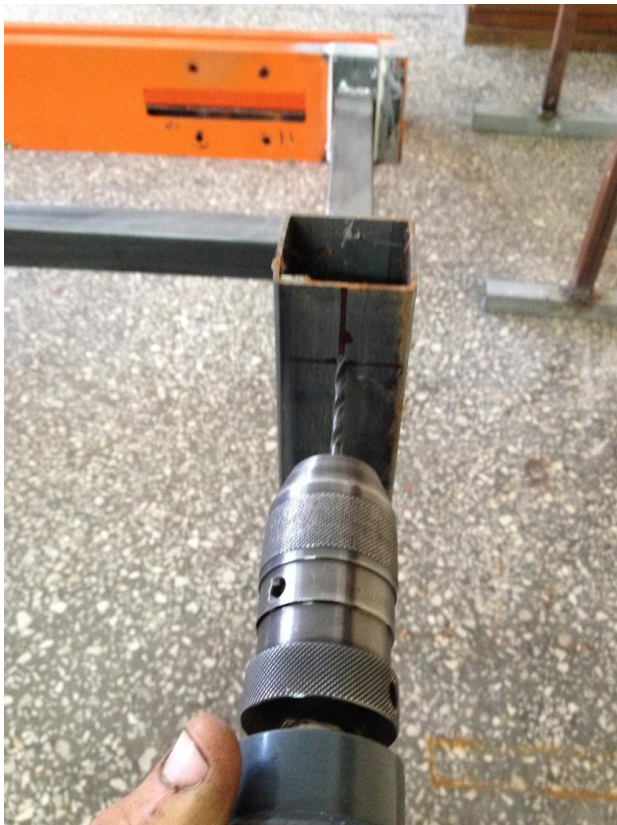
Εικόνα 16 Διαδικασία διάτρησης κοιλοδοκών για να τοποθετηθούν τα ροδάκια κύλισης.
