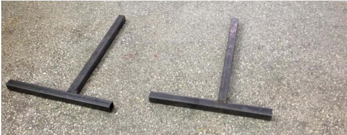
Εικόνα 11 Συναρμολόγηση κοιλοδοκών για την βάση στήριξης
