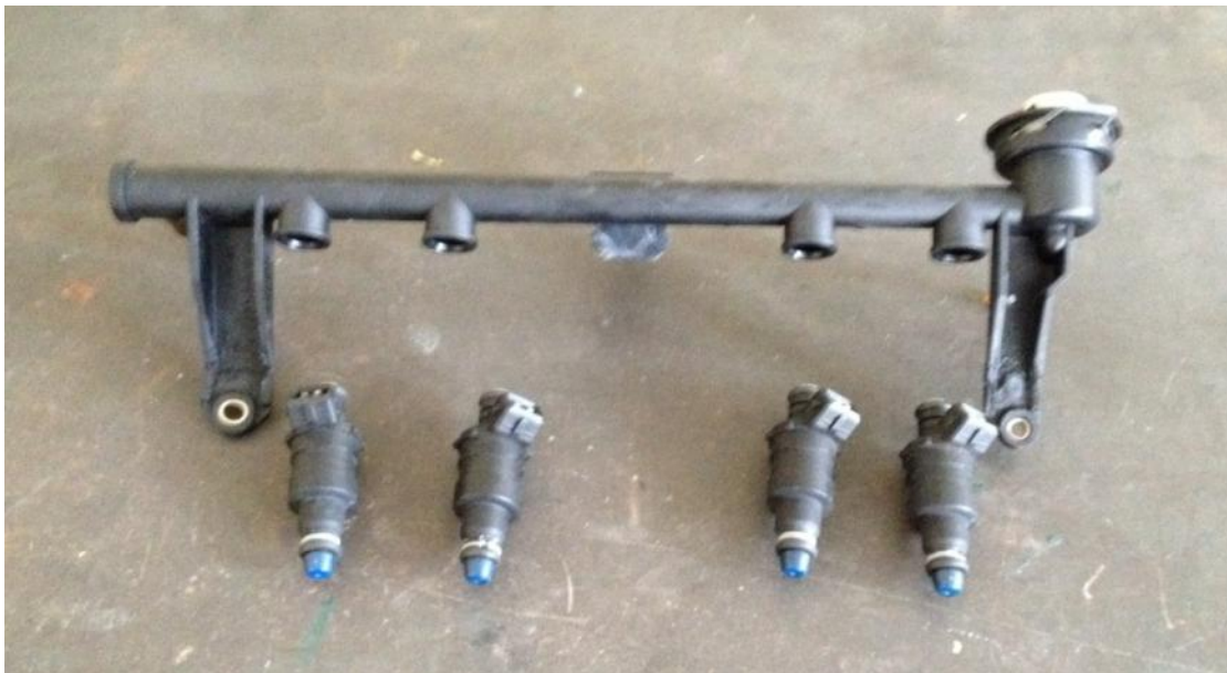
Εικόνα 35 Ο συλλέκτης - μπεκίερα έγχυσης αέριος φάσης αποτελείται τέσσερις εγχυτήρες - μπεκ και ένα ρυθμιστή πίεσης οποίος διατηρεί σταθερή την πίεση στη μπεκίερα.
