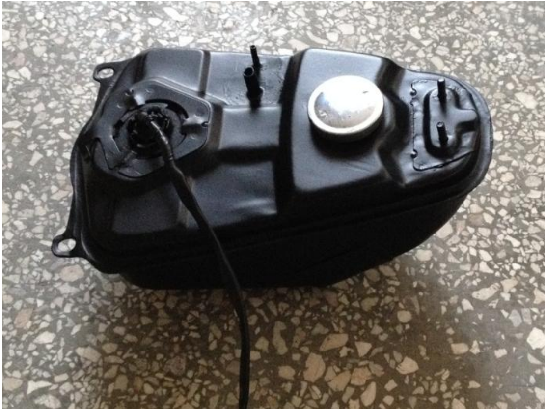
Εικόνα 26 Τελική μορφή δοχείου βενζίνης έπειτα από την βαφή.
