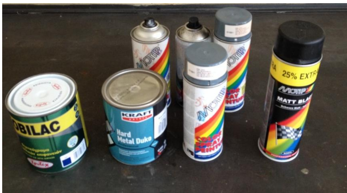
Εικόνα 21 Υλικά βαφής των μεταλλικών μερών της κατασκευής για την προστασία της από οξείδωση και καλύτερη αισθητική.
