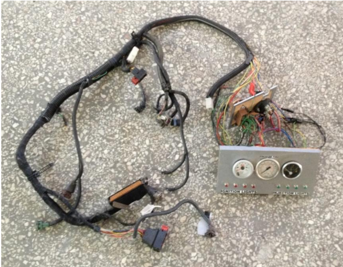
Εικόνα 60 Καλώδια σύνδεσης αισθητήρων, ενεργοποιητών και μονάδας ελέγχου, ακόμα φαίνονται τα όργανα των στροφών και της ποσότητας καυσίμου.
