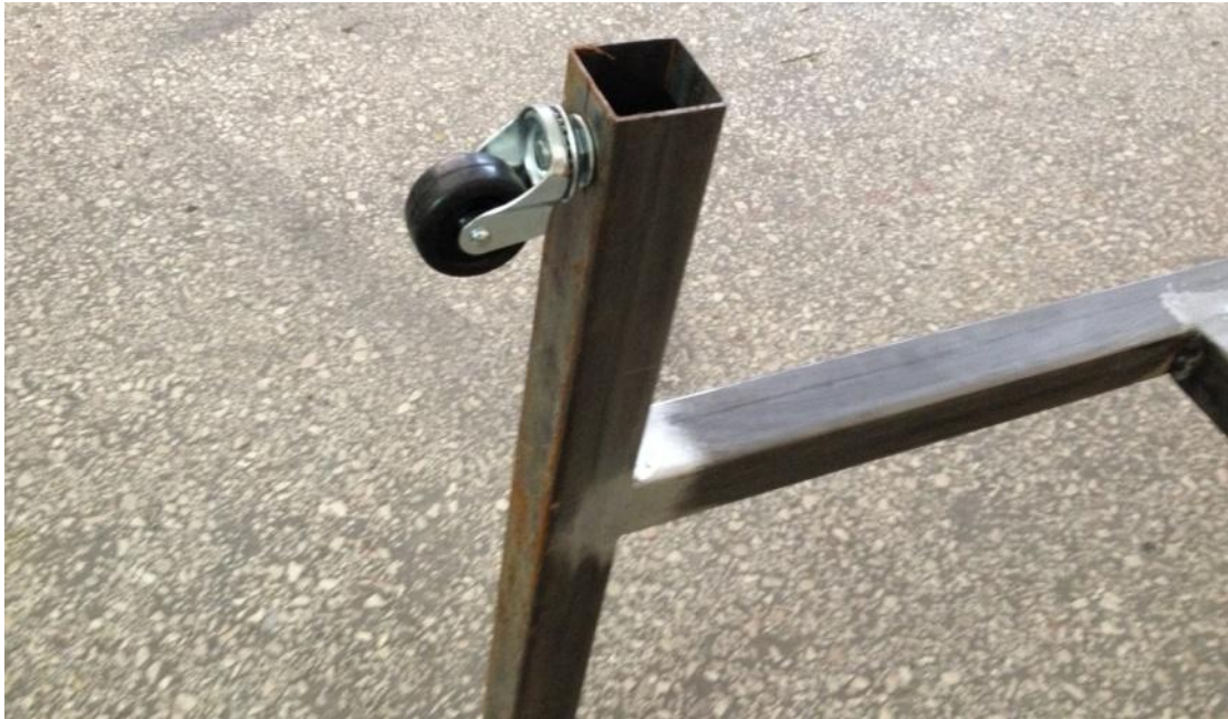
Εικόνα 17 Έτοιμο τοποθετημένο ροδάκι στην βάση της κατασκευής με διπλό περικόχλιο για ασφάλεια σύσφιξης.
