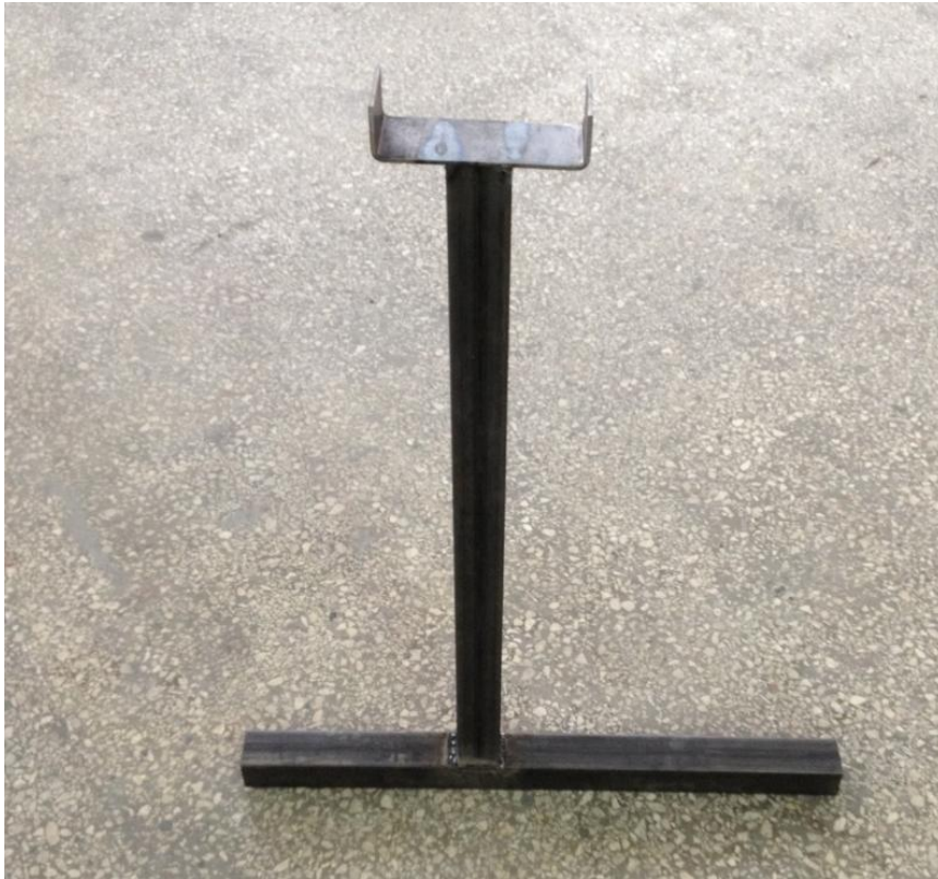
Εικόνα 13 Πρόοδος κατασκευής βάσης στήριξης με ηλεκτροσυγκολλημένα μέρη.
