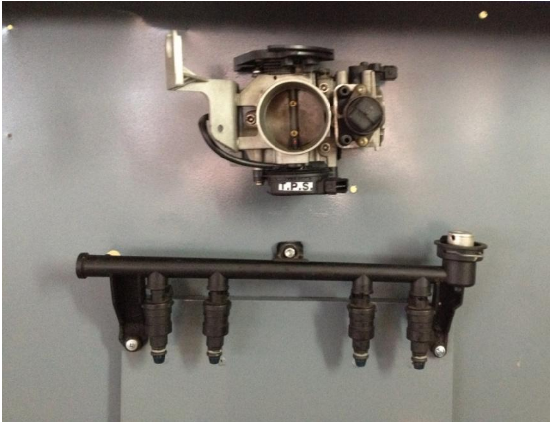
Εικόνα 45 Στην παραπάνω φωτογραφία φαίνονται τοποθετημένα η μπεκίερα και η πεταλούδα του γκαζιού.
