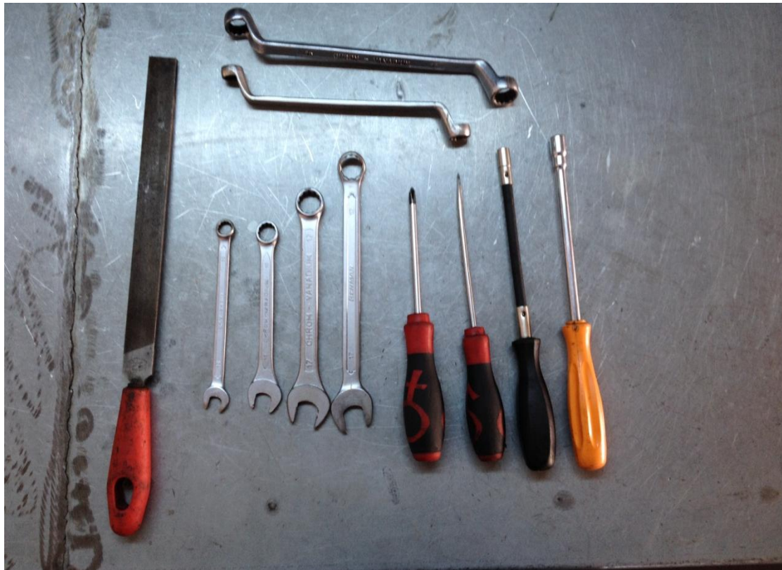
Εικόνα 46 Εργαλεία σύσφιξης και λίμα λείανσης. Με το κατσαβίδι με την σταυρωτή μύτη και αυτό με την ίσια συσφίξαμε τις λαμαρινόβιδες και τις ξυλόβιδες πάνω στο πλαίσιο υποδοχής για την στήριξη των εξαρτημάτων. Επίσης με τα πολύγωνα κατσαβίδια συσφίξαμε τους κολιέδες για τα σωληνάκια καυσίμου. Ακόμα με τα γερμανοπολύγωνα διαφόρων διαστάσεων βιδώσαμε τους τροχούς κύλισης και κάποιους αισθητήρες. Τέλος με την λίμα λείανσης αφαιρέσαμε το γρέζι μετά το άνοιγμα οπών.
