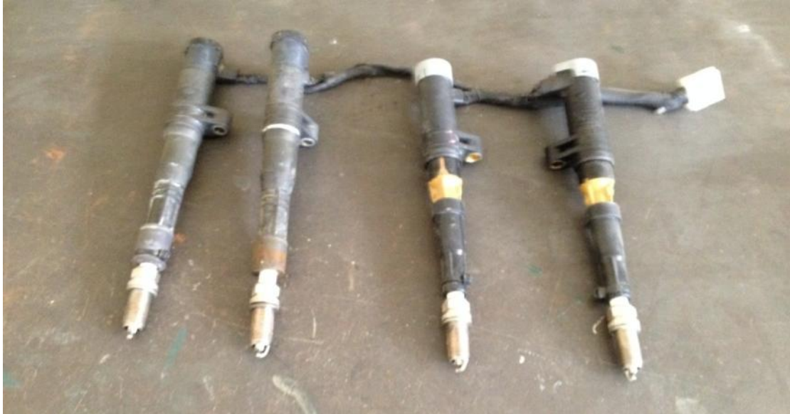
Εικόνα 39 Συνδεδεμένα τα μπουζοκαλώδια με τους σπινθηριστές.
