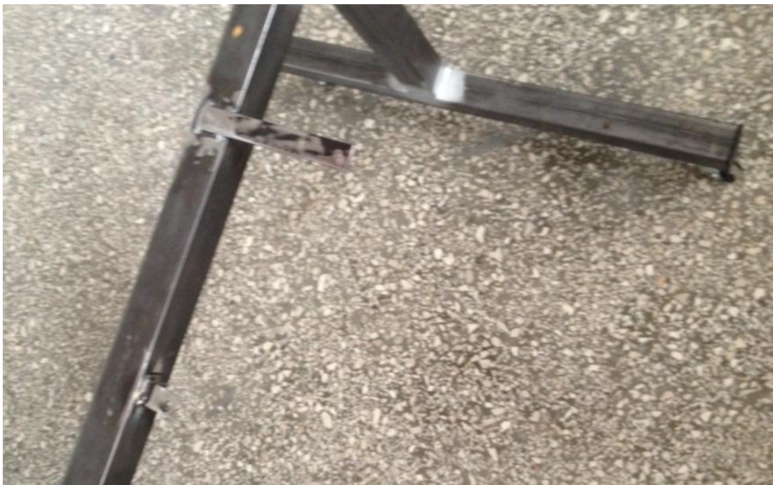
Εικόνα 20 Δημιουργία βάση συγκράτησης δοχείου βενζίνης σε κατάλληλη θέση εύκολης πρόσβασης από τον χρήστη.
