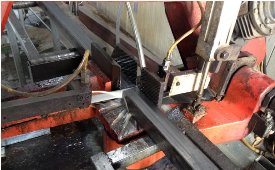
Εικόνα 8 Διαδικασία κοπής κοιλοδοκών όπου φαίνεται το μηχάνημα κοπής σε λειτουργία και το σύστημα ψεκασμού ψυκτικού υγρού.
