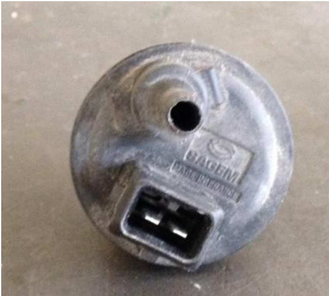
Εικόνα 30 Βαλβίδα αναθυμιάσεων ενεργού άνθρακα είναι μια ανεπιστροφη βαλβιδα η οποία είναι για τις αναθυμιασεις τις βενζινης.
