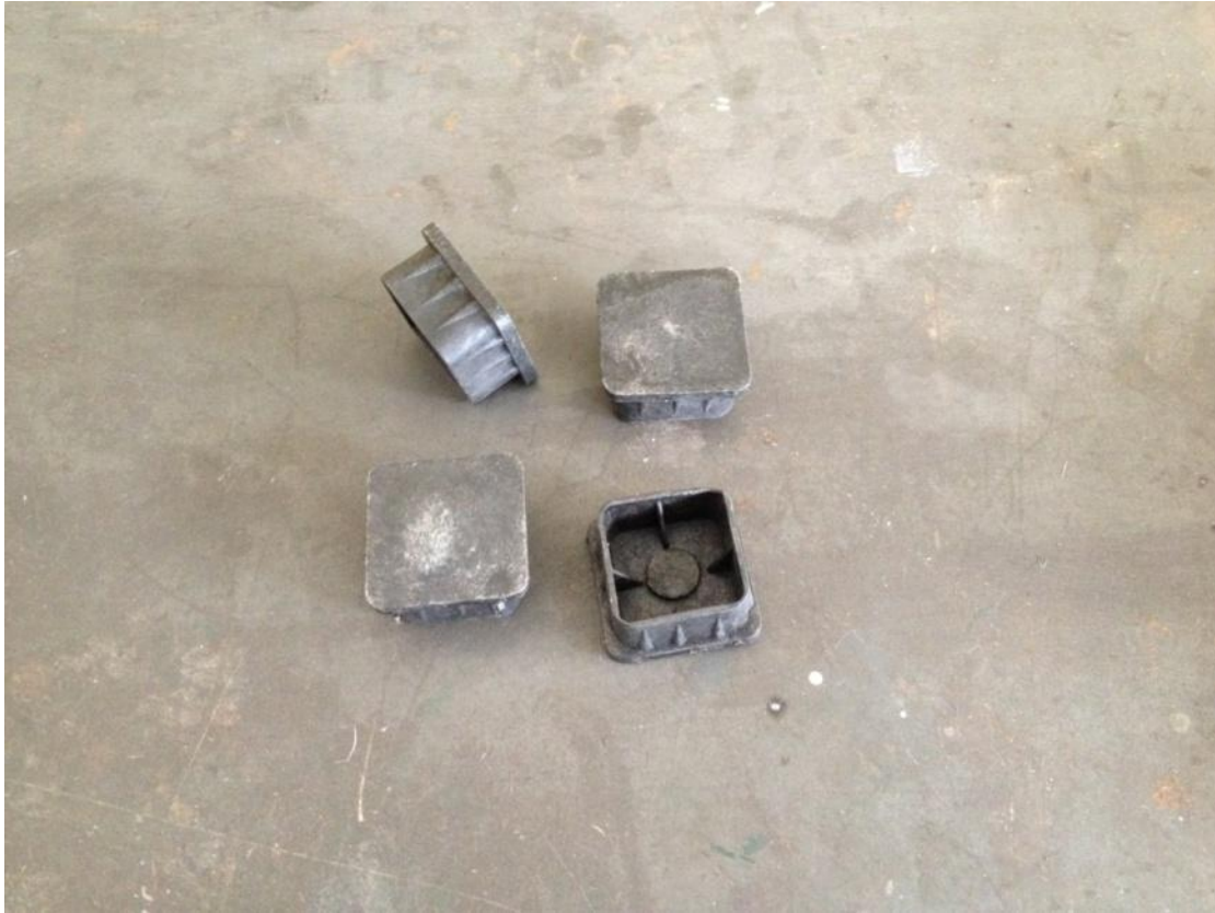
Εικόνα 6 Προστατευτικά καλύμματα κοιλοδοκών στήριξης για την προστασία των χρηστών και την βελτίωση της αισθητικής.
