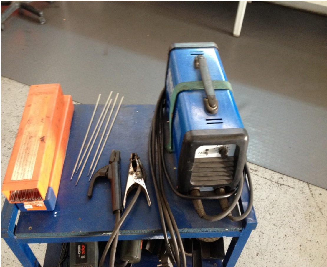
Εικόνα 51 Γεννήτρια ηλεκτροσυγκόλλησης. Χρησιμοποιήθηκε για την συγκόλληση στις βάσεις στήριξης της πλατφόρμας.
