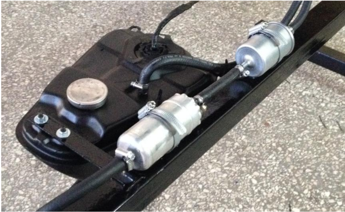
Εικόνα 61 Το ντεπόζιτο καυσίμου με την αντλία καυσίμου και το φίλτρο συνδεδεμένα σε σειρά.
