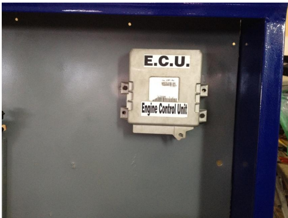
Εικόνα 42 Κεντρική μονάδα ελέγχου ECU (Εγκέφαλος) πάνω στην κατασκευή.
