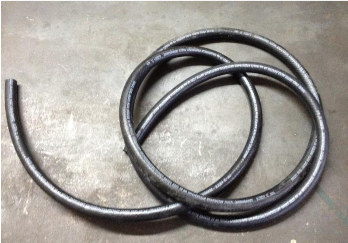
Εικόνα 59 Σωληνάκι εσωτερική διαμέτρου 10 χιλιοστών για την σύνδεση του ρεζερβουάρ στην αντλία καυσίμου.
