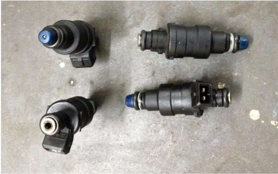
Εικόνα 34 Οι εγχυτήρες (μπεκ) στα συστήματα έγχυσης καυσίμου είναι τα εξαρτήματα μέσω των οποίων το καύσιμο διασκορπίζεται στο θάλαμο καύσης.
