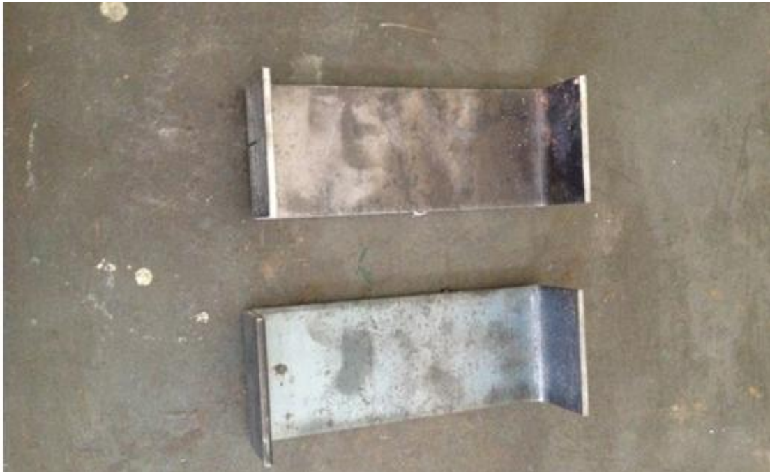
Εικόνα 12 Εξάρτημα για την προσαρμογή του πλαισίου με την βάση στήριξης, επεξεργάστηκε σε εξειδικευμένο μηχανουργείο που διαθέτει υδραυλική στράτζα.
