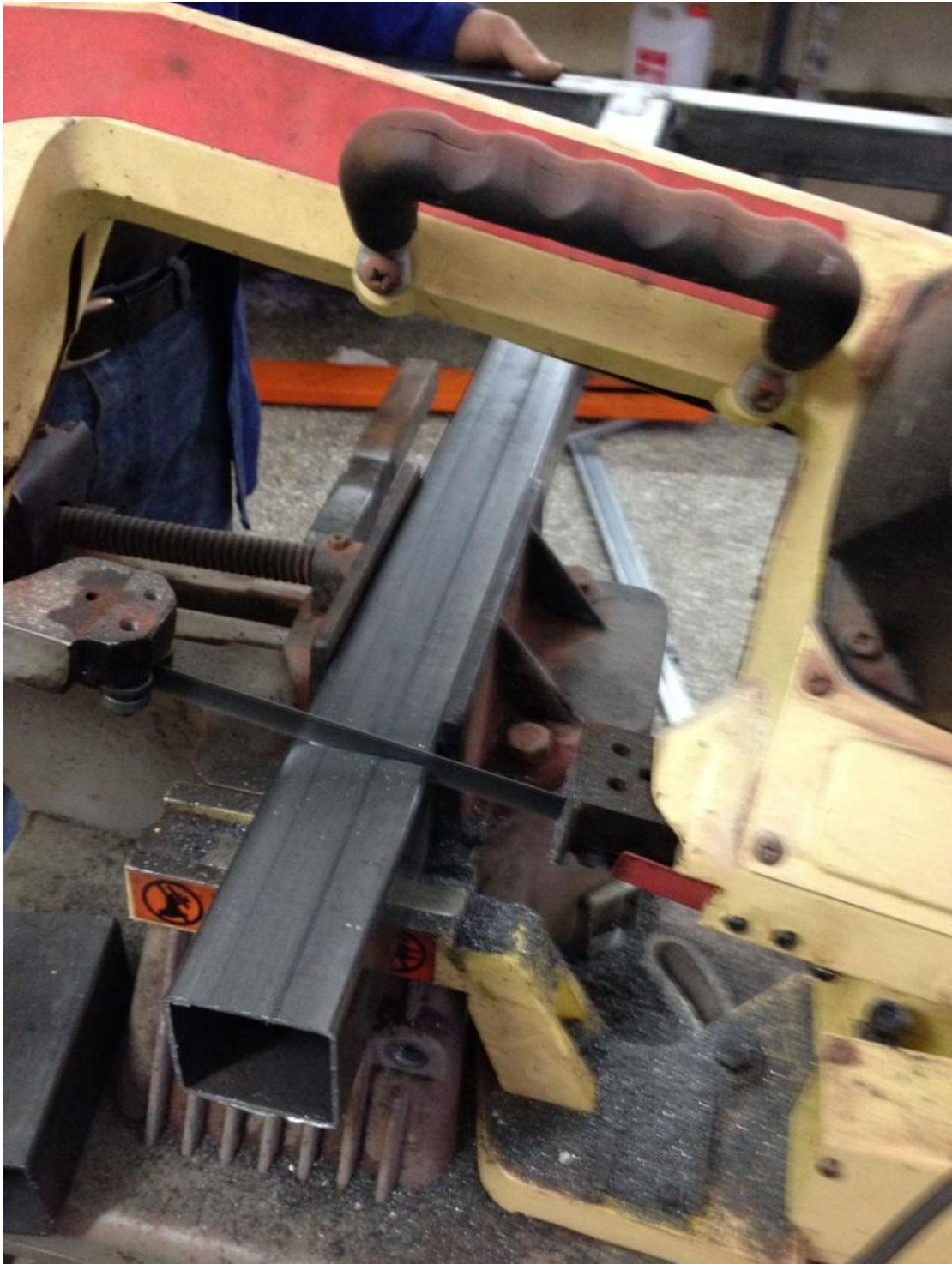
Εικόνα 9 Στην παραπάνω φωτογραφία διακρίνεται η διαδικασία κοπής κοιλοδοκών σε άλλου τύπου μηχάνημα κοπής χωρίς ψυκτικό υγρό.
