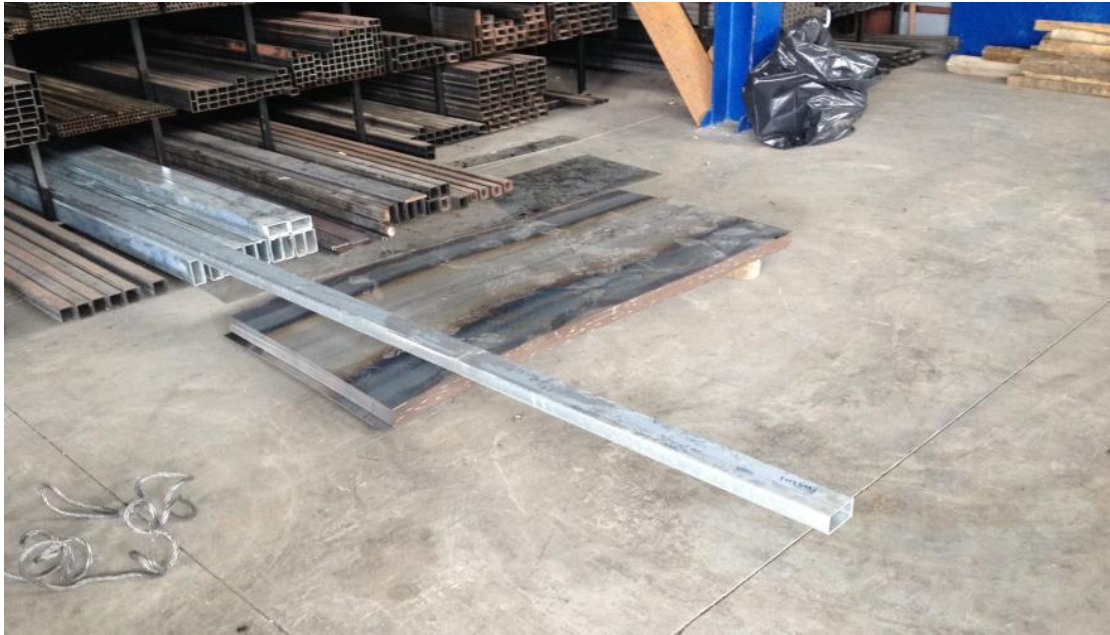
Εικόνα 2 Στην παραπάνω φωτογραφία φαίνεται η γενική όψη του ορθογώνιου κοίλοδοκού (γαλβανιζέ) μήκους 6 μέτρων.
