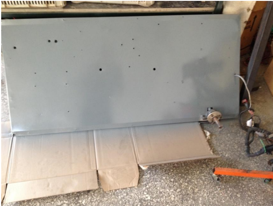
Εικόνα 23 Στην παραπάνω φωτογραφία φαίνεται ο πίνακας τοποθέτησης εξαρτημάτων ψεκασμού και ανάφλεξης στο στάδιο βαφής.
