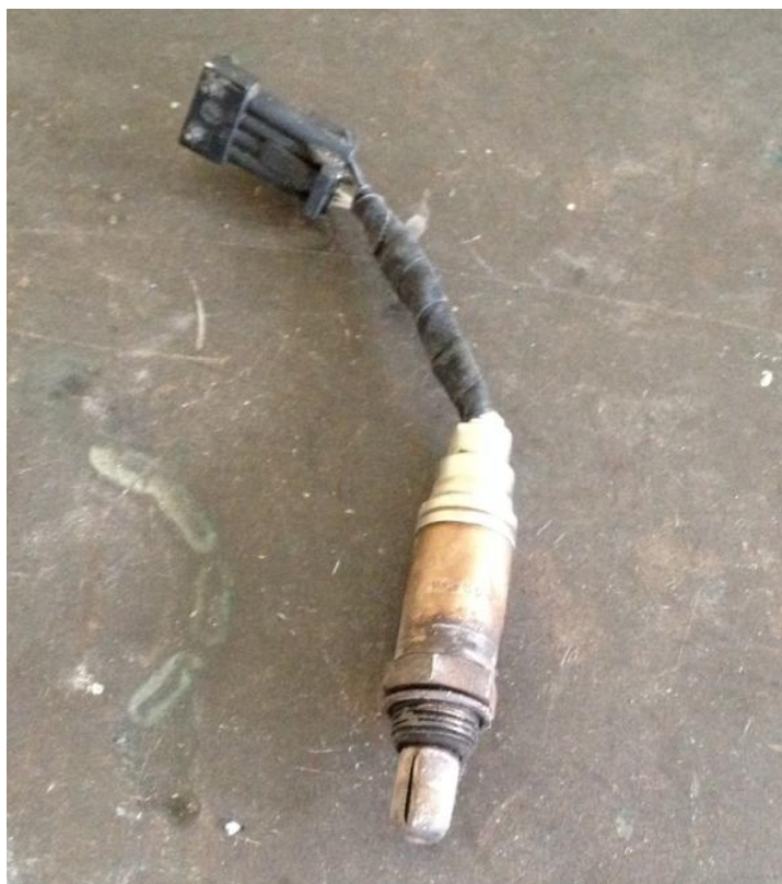
Εικόνα 29 Ο αισθητήρας λ (ή αισθητήρας οξυγόνου) είναι ηλεκτρονική διάταξη που προσδιορίζει την περιεκτικότητα σε οξυγόνο ενός αερίου ή υγρού σε εξέταση.
