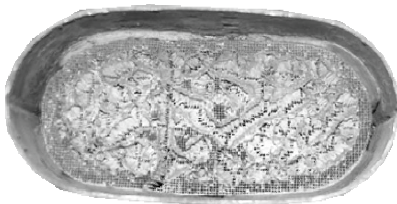
Βλάβη καταλύτη από καμένο πολλαπλασιαστή.
