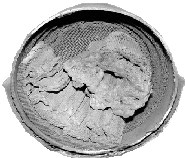
Βλάβη καταλύτη από νοθευμένο καύσιμο.
