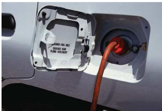
Εικόνα 18- Η πρίζα με την οποία ένα PHEV συνδέεται με εξωτερική πηγή ηλεκτρικού
