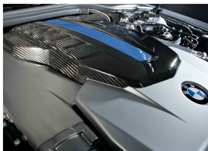
Ο V8 κινητήρας καύσης τύπου "dual-mode" του εμπορικού μοντέλου Sedan 745h της BMW.
