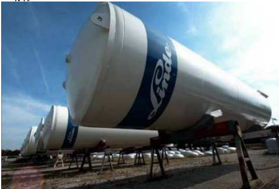
Εικόνα 5- Μεγάλες δεξαμενές συμπιεσμένου υδρογόνου 5-7 MPa για βιομηχανικές εφαρμογές
