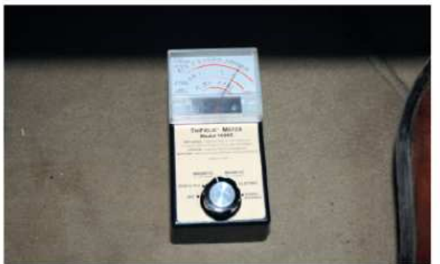
Μέτρηση στο πάτωμα του υβριδικού οχήματος, πλευρά συνοδηγού, με τον διακόπτη ON και τον κινητήρα σε λειτουργία, το όχημα σε κίνηση. Τιμή: 50 milligauss (στην κλίμακα 0-100 milligauss)
