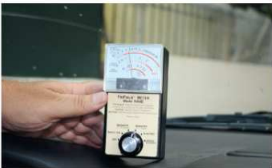
Μέτρηση κοντά στο ταμπλό του υβριδικού οχήματος με τον διακόπτη ON και τον κινητήρα σβηστό. Τιμή: 1,3 milligauss (στην κλίμακα 0-3 milligauss)
