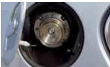
Βαλβίδα ασφαλείας σε ντεπόζιτο υγρού υδρογόνου.
