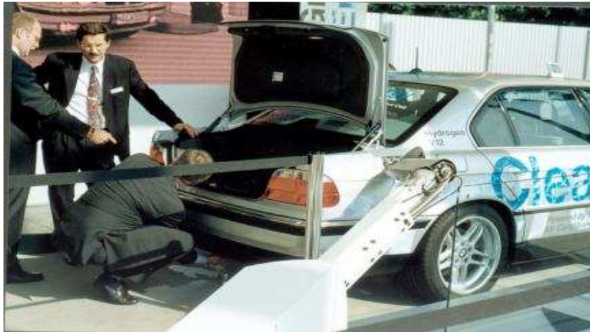
Σωλήνας ανεφοδιασμού με υγρό υδρογόνο στη πίστα δοκιμών της BMW.
