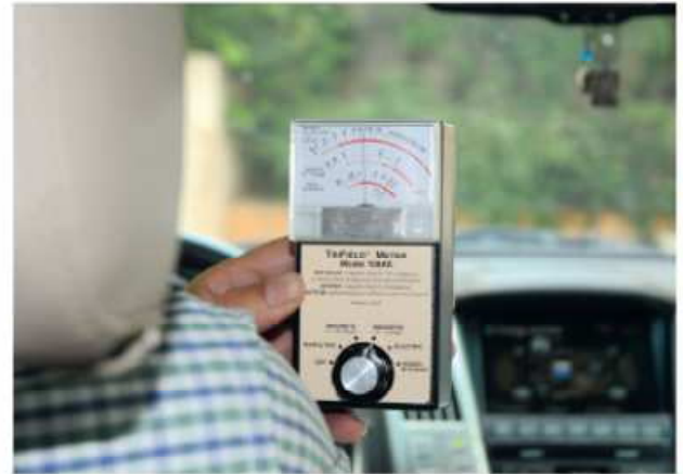
Μέτρηση κοντά στον οδηγό του υβριδικού οχήματος με τον διακόπτη ON και τον κινητήρα σε λειτουργία. Τιμή: 1,5 milligauss (στην κλίμακα 0-3 milligauss)
