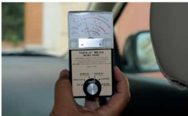
Μέτρηση κοντά στον συνοδηγό του υβριδικού οχήματος με τον διακόπτη ON και τον κινητήρα σε λειτουργία. Τιμή: 1,2 milligauss (στην κλίμακα 0-3 milligauss)
