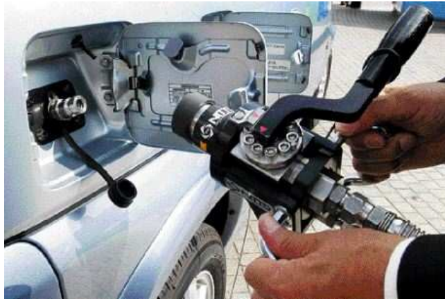
Σωλήνας πλήρωσης για ανεφοδιασμό με υγρό υδρογόνο.
