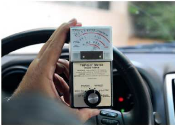
Μέτρηση κοντά στο τιμόνι του υβριδικού οχήματος με τον διακόπτη ON και τον κινητήρα σε λειτουργία. Τιμή: 2,8 milligauss (στην κλίμακα 0-100 milligauss)
