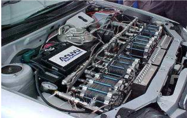
Μηχανή αυτοκίνητου τροφοδοτούμενη από συστοιχία κυψελών καυσίμου PEMFC σε σειρά.
