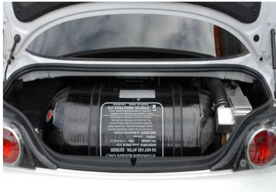
Το υπερόζυτο αποθήκευσης υδρογόνου του Mazda RX-8 Hydrogen RE.
