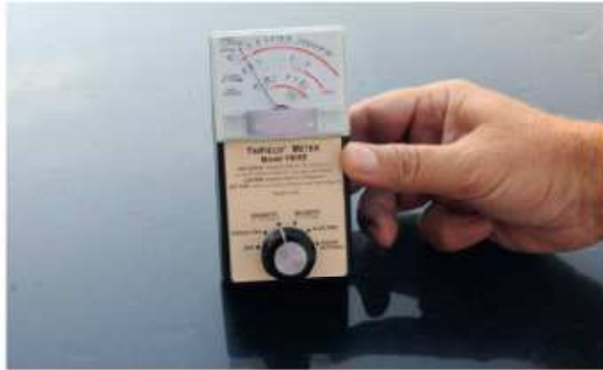
Μέτρηση επάνω στο καπό του υβριδικού οχήματος, με τον διακόπτη ON και τον κινητήρα σβηστό, το όχημα σε στάση Τιμή: 2 milligauss (στην κλίμακα 0-100 milligauss)
