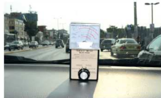
Μέτρηση κοντά στο ταμπλό του υβριδικού οχήματος με τον διακόπτη ON και τον κινητήρα σε λειτουργία, το όχημα σε κίνηση. Τιμή: 18 milligauss (στην κλίμακα 0-100 milligauss)
