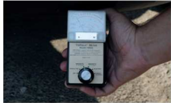
Μέτρηση στο πίσω μέρος των επιβατών του υβριδικού οχήματος με τον διακόπτη ON και τον κινητήρα σε λειτουργία. Τιμή: 1,2 milligauss (στην κλίμακα 0-3 milligauss)
