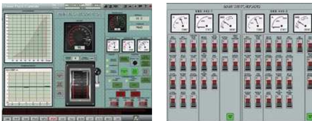
Εικόνα 8: Έλεγχος κύριας μηχανής πλοίου γενικού φορτίου (αριστερά) και κύριος πίνακας διακοπών (δεξιά)
