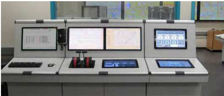
Εικόνα 13: Προσομοιωτής μηχανοστασίου με οθόνες αφής, Κολλέγιο Georgian, Καναδάς
