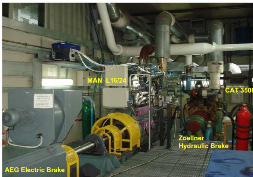
Εικόνα 16: Οι δύο τετράχρονοι κινητήρες Diesel με τα αντίστοιχα δυναμόμετρά τους
