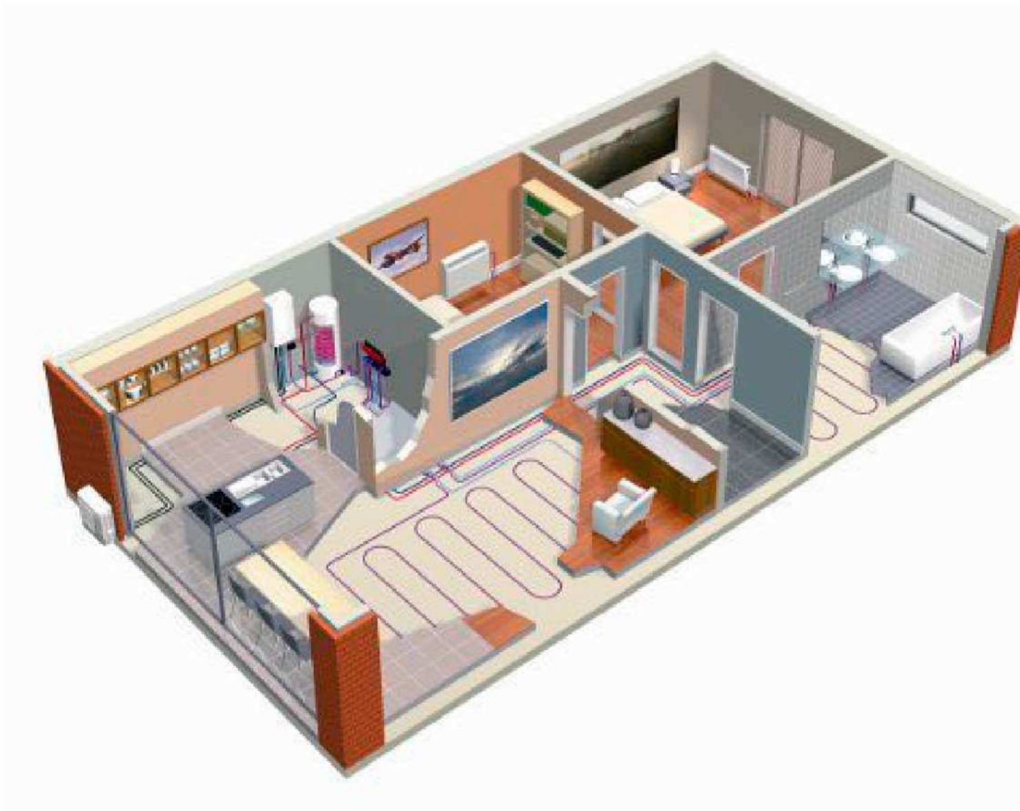
Σχήμα 2.3α: Εικόνα μορφής θέρμανσης δαπέδου σε κατοικία
