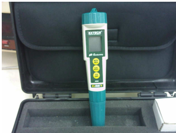
Εικόνα 10: Συσσκευή μέτρησης PH και ηλεκτρικής αγωγιμότητας
