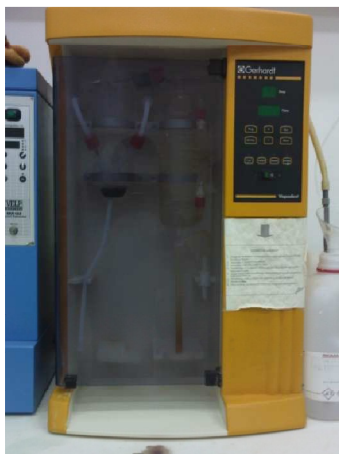
Εικόνα 14: Σύστημα απόσταξης VaroDest
