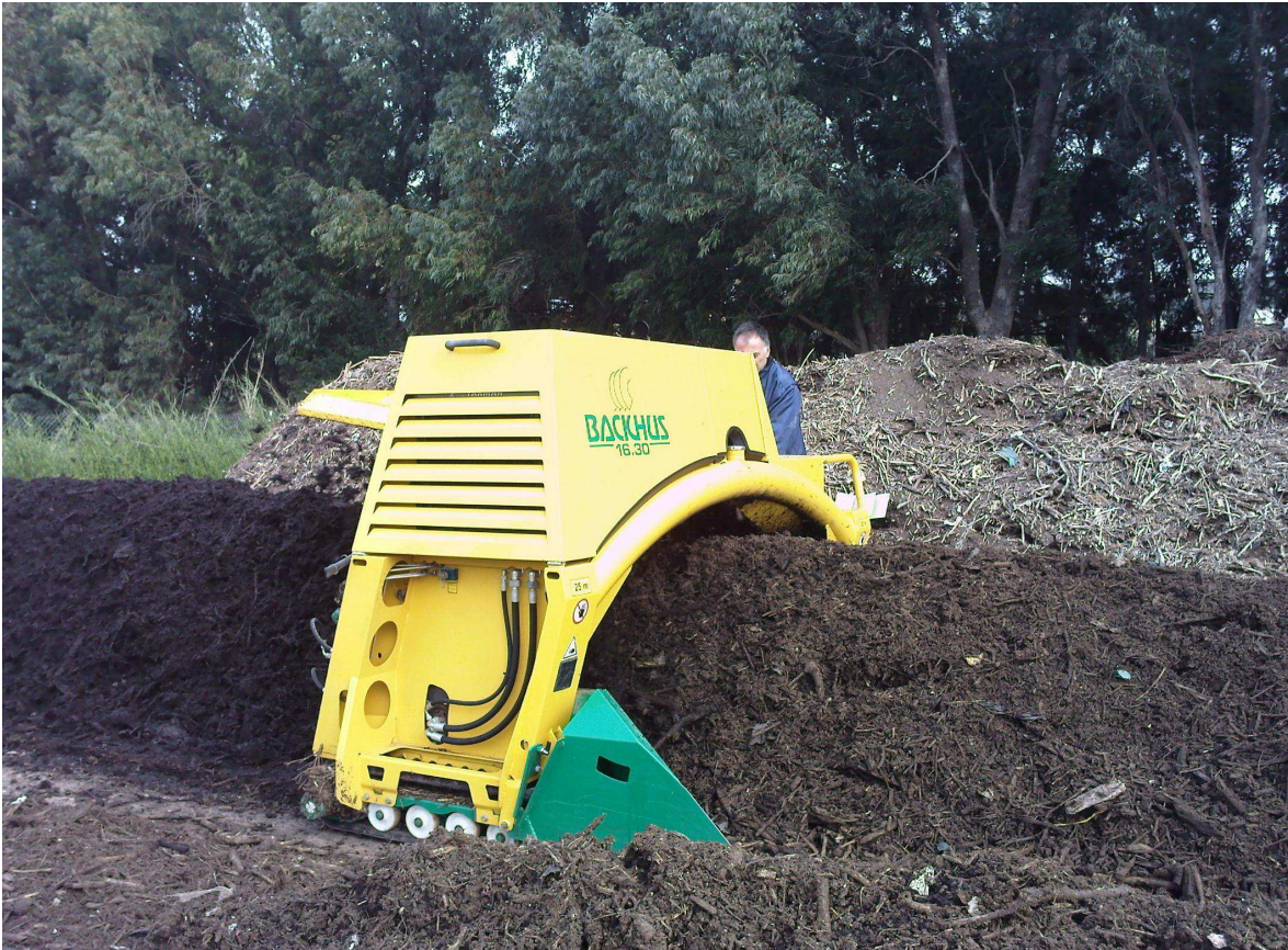
Εικόνες 25 & 26: Αυτοκινούμενος αναστροφέας κομποστοποίησης
