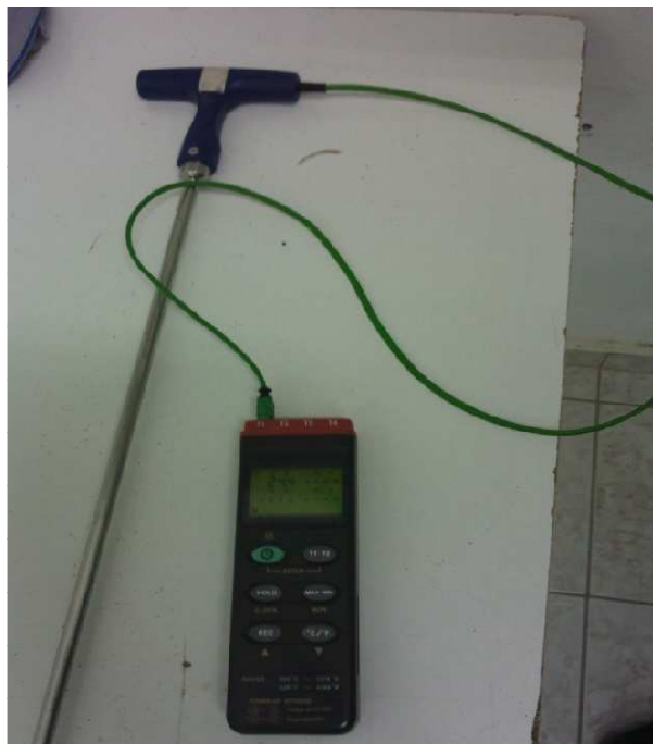
Εικόνα 6: Ηλεκτρονικό θερμόμετρο κλασσικού τύπου συνδεδεμένο με ράβδο με αισθητήρα για τη μέτρηση της θερμοκρασίας
