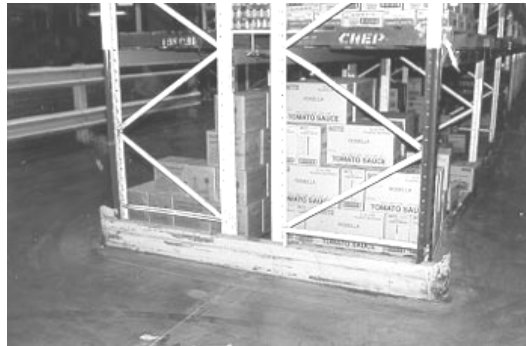
Εικόνα 3. Προστασία με στηθαίο, ραφιών βιομηχανικού τύπου.
