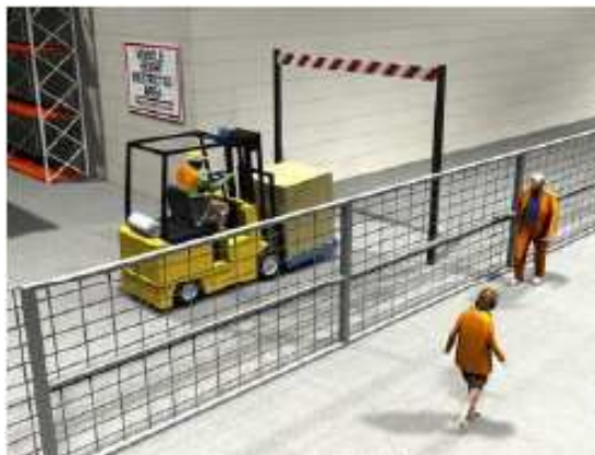
Εικόνα 6. Παράδειγμα Διαχωρισμού κίνησης πεζών – οχημάτων . Ένδειξη μέγιστου ύψους ελεύθερης διάβασης.
