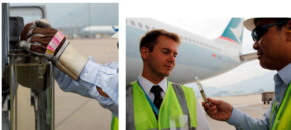
Σχήμα 28. Δειγματοληπτικός έλεγχος. Αριστερά ο ανεφοδιαστής έχει βγάλει στη γυάλα έλεγχου καύσιμο και με το shell water detector κάνει τον έλεγχο τραβώντας 5ml καυσίμου. Δεξιά δείχνει στον μηχανικό της αεροπορικής εταιρείας τα αποτελέσματα του ελέγχου
