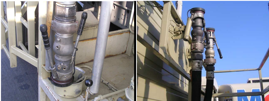
Σχήμα 19. Το σύστημα interlock με τα ακροσωλήνια σύνδεσης στο αεροσκάφος
