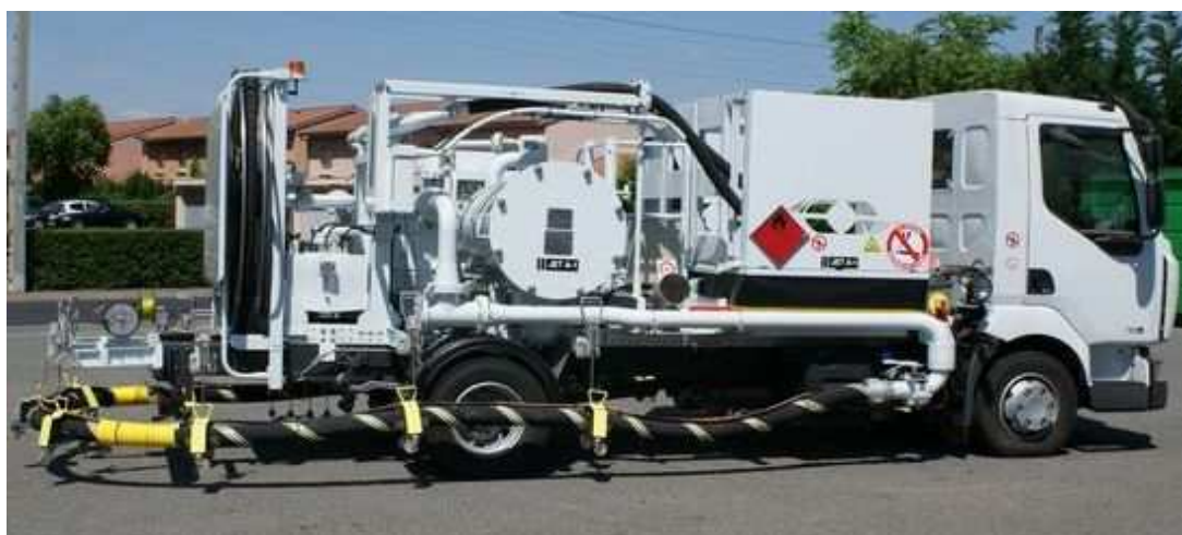
Σχήμα 17. Ανεφοδιαστικά οχήματα. Πάνω refueller. Κάτω hydrant dispenser
