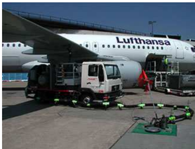
Σχήμα 21. Σύστημα hydrant. Διακρίνεται η ονομασία του καυσίμου στο καπάκι, η σύνδεση με το dispenser, το καλώδιο γείωσης και η σύνδεση με το αεροσκάφος
