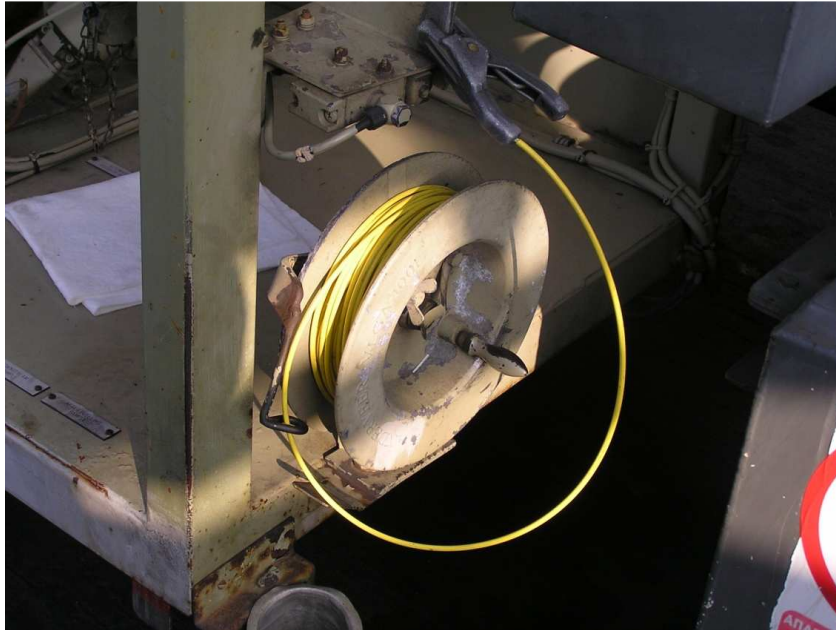
Σχήμα 22. Σύστημα γεφύρωσης βυτιοφόρου – αεροσκάφους
