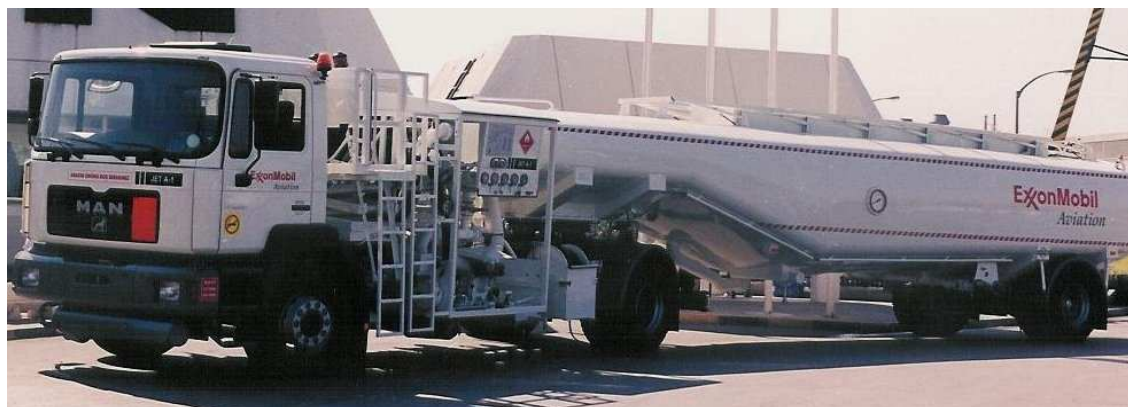
Σχήμα 5. Οχημα ανεφοδιασμού αεροσκαφών (REFUELLER)
