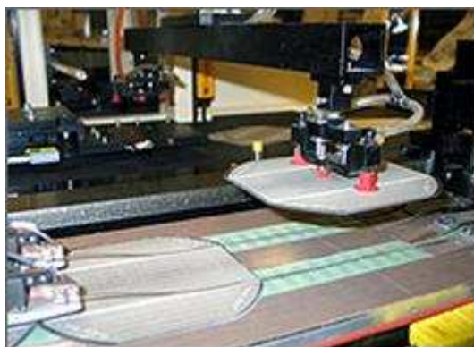
Φωτοβολταϊκά στοιχεία κατά την συναρμολόγηση του πλαισίου
