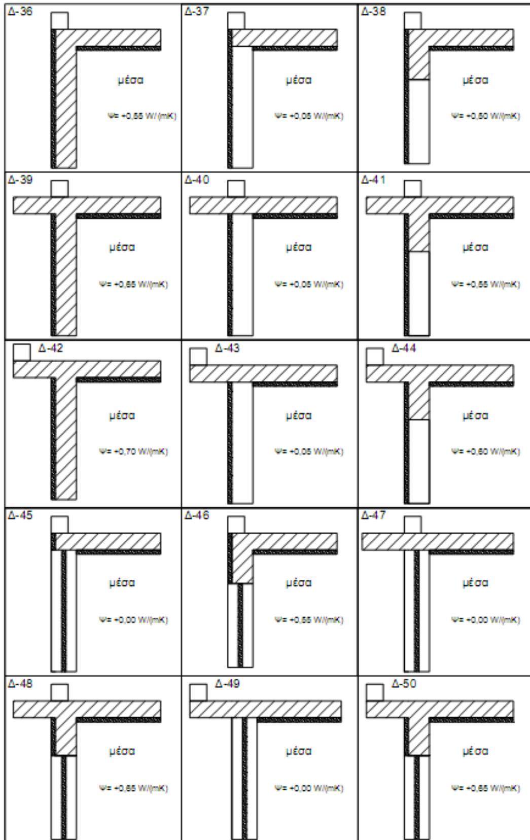
Σχήμα 1.7: Θερμογέφυρες δώματος/οροφής σε προεξοχή
