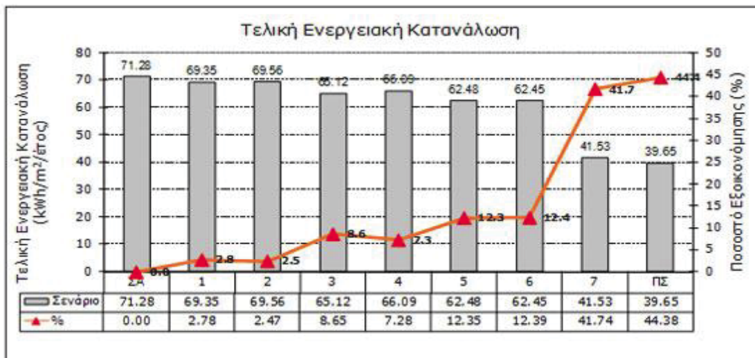
Σχήμα 13-Γράφημα εξοικονόμησης ενέργειας(όπου ΣΑ: Σενάριο Αναφοράς και ΠΣ: Προτεινόμενο Σενάριο)
