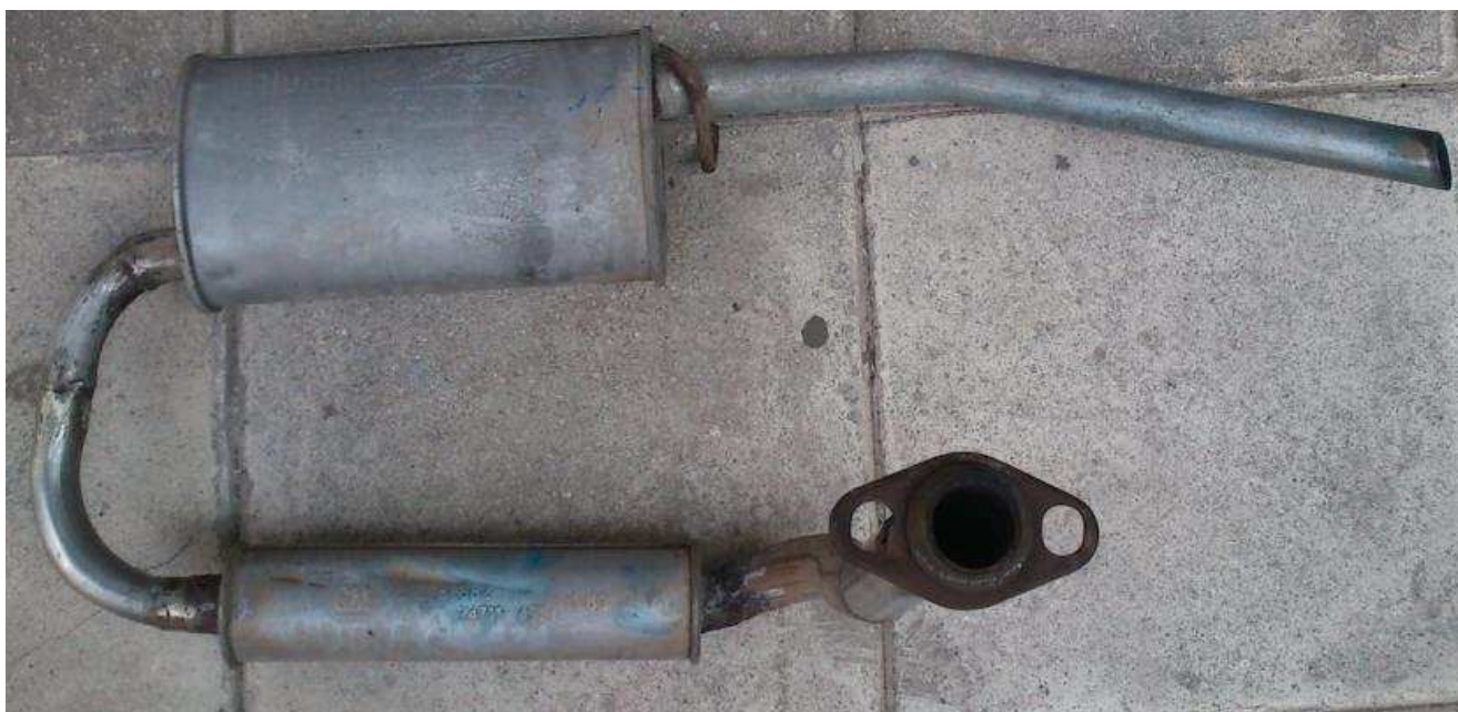
σύστημα εξαγωγής καυσαερίων
