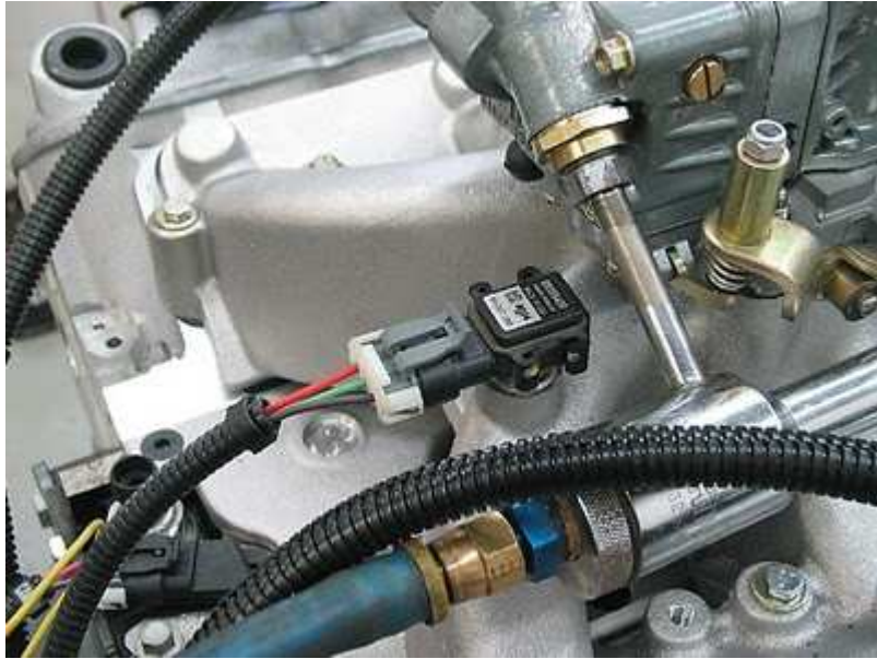
Σχήμα 3. Τοποθέτηση του αισθητήρα στην εισαγωγή αέρα του κινητήρα .
