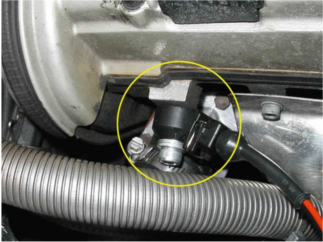
Σχήμα 3 . Διακρίνεται η βίδα στερέωσης του αισθητήρα
