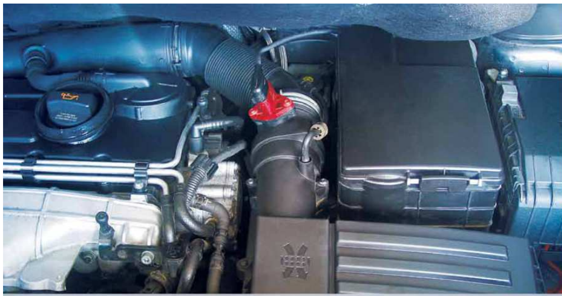
Σχήμα 7. Τοποθέτηση αισθητήρα στην εισαγωγή
