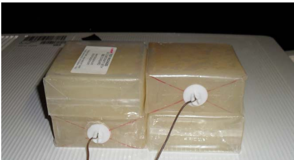
21.μικρό φορτίο σε θερμοκρασία περιβάλλοντος πριν την τοποθέτηση
