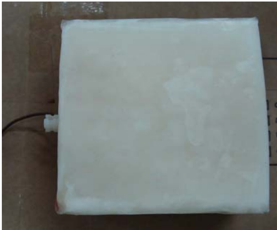
15.Πακέτο-Μ με θερμοζεύγος (πάνω όψη)
