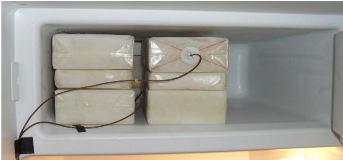
21.Φόρτωση κατάψυξης πριν την τοποθέτηση του μικρού φορτίου
