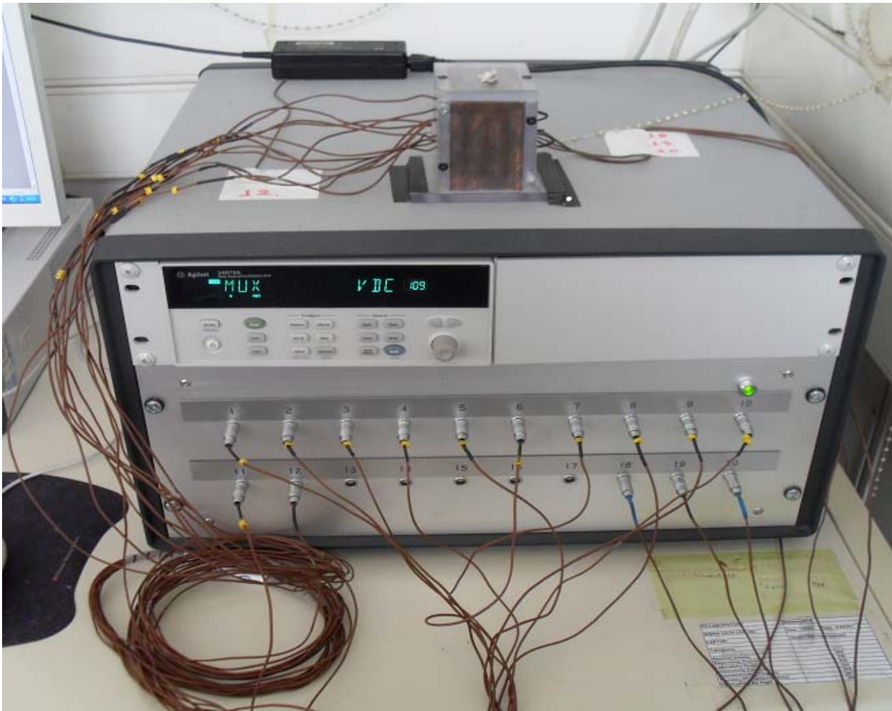
9. Calibrator με ομάδα θερμοζευγών εν ώρα calibration
