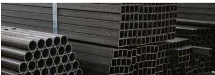
Εικόνα: ράβδοι χάλυβα ή αλλιώς κοιλοδοκοί σε διάφορα γεωμετρικά σχήματα
