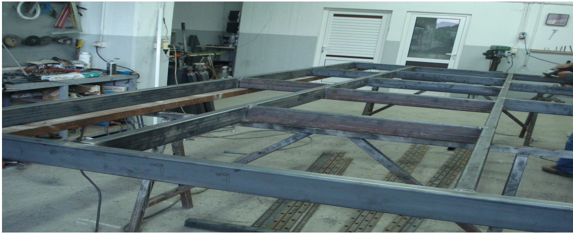
Εικόνα 38:ΣΥΓΚΟΛΗΣΗ ΠΛΑΙΣΙΟΥ ΚΑΙ ΤΡΟΧΙΣΜΑ ΚΟΛΛΗΣΕΩΝ
