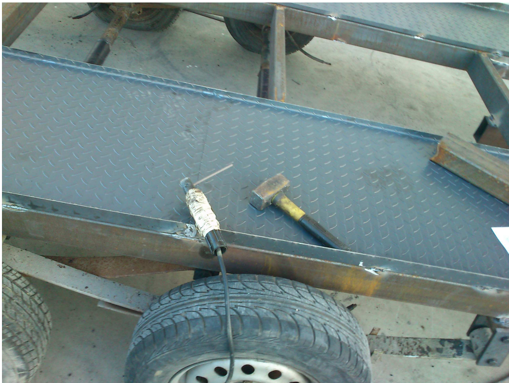
Εικόνα 84: ΕΠΙΣΤΡΩΣΗ ΤΟΥ ΠΛΑΙΣΙΟΥ ΚΑΙ ΤΩΝ ΜΠΑΡΩΝ ΜΕ ΛΑΜΑΡΙΝΑ ΚΑΙ ΣΥΓΚΟΛΛΗΣΗ.
