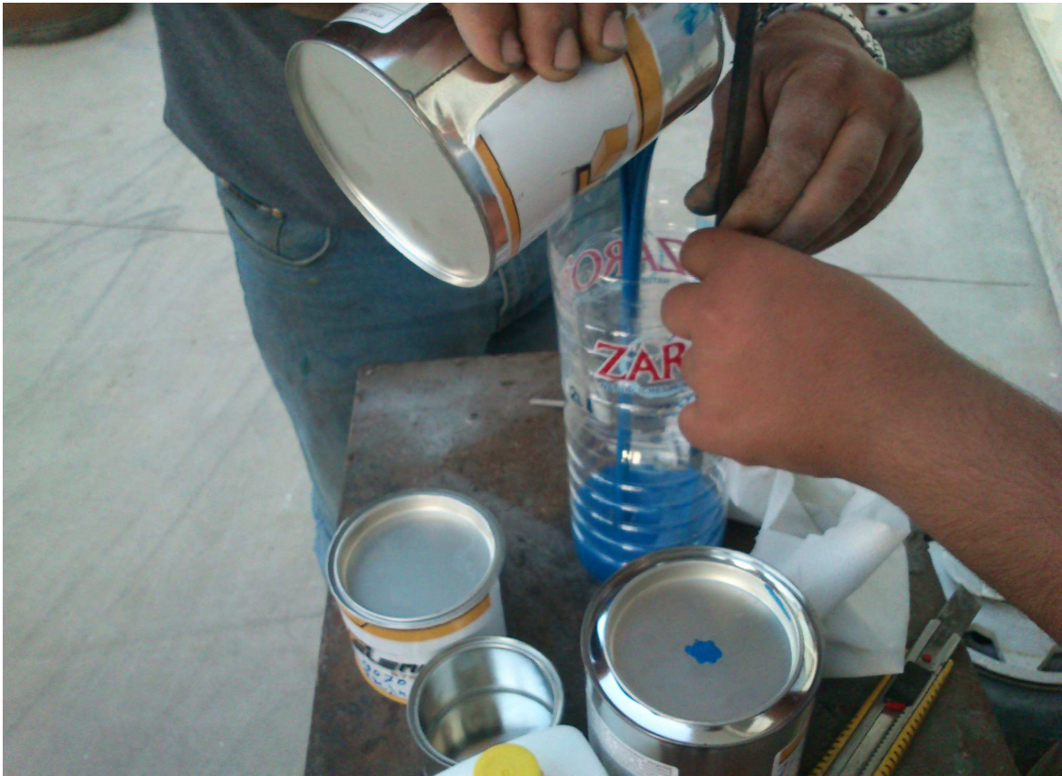
Εικόνα 91:ΑΝΑΜΙΞΗ ΧΡΩΜΑΤΟΣ ΔΙΑΛΥΤΙΚΟΥ ΚΑΙ ΣΚΛΗΡΥΝΤΗ ΓΙΑ ΤΕΛΕΙΟΠΟΙΗΣΗ ΤΟΥ ΧΡΩΜΑΤΟΣ ΒΑΦΗΣ.
