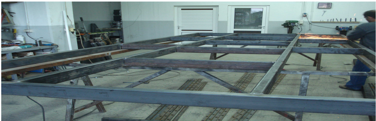
Εικόνα 39:ΣΥΓΚΟΛΗΣΗ ΠΛΑΙΣΙΟΥ ΚΑΙ ΤΡΟΧΙΣΜΑ ΚΟΛΛΗΣΕΩΝ
