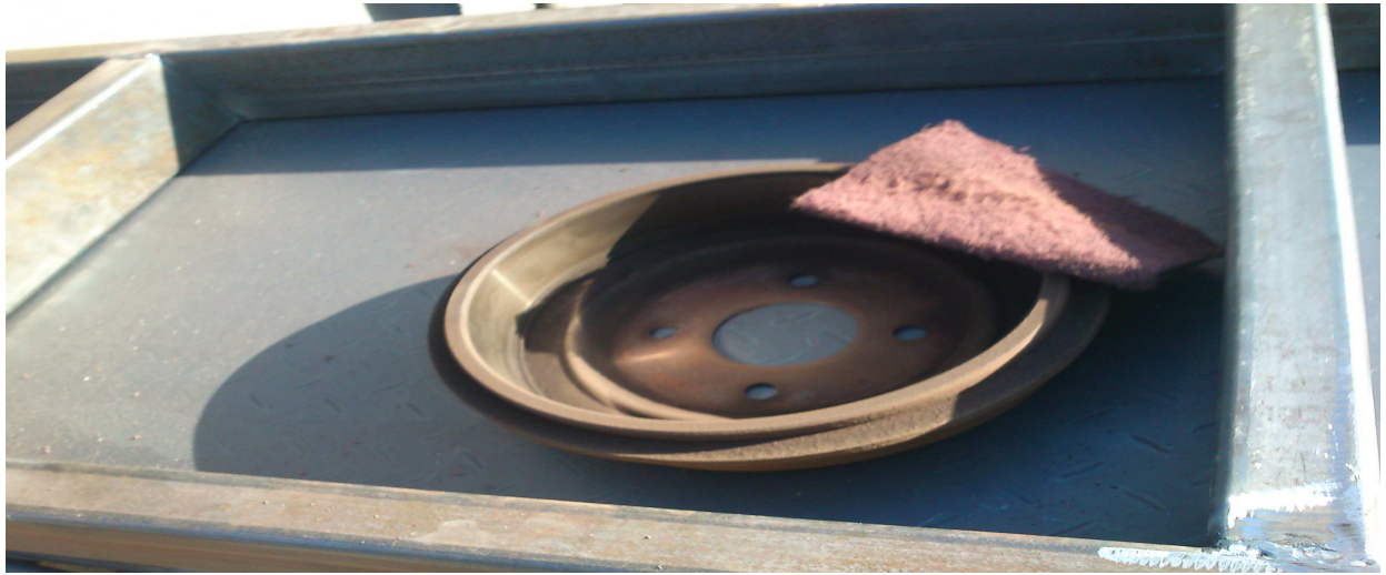
Εικόνα 88: ΤΡΙΨΙΜΟ ΤΑΜΠΟΥΡΩΝ ΚΑΙ ΚΑΘΑΡΙΣΜΑ.
