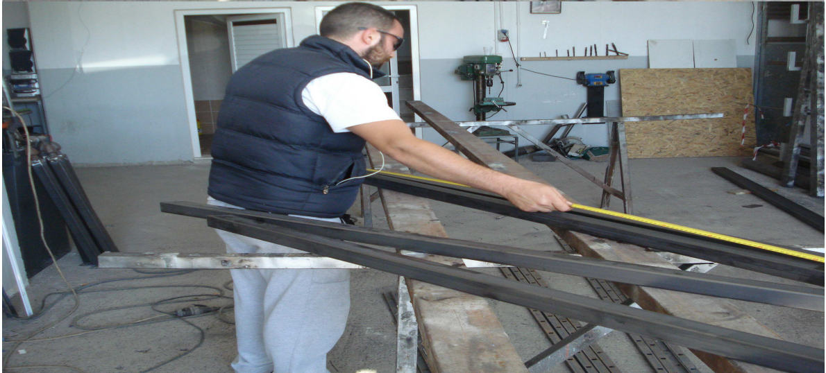
Εικόνα 76: ΦΑΛΤΣΟ ΚΟΨΙΜΟ ΚΑΙ ΔΙΑΣΤΑΣΙΟΛΟΓΗΣΗ ΣΥΜΦΩΝΑ ΜΕ ΤΟ ΣΧΕΔΙΟ ΜΑΣ ΚΟΙΛΟΔΟΚΩΝ ΓΙΑ ΔΗΜΙΟΥΡΓΙΑ ΜΠΑΡΩΝ ΚΑΙ ΚΑΓΚΕΛΟΥ.
