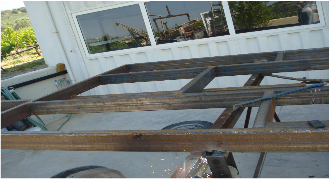
Εικόνα 62: ΣΥΓΚΟΛΛΗΣΗ ΒΟΗΘΗΤΙΚΩΝ ΜΕΡΩΝ ΓΙΑ ΠΡΟΣΑΡΜΟΓΗ ΣΟΥΣΤΩΝ
