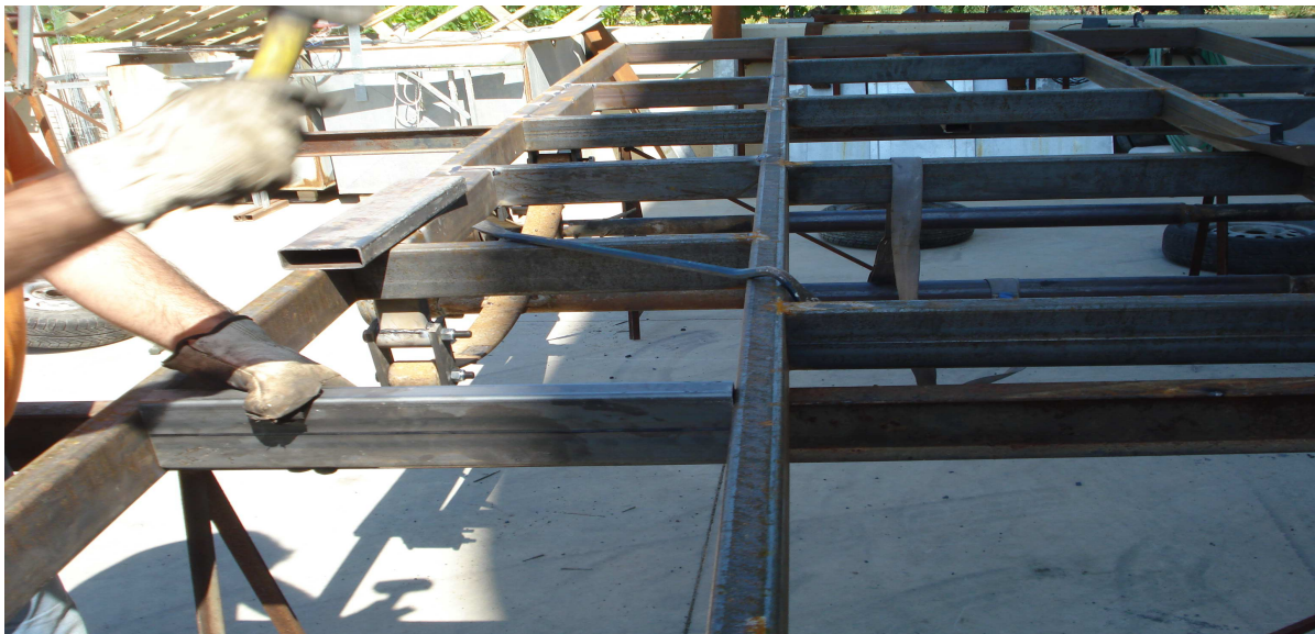
Εικόνα 46:ΣΥΓΚΟΛΛΗΣΗ ΠΛΑΙΣΙΟΥ ΚΑΙ ΣΥΜΠΛΗΡΩΜΑ ΚΟΛΛΗΣΕΩΝ
