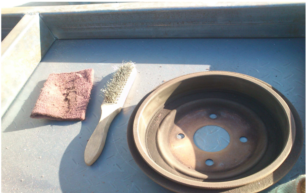
Εικόνα 87: ΤΡΙΨΙΜΟ ΤΑΜΠΟΥΡΩΝ ΚΑΙ ΚΑΘΑΡΙΣΜΑ.
