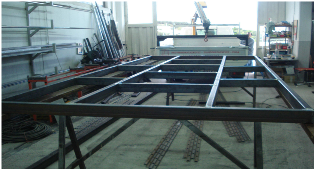
Εικόνα 55: ΑΝΑΠΟΔΟΓΥΡΙΣΜΑ ΠΛΑΙΣΙΟΥ ΓΙΑ ΠΡΟΣΑΡΜΟΓΗ ΑΞΟΝΩΝ
