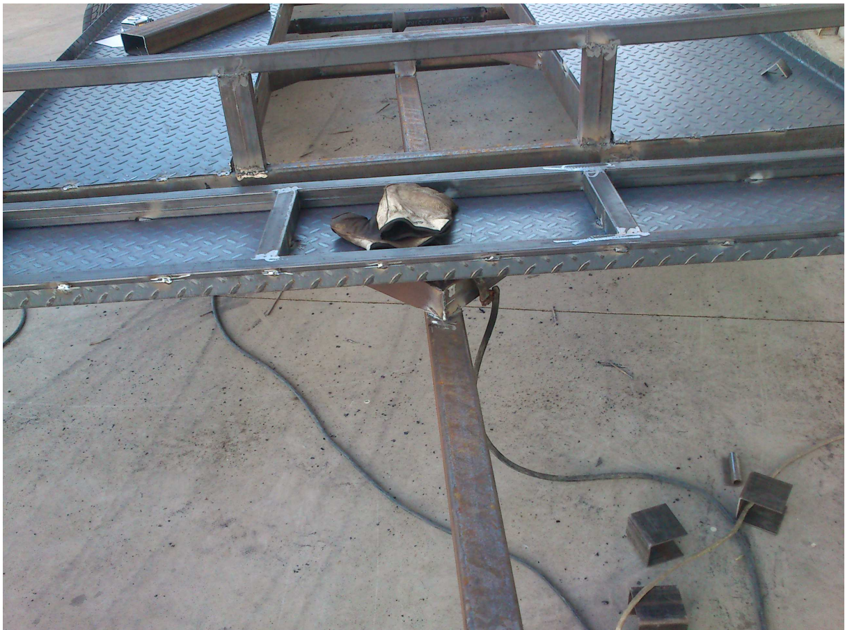
Εικόνα 82 : ΕΠΙΣΤΡΩΣΗ ΤΟΥ ΠΛΑΙΣΙΟΥ ΚΑΙ ΤΩΝ ΜΠΑΡΩΝ ΜΕ ΛΑΜΑΡΙΝΑ ΚΑΙ ΣΥΓΚΟΛΛΗΣΗ.
