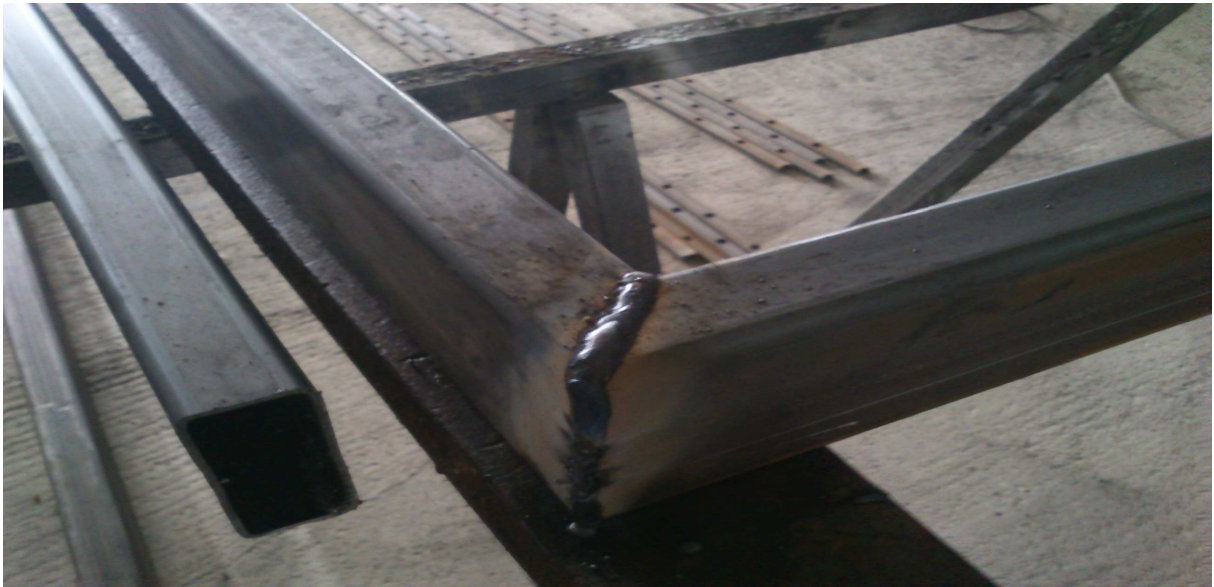
Εικόνα 32:ΣΥΝΑΡΜΟΛΟΓΗΣΗ ΚΑΙ ΠΟΝΤΑΡΙΣΜΑ ΠΛΑΙΣΙΟΥ
