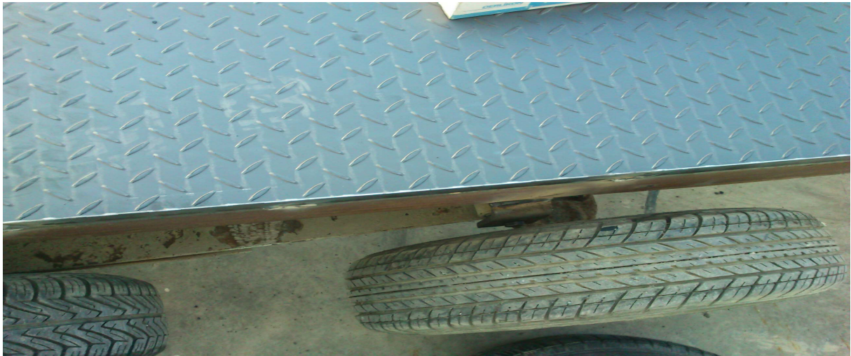
Εικόνα 81.: : ΕΠΙΣΤΡΩΣΗ ΤΟΥ ΠΛΑΙΣΙΟΥ ΜΑΣ ΜΕ ΛΑΜΑΡΙΝΑ ΚΑΙ ΣΥΓΚΟΛΛΗΣΗ ΑΥΤΗΣ.
