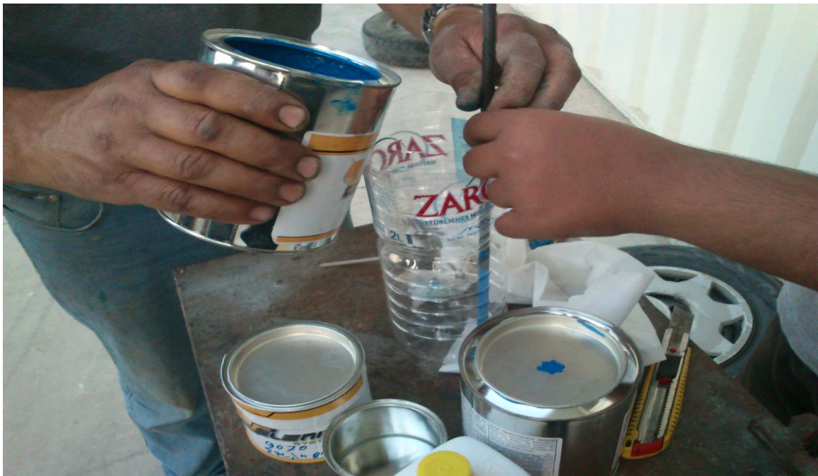
Εικόνα 92:ΟΜΟΓΕΝΟΠΟΙΗΣΗ ΚΑΙ ΑΝΑΚΑΤΕΜΑ ΧΡΩΜΑΤΟΣ.
