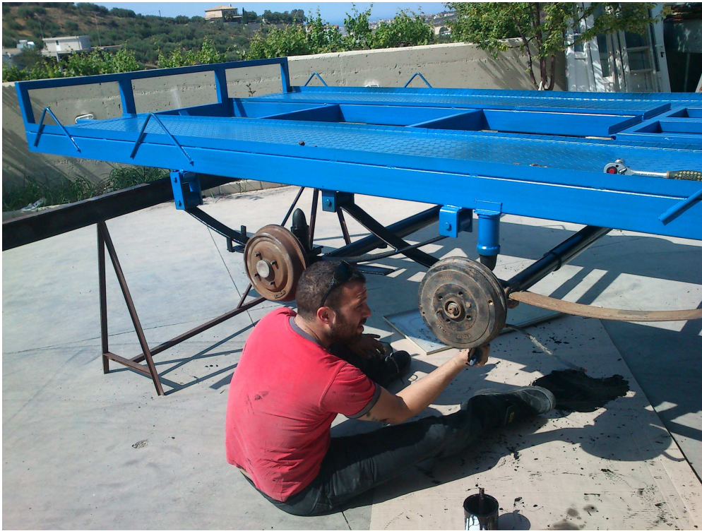
Εικόνα 97: ΒΑΦΗ ΑΞΟΝΩΝ ΚΑΙ ΣΟΥΣΤΩΝ ΜΕ ΠΙΝΕΛΟ ΚΑΙ ΜΑΥΡΟ ΧΡΩΜΑ ΥΨΗΛΩΝ ΘΕΡΜΟΚΡΑΣΙΩΝ.
