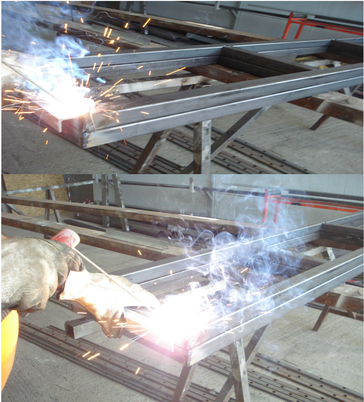
Εικόνα 77:ΣΥΓΚΟΛΛΗΣΗ ΚΑΙ ΔΗΜΙΟΥΡΓΙΑ ΜΠΑΡΩΝ ΚΑΙ ΚΑΓΚΕΛΟΥ.
