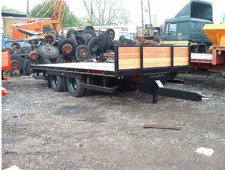
Εικόνα 4: Στενά συνδεδεμένο τρέιλερ. Παρατηρείστε την άκαμπτη ράβδο έλξης στο εμπρόσθιο τμήμα.
