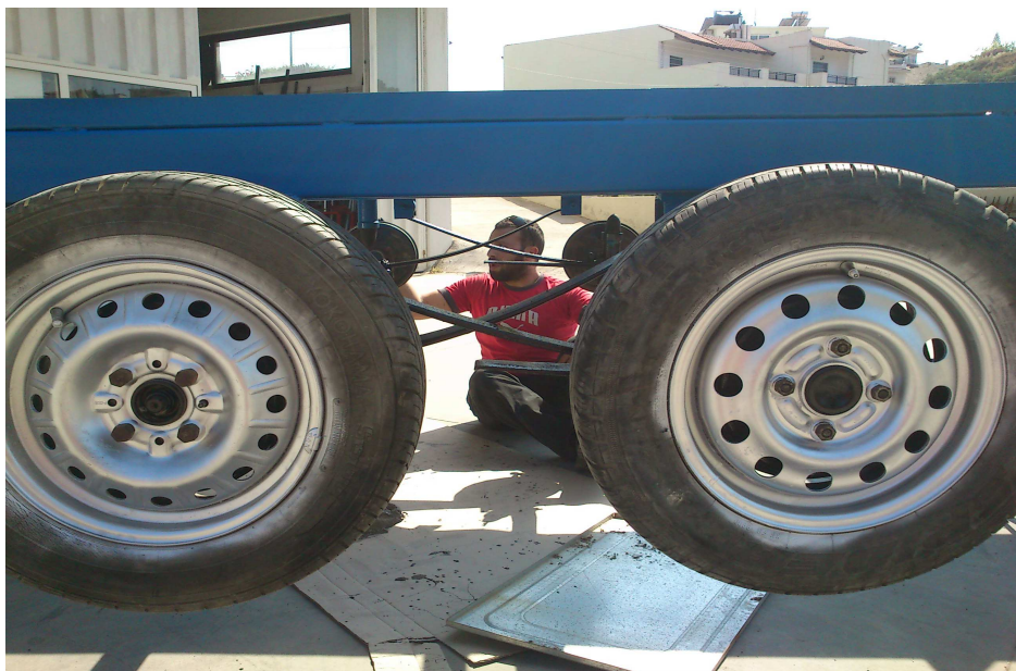
Εικόνα 96:ΒΑΦΗ ΖΑΝΤΩΝ ΜΕ ΣΠΡΕΙ ΑΣΗΜΙ ΥΨΗΛΩΝ ΘΕΡΜΟΚΡΑΣΙΩΝ.
