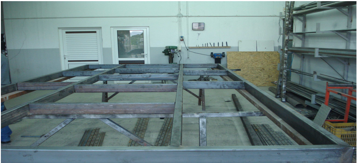
Εικόνα 33: :ΣΥΝΑΡΜΟΛΟΓΗΣΗ ΚΑΙ ΠΟΝΤΑΡΙΣΜΑ ΠΛΑΙΣΙΟΥ
