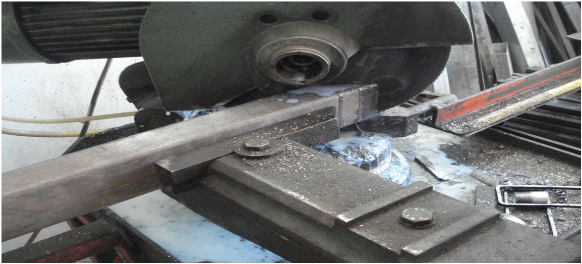
Εικόνα 75:ΦΑΛΤΣΟ ΚΟΨΙΜΟ ΚΟΙΛΟΔΟΚΩΝ ΓΙΑ ΔΗΜΙΟΥΡΓΙΑ ΜΠΑΡΩΝ ΚΑΙ ΚΑΓΚΕΛΟΥ.
