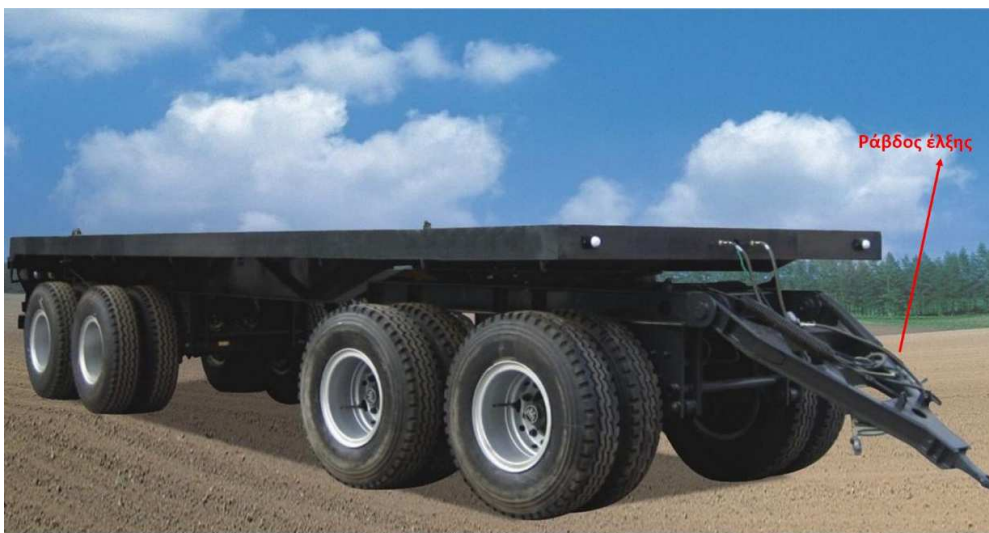
Εικόνα 3: πλήρες τρέιλερ. Στηρίζεται σε 4 άξονες, 2 εμπρόσθιους και δύο οπίσθιους. Με κόκκινο βέλος σημειώνεται η μετατοπιζόμενη ράβδος έλξης
