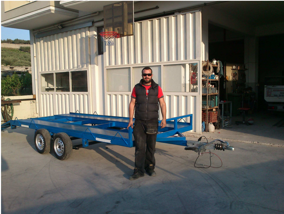
Εικόνα 98: ΠΡΟΣΑΡΜΟΓΗ ΧΟΥΦΤΑΣ ΚΑΙ ΒΙΔΩΜΑ ΠΑΝΩ ΣΤΟ ΚΟΙΛΟΔΟΚΟ.
