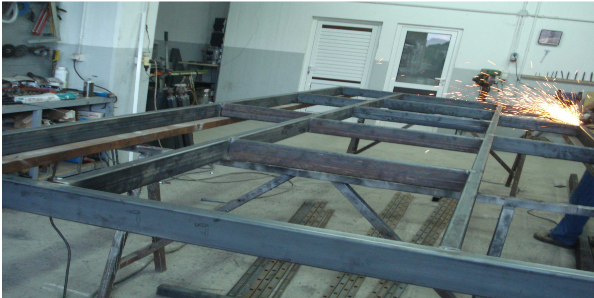
Εικόνα 45:ΣΥΓΚΟΛΛΗΣΗ ΠΛΑΙΣΙΟΥ ΚΑΙ ΤΡΟΧΙΣΜΑ ΚΟΛΛΗΣΕΩΝ
