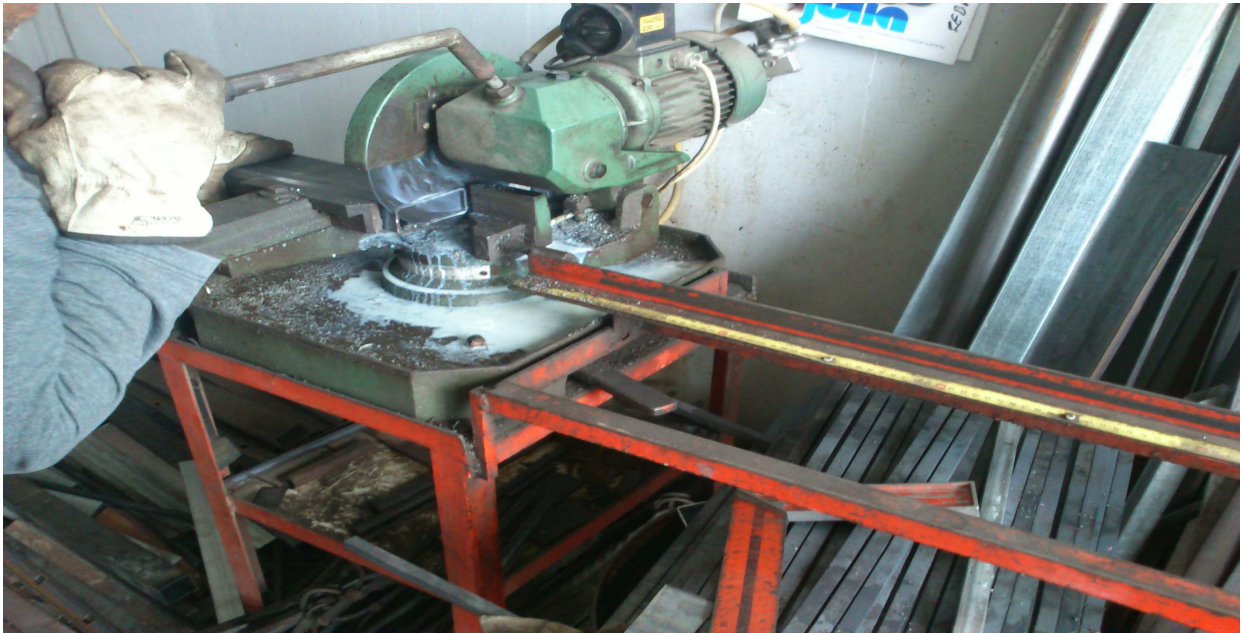
Εικόνα 28:ΚΟΠΗ ΚΟΙΛΟΔΟΚΩΝ ΜΕ ΣΙΔΕΡΟΠΡΙΟΝΟ
