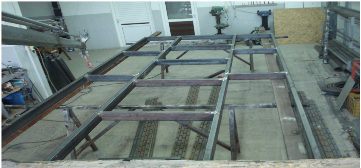
Εικόνα 36:ΣΥΓΚΟΛΛΗΣΗ ΠΛΑΙΣΙΟΥ ΚΑΙ ΤΡΟΧΙΣΜΑ ΚΟΛΛΗΣΕΩΝ
