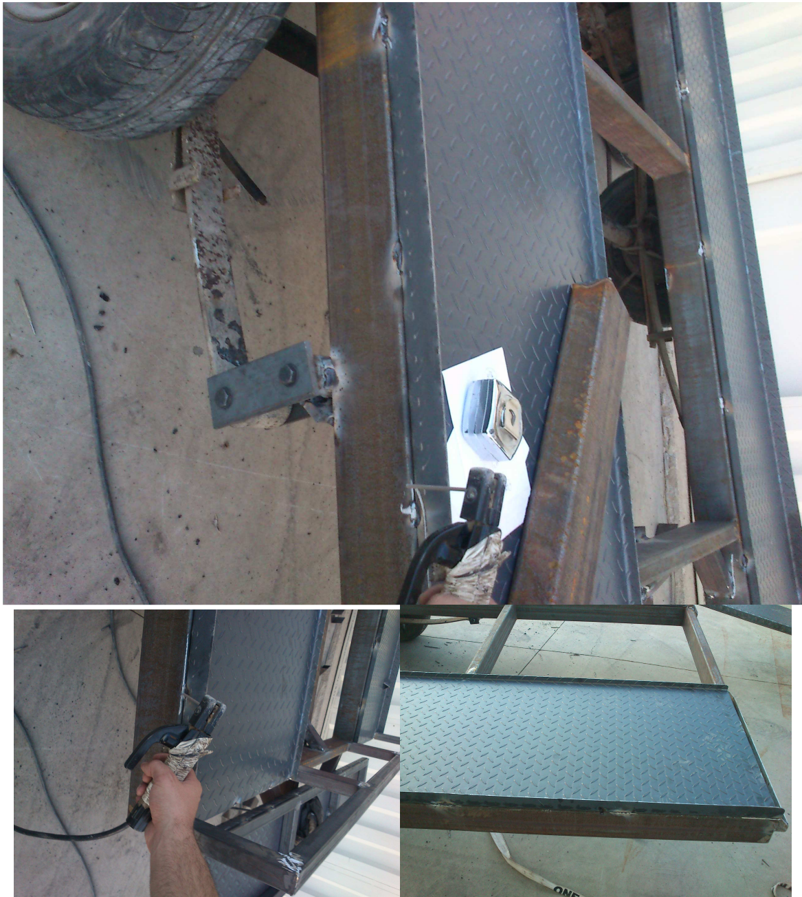
Εικόνα 80: ΕΠΙΣΤΡΩΣΗ ΤΟΥ ΠΛΑΙΣΙΟΥ ΜΑΣ ΜΕ ΛΑΜΑΡΙΝΑ ΚΑΙ ΣΥΓΚΟΛΛΗΣΗ ΑΥΤΗΣ.
