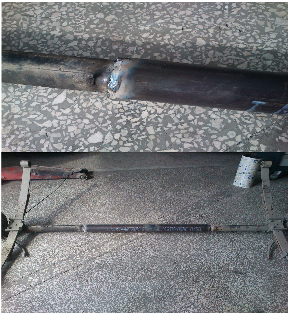
Εικόνα 54: ΣΥΓΚΟΛΛΗΣΗ ΚΑΙ ΤΕΛΕΙΟΠΟΙΗΣΗ ΑΞΟΝΩΝ
