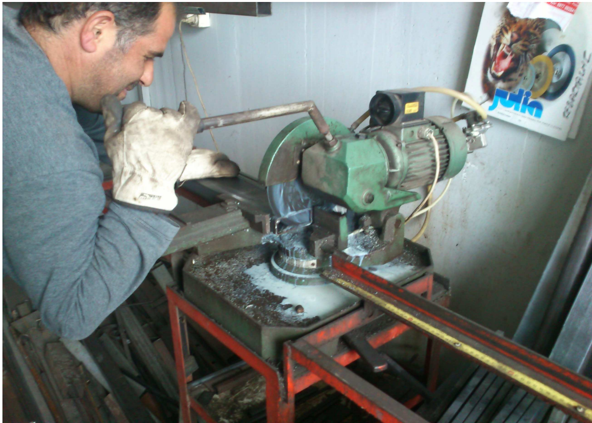
Εικόνα 27:ΚΟΠΗ ΚΟΙΛΟΔΟΚΩΝ ΜΕ ΣΙΔΕΡΟΠΡΙΟΝΟ
