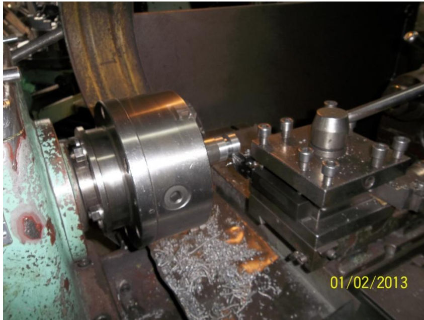
Διαμόρφωση εσοχής με κοπτικό σκισίματος.
