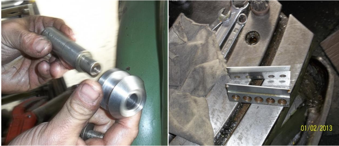
Στερέωση του κομματιού στον άξονα έτοιμο προς κατεργασία. Και ζεύγος κοπτικών.
