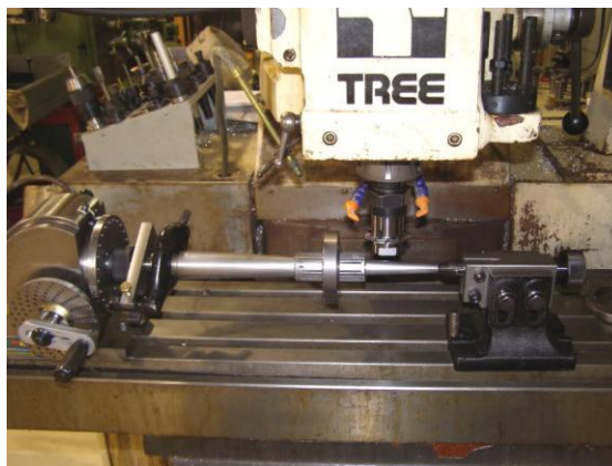
Κοπή κωνικού οδοντωτού τροχού σε κάθετη φρεζομηχανή με την χρήση διαιρέτη.
