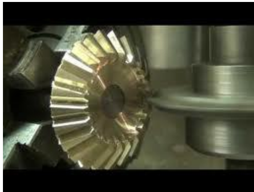
Κοπή κωνικού οδοντωτού τροχού σε κάθετη φρεζομηχανή με την χρήση διαιρέτη.
