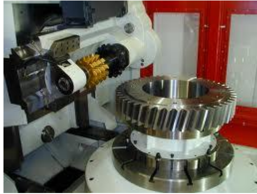
Κοπή οδόντωσης με φρέζα χόμπ.
