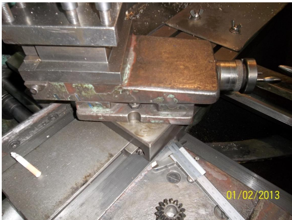
Στροφή του εργαλείοφορείου στις 36^\circ
