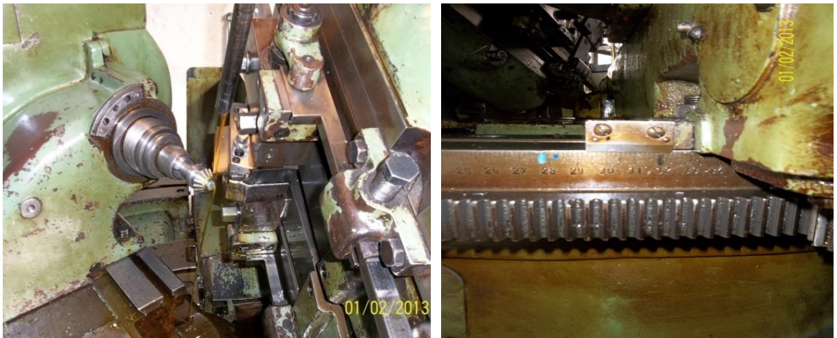
Φάση 3 η της κοπής του εξαρτήματος. Μεταβολή της γωνίας.
