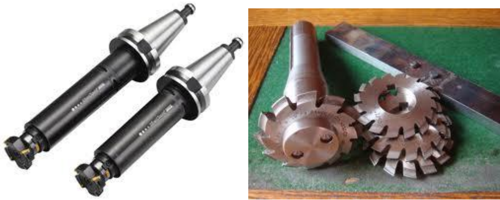
Εργαλειοφόροι άξονες κοπής. Στέλεχος με τοποθετημένη δισκοειδή φρέζα μορφής.
