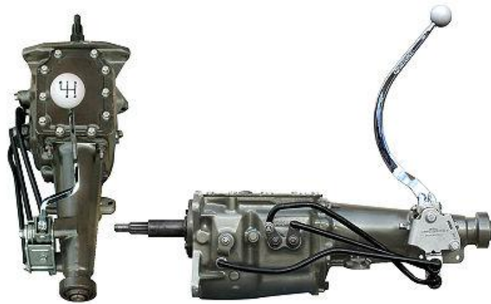
Σχήμα 11: Πάνω και πλάγια όψη ενός τυπικού μηχανικό κιβώτιο, σε αυτή την περίπτωση ένα Ford Toploader, που χρησιμοποιείται σε αυτοκίνητα με εξωτερικούς shifters.
