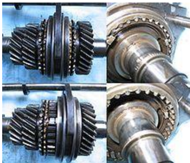
Σχήμα 13: Dog clutch. Με δόντια που μοιάζουν με γρανάζια ("Dogs", δεξιά πλευρά εικόνας), εμπλοκή και απεμπλοκή μεταξύ τους (αριστερή πλευρά εικόνας).
