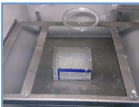
Εικόνα 3.3.2.6: Το πλαίσιο με τη σιλικόνη να «βράζει»
