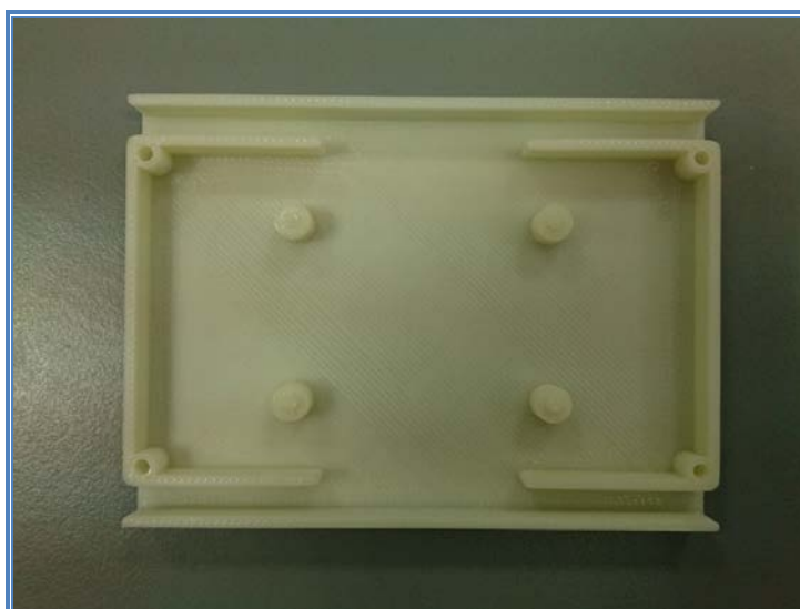
Εικόνα 3.3.2.3: Το πρωτότυπο περασμένο με ψιλό υαλόχαρτο
