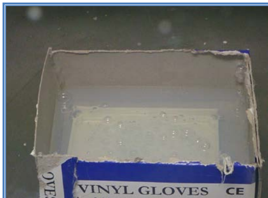
Εικόνα 3.3.2.5: Το πλαίσιο με τη σιλικόνη σε πρώτη φάση
