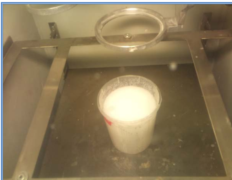
Εικόνα 3.3.1.3: Το δοχείο του μείγματος στην αντλία κενού
