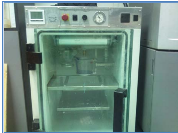
Εικόνα 3.4.2.1: Το πλαστικό στο δοχείο μίξης μέσα στην αντλία κενού
