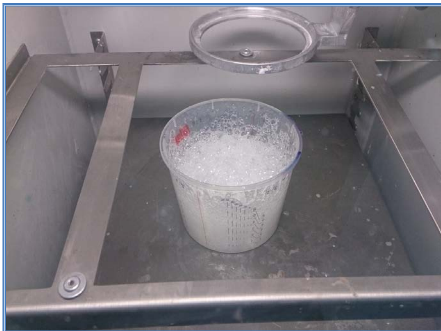
Εικόνα 3.3.2.4: Το μεγαλύτερο δοχείο μίξης με τη σιλικόνη να «βράζει» στην αντλία κενού.
