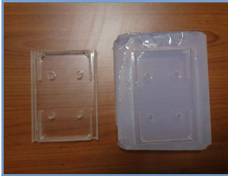
Εικόνα 3.4.4.2: Παραθέν πλαστικό κομμάτι δίπλα στο καλούπι
