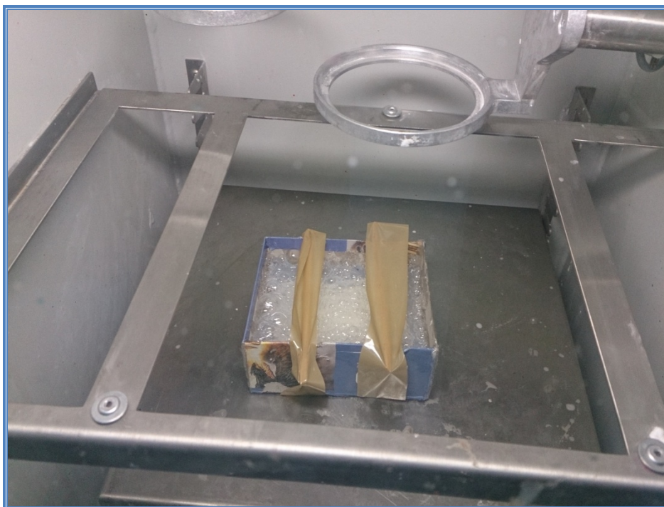
Εικόνα 3.3.1.5: Το πλαίσιο με τη σιλικόνη στην αντλία κενού
