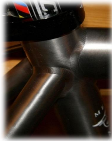
Εικόνα 2.7 : Χαρακτηριστικές συγκολλήσεις σε ένα σκελετό από τιτάνιο.
