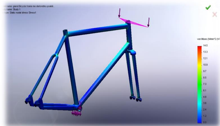
Σχήμα 5.20 : Γραφική απεικόνιση μέγιστης τάσης (Von Mises)
