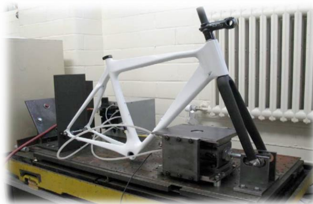
Εικόνα 5.7: Τεστ κοπώσεως με οριζόντιες δυνάμεις Horizontal impact
