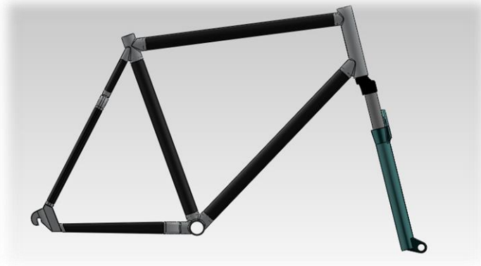
Σχήμα 6.22 : Συνδυασμός δύο μετάλλων ,αλουμινίου με ανθρακόνημα.
