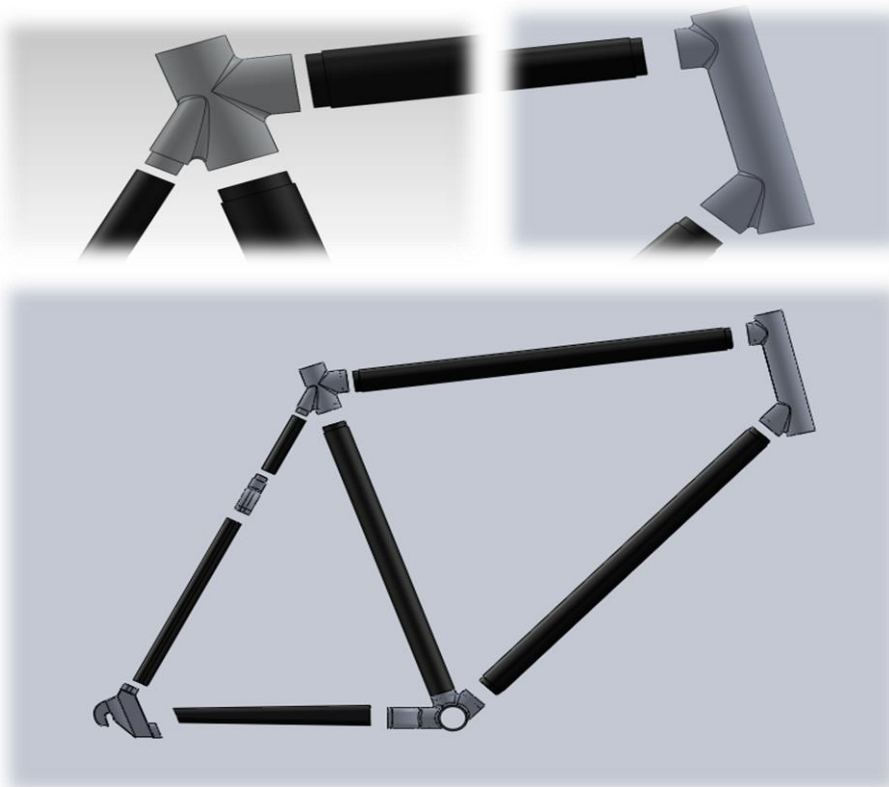
Σχήμα 6.23: Ένωση διαφορετικών τμημάτων από αλουμινίο και ανθρακόνημα.
