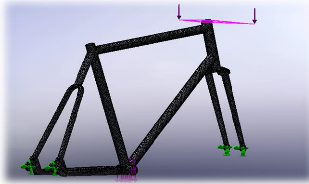
Σχήμα 5.22: πλέγμα πεπερασμένων στοιχείων του πλαισίου
