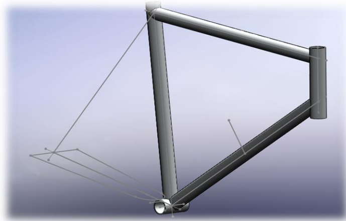
Εικόνα 5.1 : Τριμετρική απεικόνιση κυρίως τριγώνου ποδηλάτου στο Solidworks
