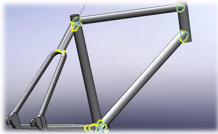
Εικόνα 5.3 : Τριμετρική απεικόνιση στο Solidworks (μαζί με Fillet)
