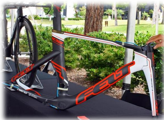
Εικόνα 2.8 : Σκελετός Felt από ανθρακόνιμα, κατασκευή monocoque.
