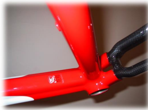
Εικόνα 2.5 : Downtube αλουμίνιο και αθρακόνημα
