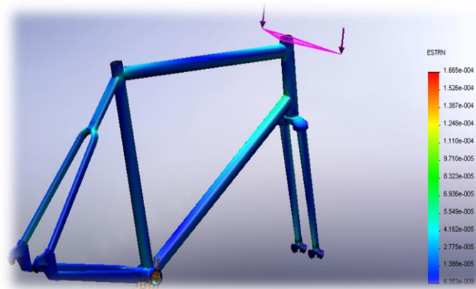
Σχήμα 5.18 : Γραφική απεικόνιση ισοδύναμης τάσης (Equivalent)
