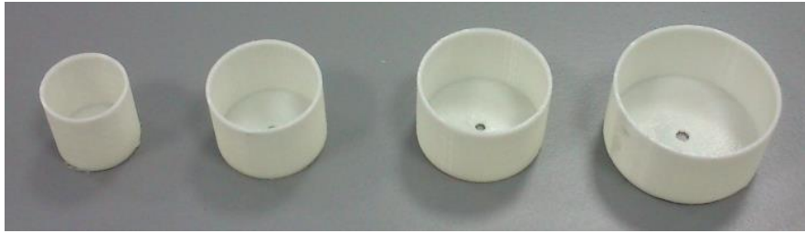
Εικόνα 2.9: Καλούπια κυλινδρικών ακροδαχτύλων εσωτερικής ακτίνας 10, 14, 16 και 20 χιλιοστων αντίστοιχα (απο αριστερα προς τα δεξιά)
