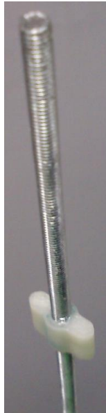
Εικόνα 3.6: Άξονας με προσαρμοσμένο το εκτυπωμένο εξάρτημα συγκράτησης του ακροδαχτύλου
