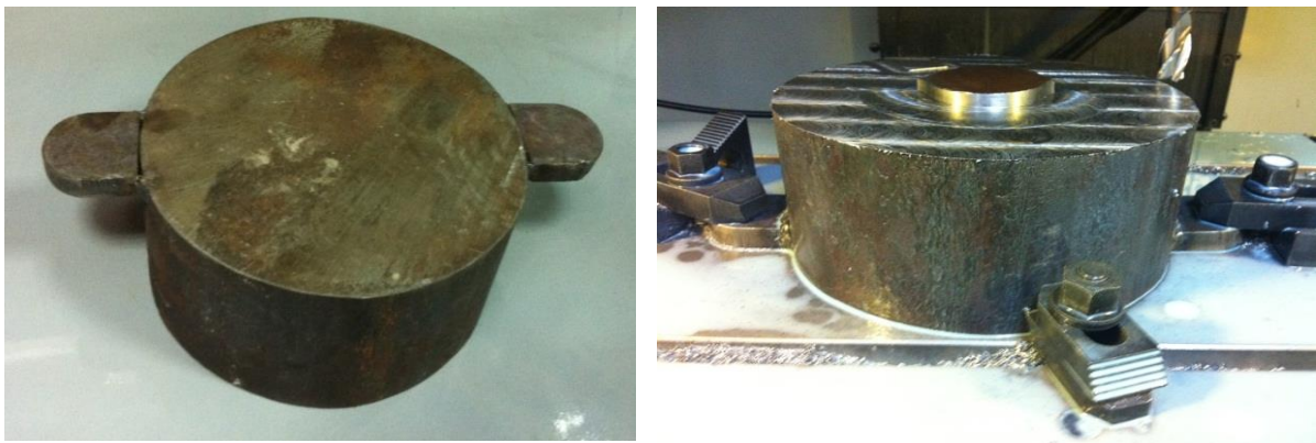
Εικόνα 54: Ακατέργαστο πριν την στερέωση του και ακατέργαστο στερεωμένο με μια κατεργασία εκτελεσμένη
