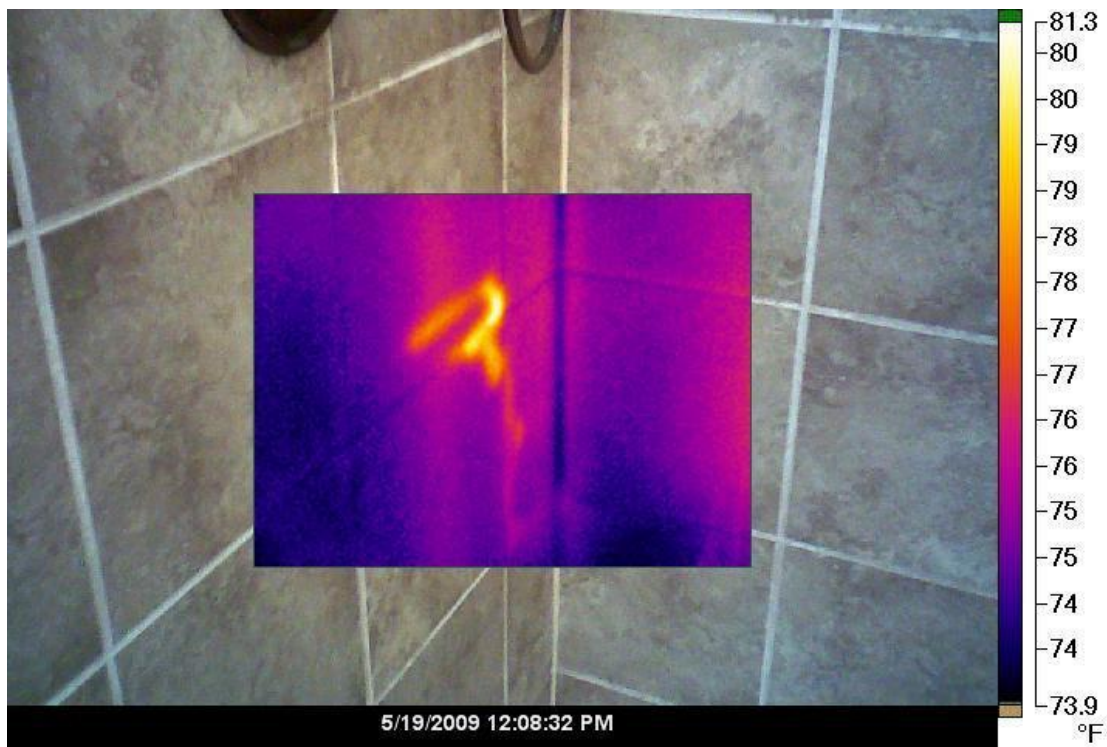
Εικόνα 22: Διαρροή σε σωλήνα πίσω από πλακάκι μπάνιου
