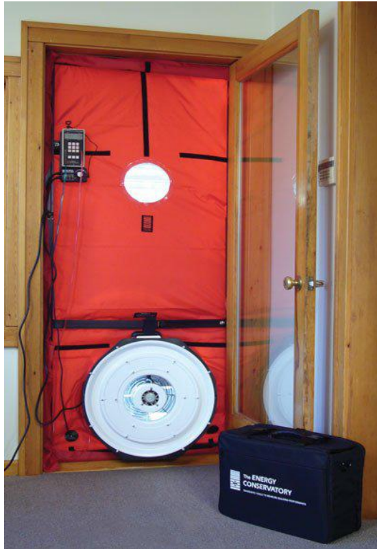
Εικόνα 9: Εγκατάσταση ‘blower door’
