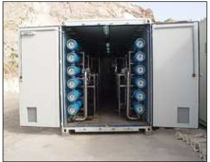
Εικόνα 46 : Δυο όμοιες συστοιχίες 560 m 3 /ημέρα η καθεμία
