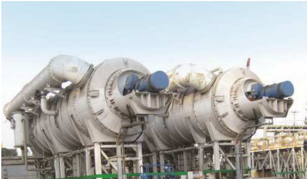
Εικόνα 11: Εγκατάσταση εξάτμισης με συμπίεση ατμών
