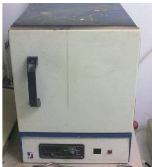
Εικόνα 4.9: Τοποθέτηση δειγμάτων στους 550°C για 2h.
