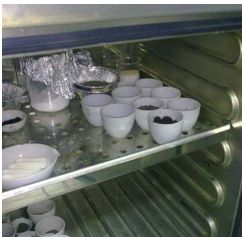
Εικόνα 4.8: Τοποθέτηση δειγμάτων στους 105°C για 24h.
