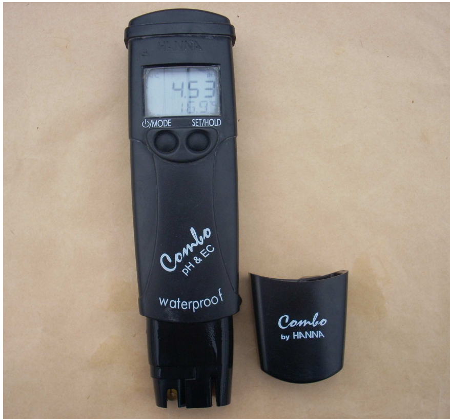
Εικόνα 4.11. Φορητό πεχάμετρο και αγωγιμόμετρο (Hanna HI 98130).
