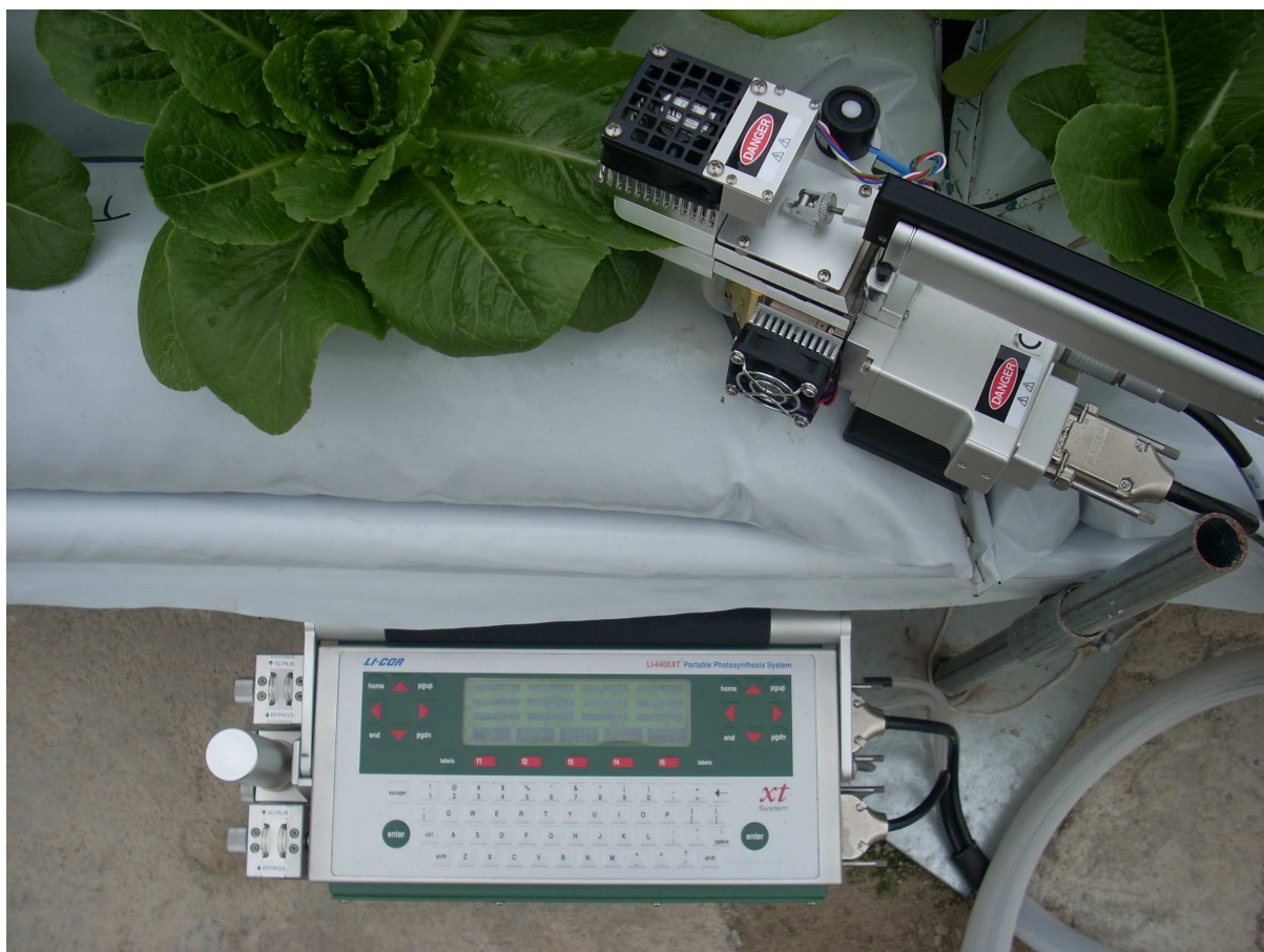
Εικόνα 4.10. Φορητή συσκευή υπέρυθρης ανάλυσης αερίων (model LI-6200, Li-Cor, Inc., Lincoln, NE)
