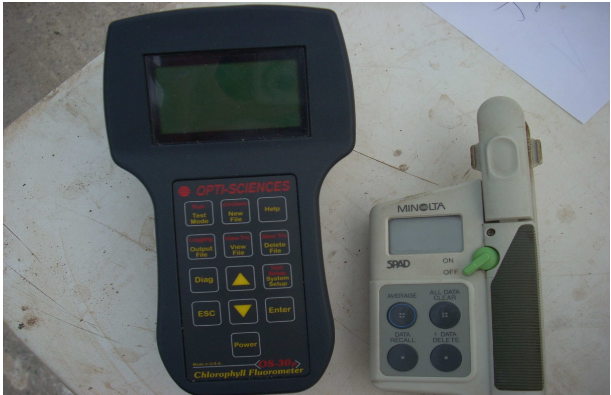
Εικόνα 4.9. Αριστερά φθορίμετρο, opti-sciences OS-30p, UK και δεξιά όργανο για τη μέτρηση της χλωροφύλλης με το εξειδικευμένο όργανο Minolta SPAD.
