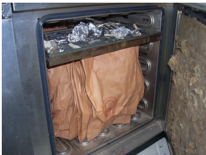
Εικόνα 4.8. Ειδικό πυραντήριο για την απομάκρυνση της υγρασίας.
