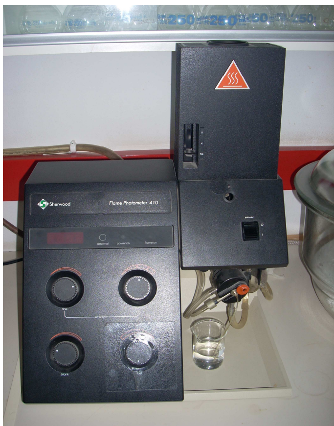
Εικόνα 4.12. Φλογοφωτόμετρο για την στοιχειομετρική ανάλυση Κ.
