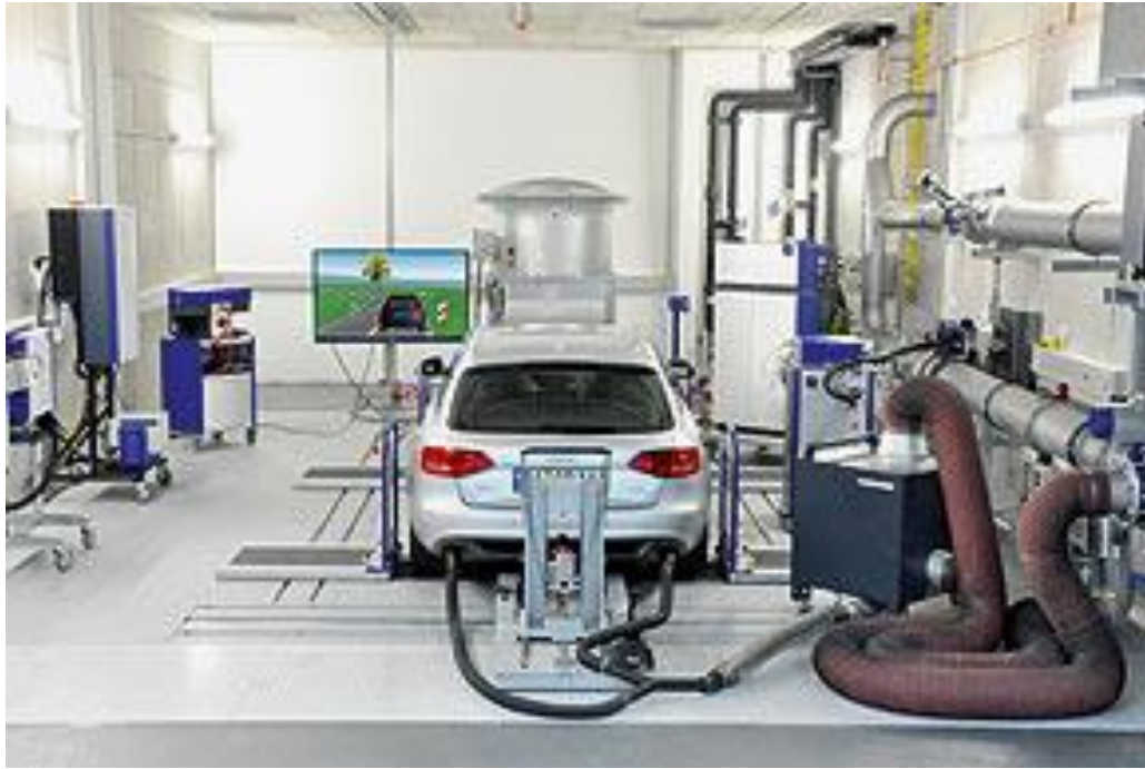
Εικόνα 2.2 Όχημα πάνω σε δυναμομετρική εξέδρα με σύστημα συλλογής ,και ανάλυσης εκπομπών καυσαερίων 81
