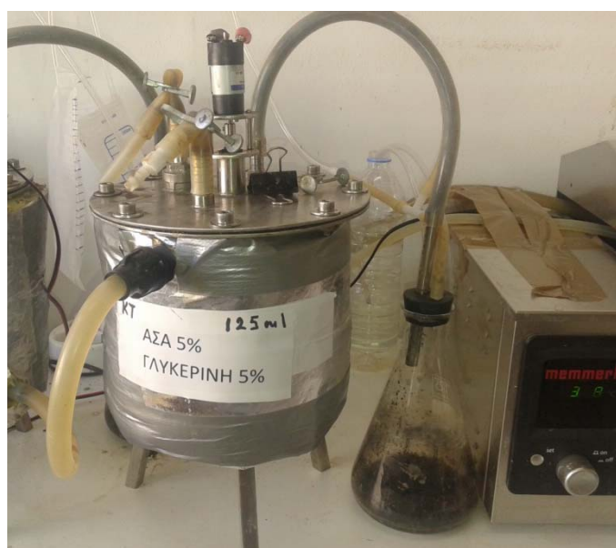
Σχήμα 5.2: Πειραματική διάταξη αναερόβιας επεξεργασίας αστικών στερεών αποβλήτων σε αντιδραστήρα συνεχούς λειτουργίας (CSTR).
