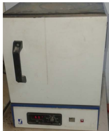
Εικόνα 4.4: Τοποθέτηση δειγμάτων στους 550°C για 2h.
