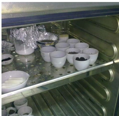
Εικόνα 4.3: Τοποθέτηση δειγμάτων στους 105°C για 24h.
