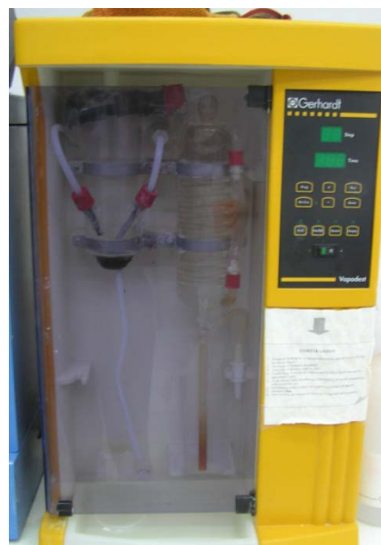
Εικόνα 4.6: Σύστημα απόσταξης Varopdest.
