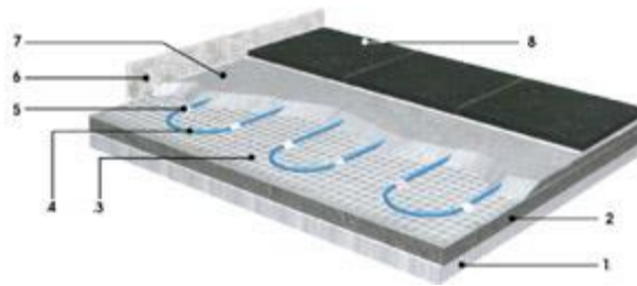
Εικ. 7:18: Τομή ενδοδαπέδιας θέρμανσης σε δάπεδο τσιμεντοκονίας.
