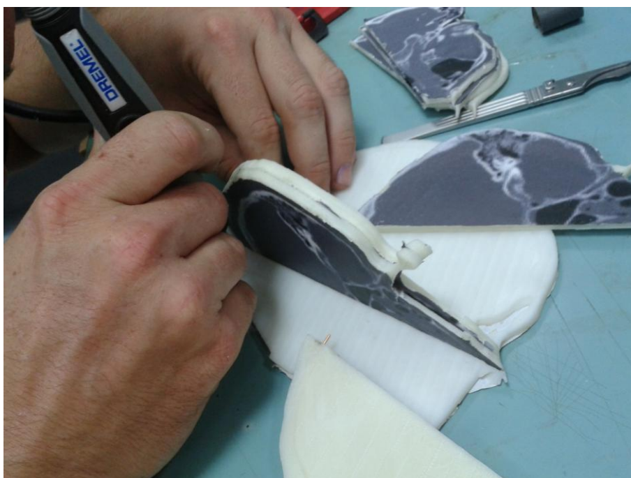
Εικόνα 5 31 Δημιουργία οπών με τρυπάνι πάχους 1[mm]
