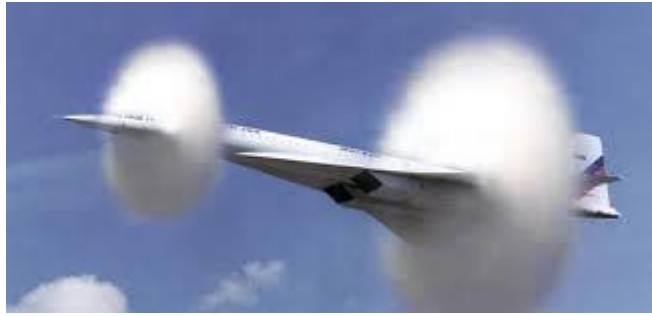
Εικόνα 2-2 Αεροσκάφος την ώρα που σπάει το φραγμα του ήχου ( Ma=1 ) .
