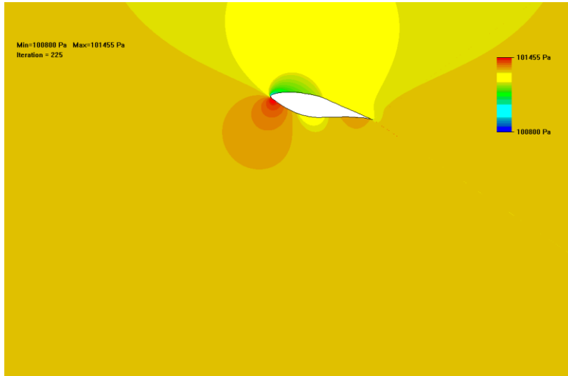
Διάγραμμα 4 Κατανομή πιέσεων πάνω στην αεροτομή S809 κοντά στη κρίσιμη γωνία προσβολής για Re=1 \times 10^6
