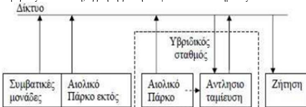
Εικόνα 16 : Σύνδεση Αιολικού πάρκου άμεσα με μονάδα αντλησιοταμίευσης
