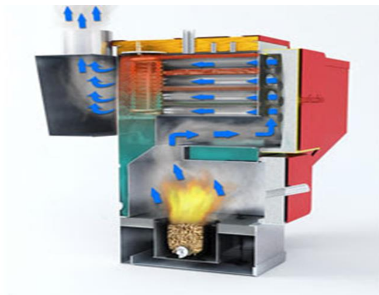
Εικόνα 24 : Τρόπος λειτουργίας λέβητα βιομάζας
