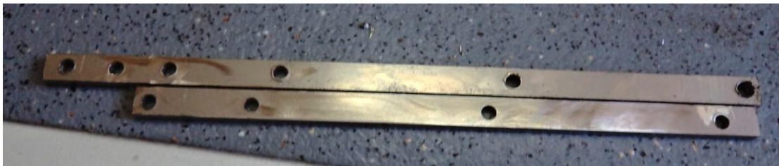
Εικόνα 64. Τελικό αποτέλεσμα των ράβδων μετάλλου έπειτα απο κατεργασία στο χέρι με το τρυπάνι Dremel.
