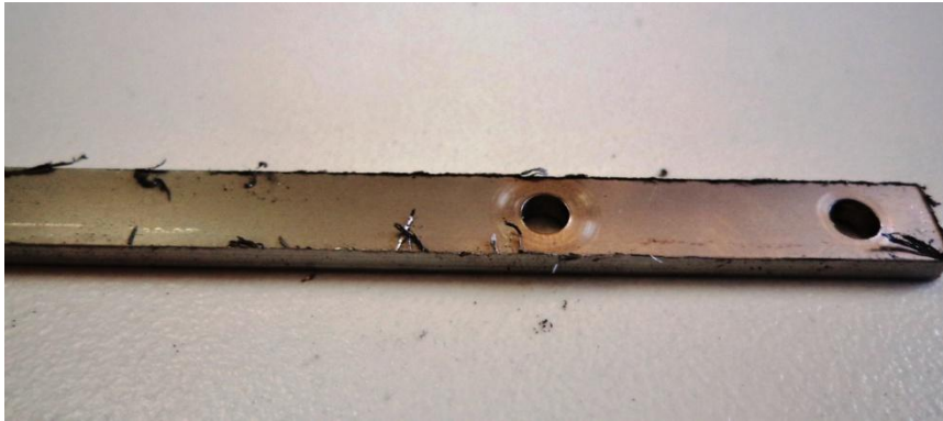
Εικόνα 63. Ράβδος μετάλλου αμέσως μετά την κατεργασία του στην CNC φρέζα. Παρατηρούνται οι ατέλειες στα σημεία όπου πέρασε το κοπτικό.
