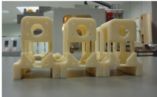
Εικόνα 44. Τελική κατασκευή βάσεων στήριξης των κινητήρων, με 3D printer
