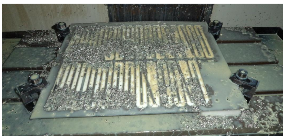
Εικόνα 62. Αποτέλεσμα έπειτα την κατεργασία. Παρατηρούνται οι ράβδοι μετάλλου οι οποίοι είναι βιδωμένοι με το εργαλόν και έτσι παραμένουν στις θέσεις του, εκτός από 2 ράβδους που δεν συγκροτήθηκαν πλήρως .
