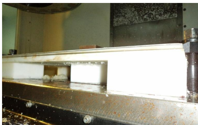
Εικόνα 61. Συγκράτηση στην CNC. Το εργαλόν βρίσκεται κάτω από το φύλλο μετάλλου και κάτω από αυτό υπάρχει άλλο ένα ορθογώνιο κομμάτι στην μέση για την αποφυγή των έντονων ταλαντώσεων στο μέσο του κατεργαζόμενου κομματιού.
