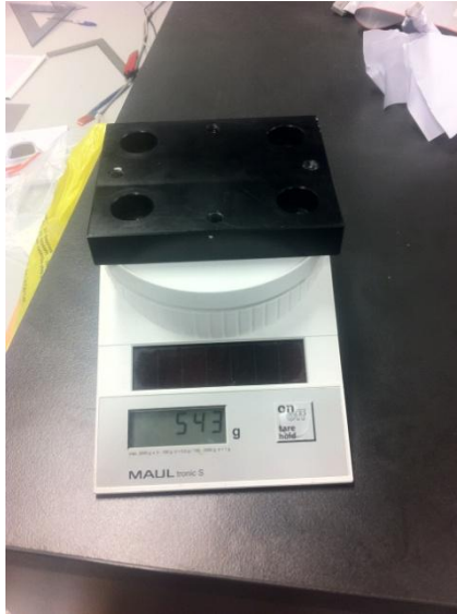
Εικόνα 30. Έλεγχος τελικού βάρους φορείου (543g)
