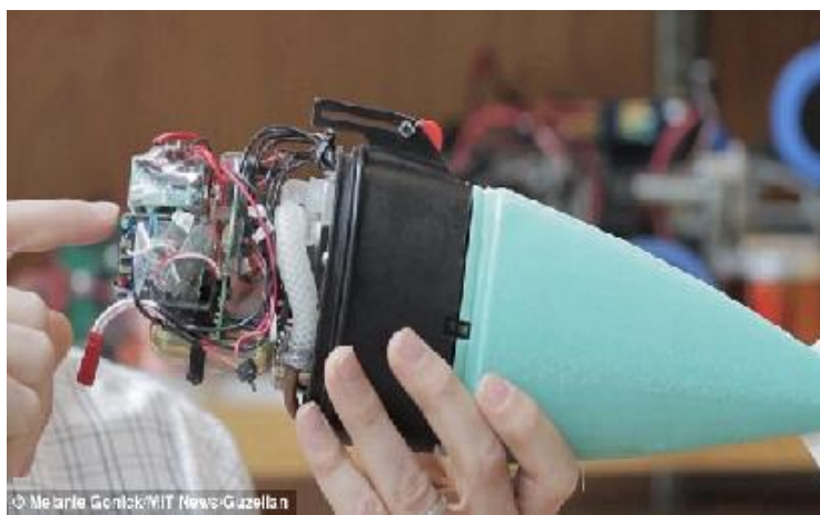
Εικόνα 2. Κανάλι διοχέτευσης διοξειδίου του άνθρακα στο εσωτερικό του ρομπότ
