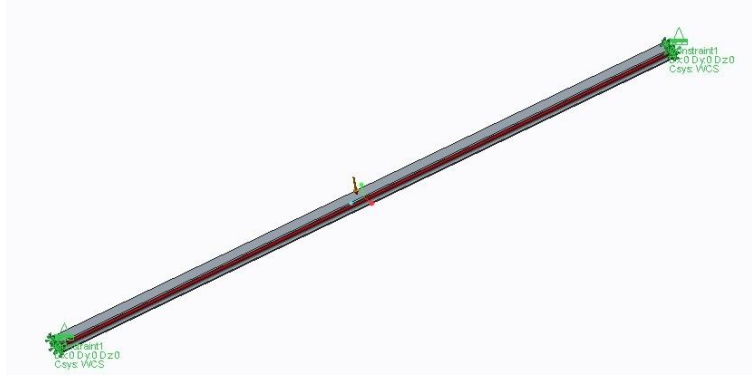
Εικόνα 24. Άσκηση κάθετης δύναμης 10kg στο μέσο του οδηγού κύλισης.
