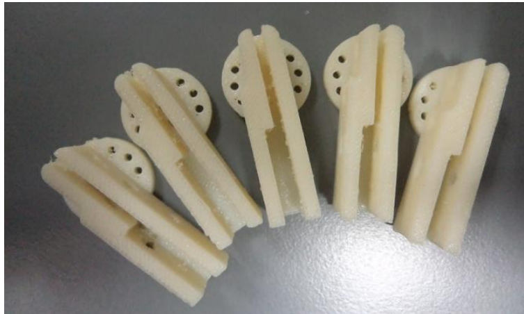
Εικόνα 50. Τελικό servocar κατασκευασμένο σε 3D printer
