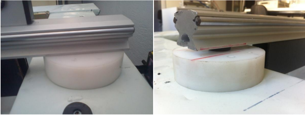
Εικόνα 65. Προσαρμογή του οδηγού κύλισης με το ερτασετάλ, επάνω στη δεξαμενή.
