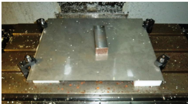
Εικόνα 60. Τοποθέτηση και συγκράτηση φύλλου μετάλλου στην CNC φρέζα, υπάρχουν 4 σφικτήρες στις άκρες του κομματιού και ένα κομμάτι μετάλλου στο κέντρο για την αποφυγή ταλαντώσεων.
