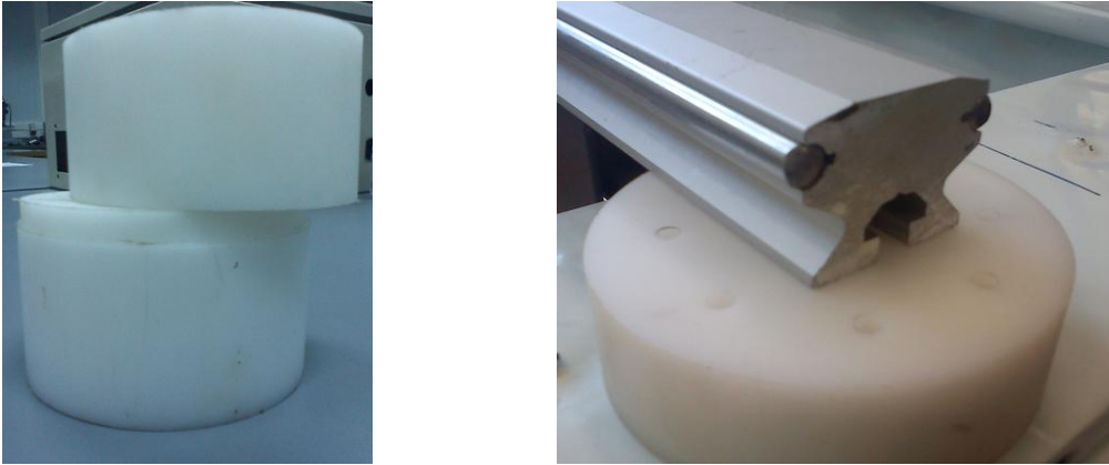
Εικόνα 52. Αρχική μορφή ερτασετάλ (αριστερά), κατεργασμένο ερτασετάλ (δεξιά)
