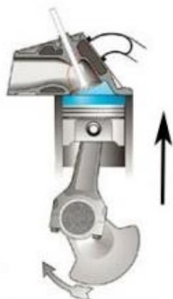
Εικόνα 20 Συμπίεση μίγματος κατά τον δεύτερο χρόνο.
