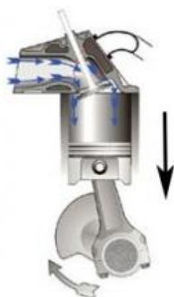
Εικόνα 19 Πρώτος χρόνος λειτουργίας εισαγωγή μίγματος στο κύλινδρο.
