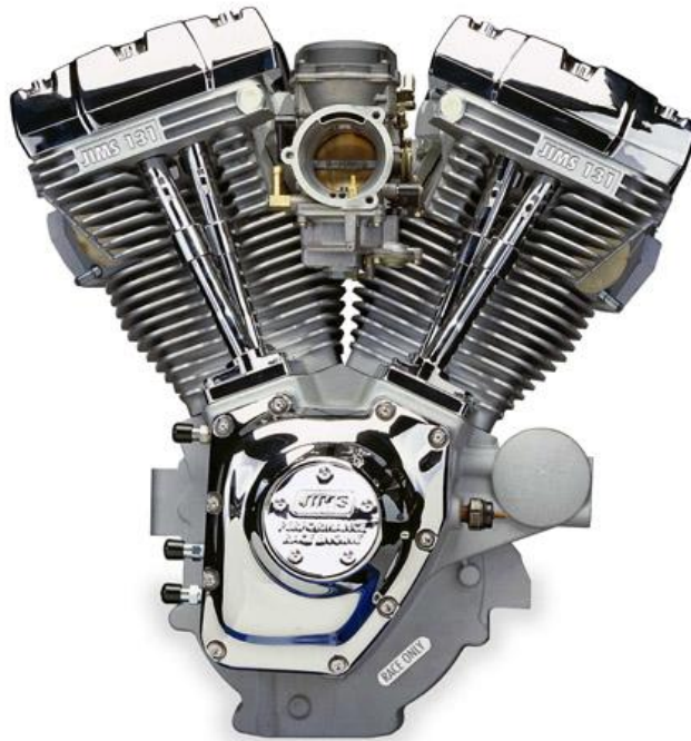
Εικόνα 28 Αερόψυκτος κινητήρας σε διάταξη V.
