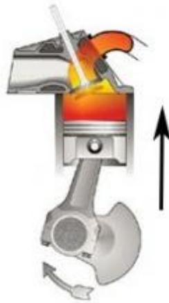
Εικόνα 22 Εξαγωγή παραγώγων καύσης εκτός θαλάμου καύσης κατά τη διάρκεια του τέταρτου χρόνου.
