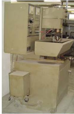
Εικόνα 3.273: Μηχανολογικός τóρνος υδραυλικής αντιγραφής
