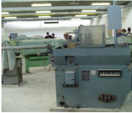
Εικόνα 3.298: Ειδικός μηχανολογικός τόρνος κατεργασίας βεργών
