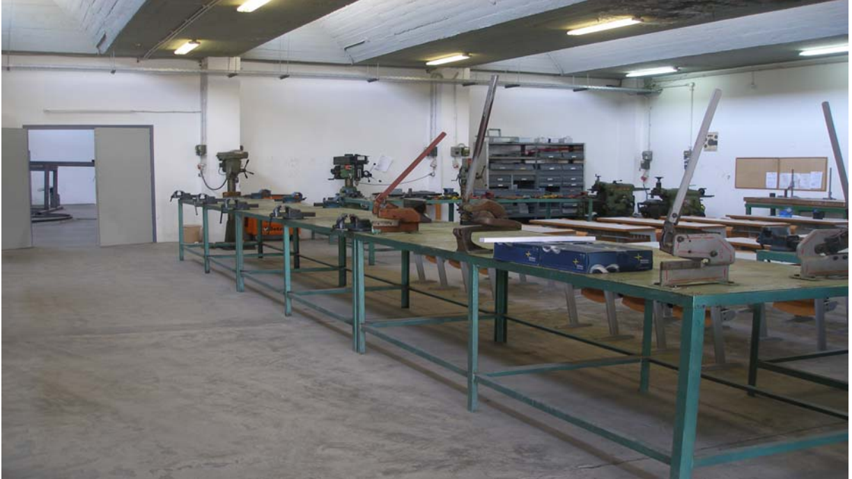
Z.2: Μηχανουργείο I (εφαρμοστήριο, πλάνες, δράπανα, ηλεκτροσυγκολήσεις)
